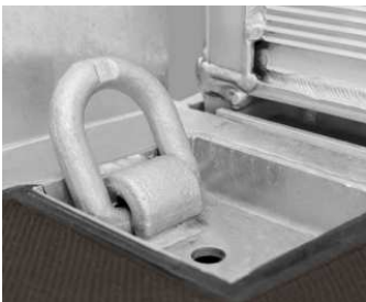
Zurrpunkte im Brückenboden versenkt
