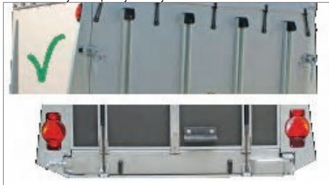
Vrata na tečajih so zaklenjena na vrhu in na dnu
