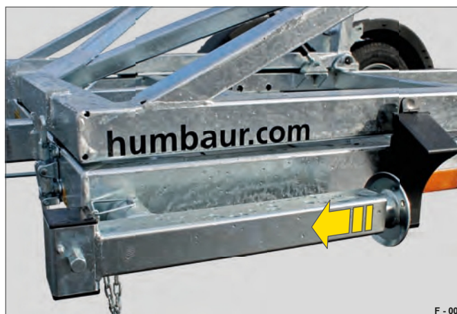
Slika 3 Teleskopska opora ročice v potujočem položaju
