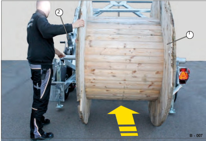
Slika 10 Vnos kabelskega bobna
