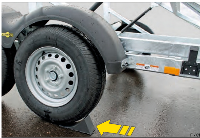
Slika 10 Podstavki za kolesa, nameščeni pod kolesi v parkirnem položaju
