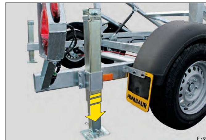
Slika 6 Teleskopska opora za ročico v podpornem položaju
