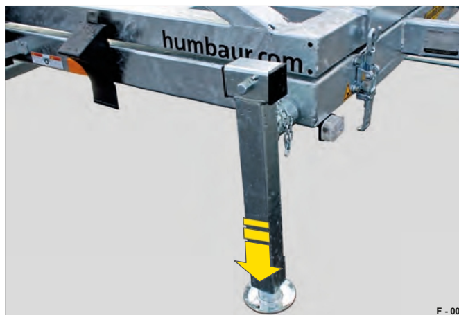
Slika 4 Teleskopska opora za ročico v podpornem položaju
