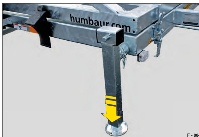
4. ábra Teleszkópos forgattyútartó támasztási helyzetben
