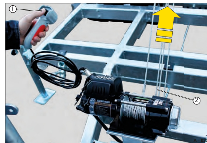
11. ábra A kábelcsőrlő aktiválása
