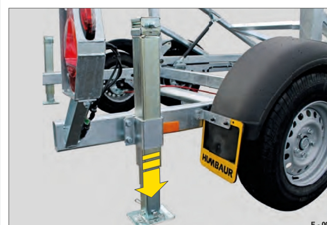
6. ábra Teleszkópos forgattyútartó támasztási helyzetben
