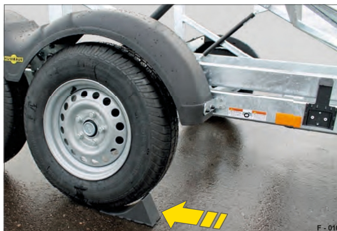
10. ábra Parkoló helyzetben alulra helyezett kerékbilincsek
