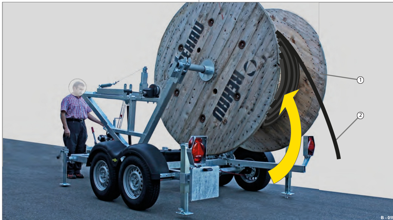
16. ábra A dobkeret felemelése / a kábel működtetése
