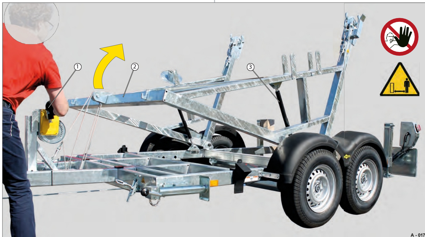
8. ábra A dobkeret hátrafelé billentése
