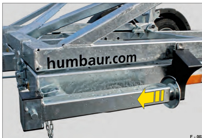
3. ábra Teleszkópos forgattyútartó mozgó helyzetben
