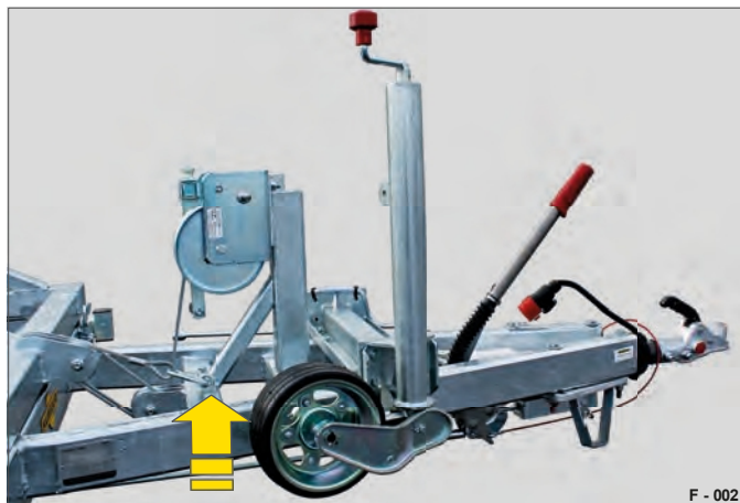
1. ábra Automatikus támasztókerék mozgó helyzetben
