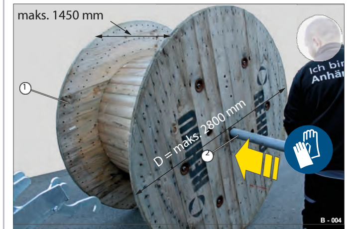
Rys. 6 Zakładanie wałka transportowego
