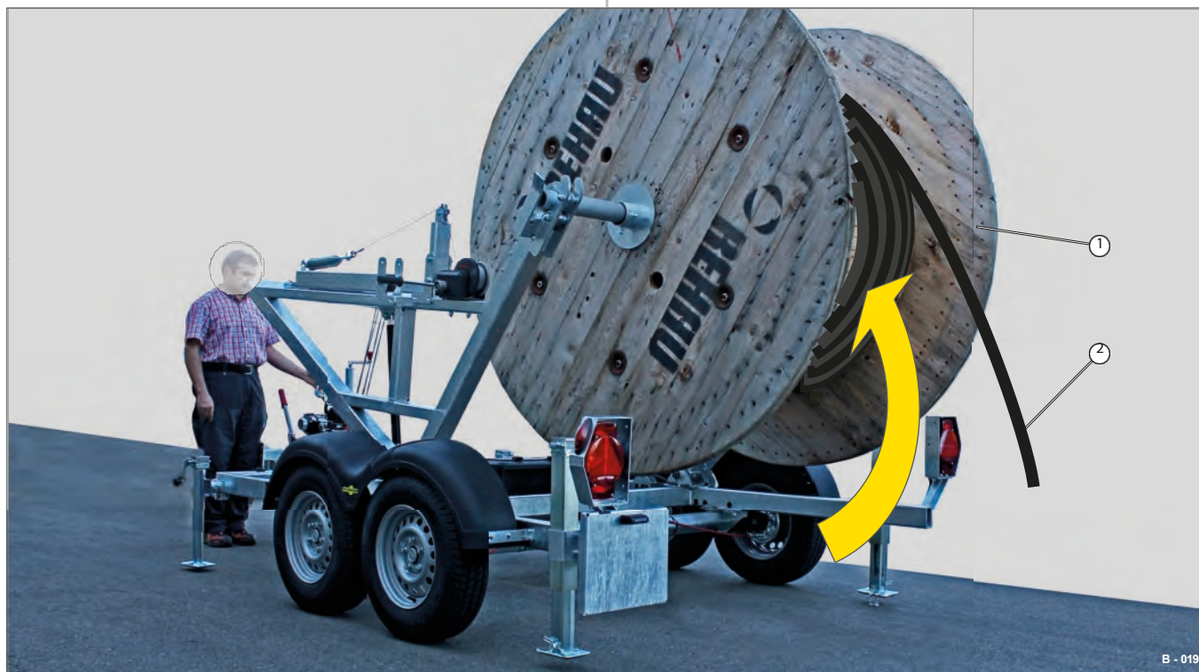
Rys. 16 Podnoszenie ramy bębna / obsługa kabla
