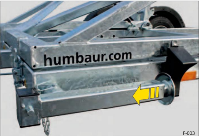
Sl. 3 Teleskopski oslonac radilice u položaju za vožnju
