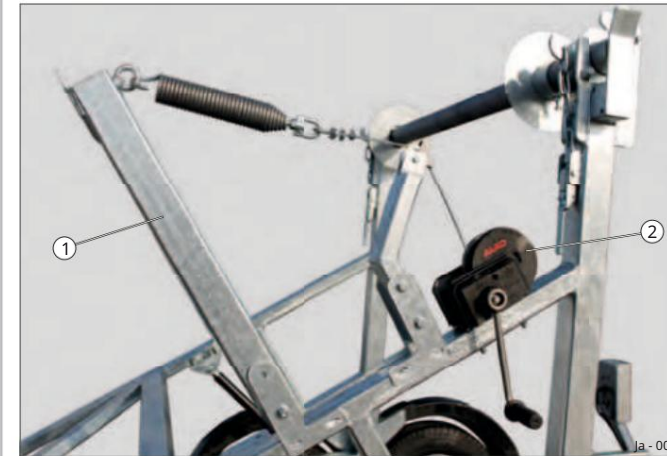
Sl. 8 Okvir kočnice (opcionalno) 1 okvir s kočnicom, podignut 2 vitlo s ručnim užetom i kočnicom, AL-KO
