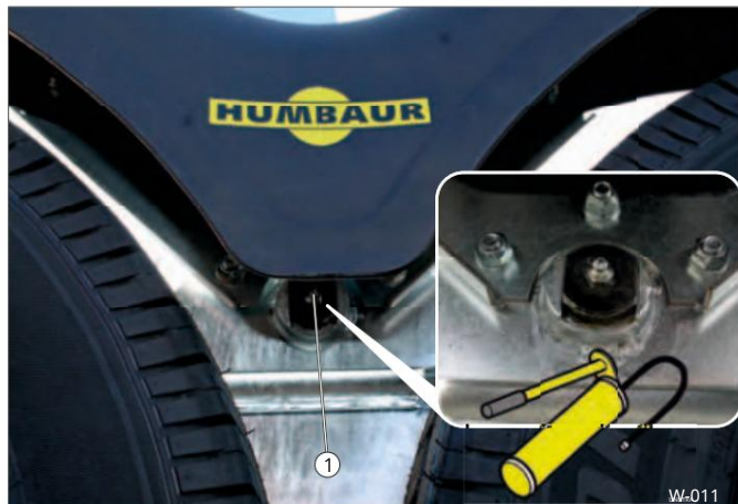
Sl. 11 Okvir bubnja s lež ajem / mjestom podmazivanja 1 mazalica
