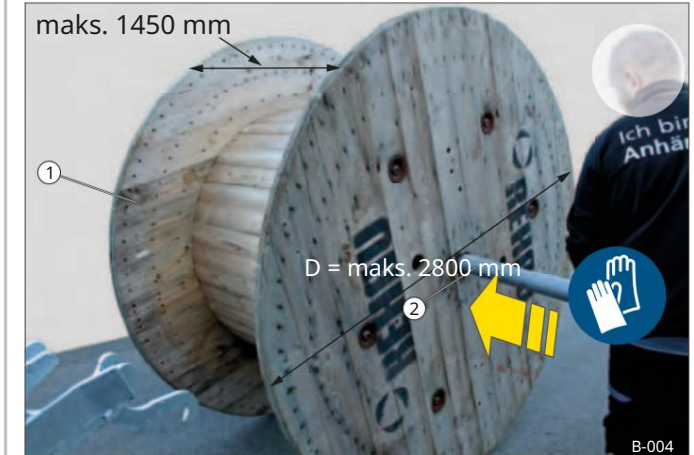
Sl. 6 Umetanje transportne osovine
