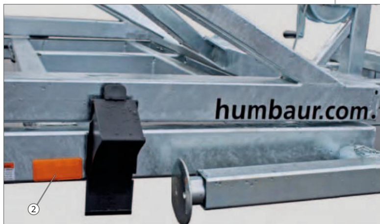
Sl. 2 Prednja rasvjeta 1 Bočno svjetlo za označavanje (prednje) 2 narančasta reflektora (sa strane šasijske)
