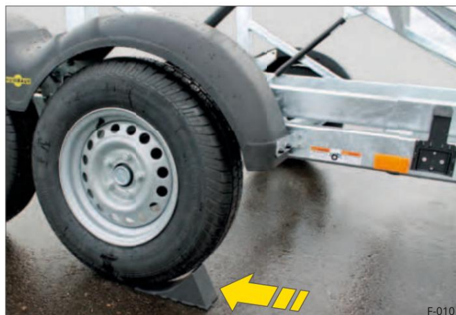
Sl. 10 Klinovi za kotače postavljeni ispod u parkirnom položaju
