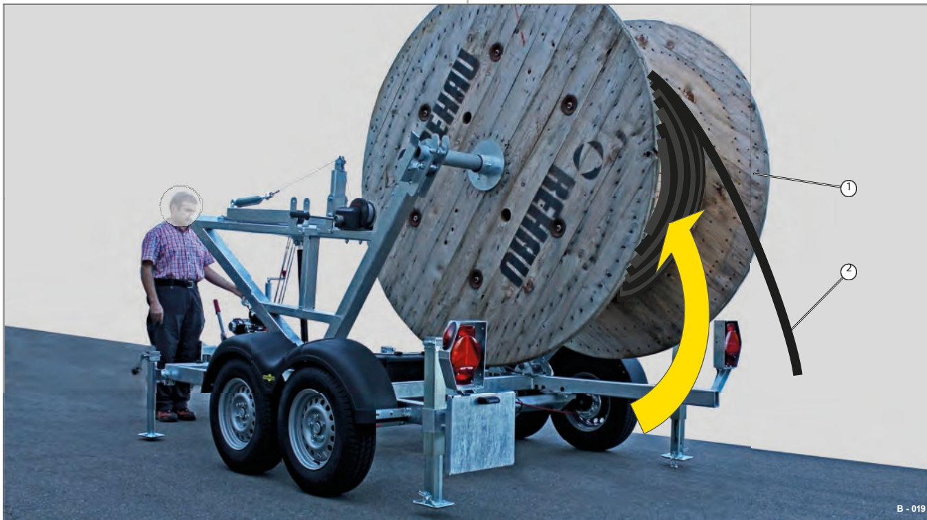
Kuva 16 Rummun rungon nostaminen / kaapelin käyttö
