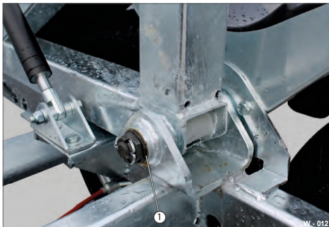
Obr. 12 Ložisko / mazací místo rámu bubnu
