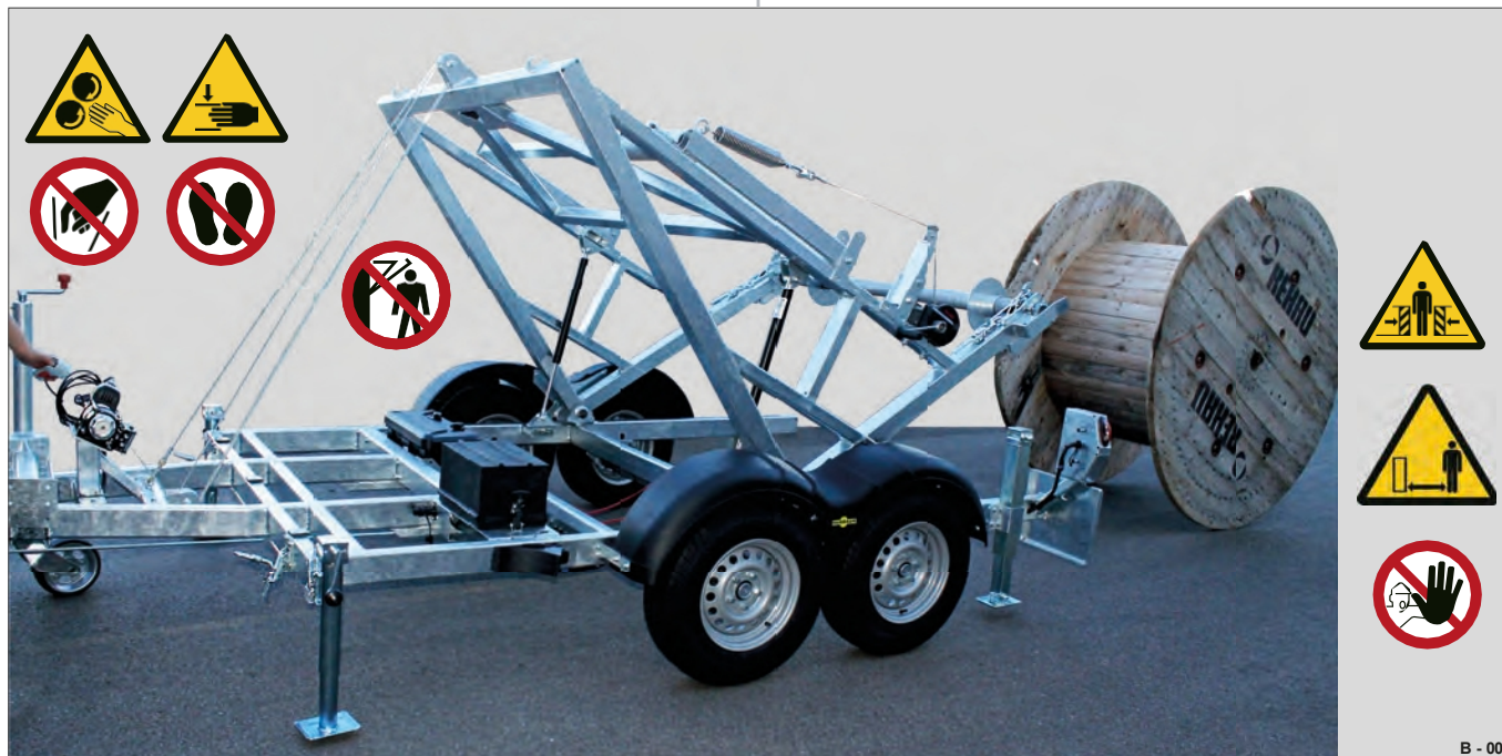
Obr. 1 Nebezpečí při nakládce/vykládce
