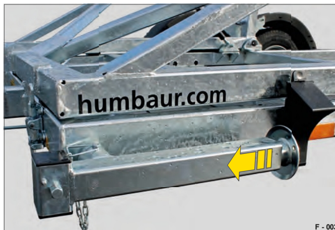
Obr. 3 Teleskopická podpěra kliky v jezdové poloze
