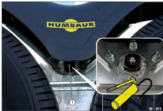
Obr. 11 Ložisko / mazací místo rámu bubnu
