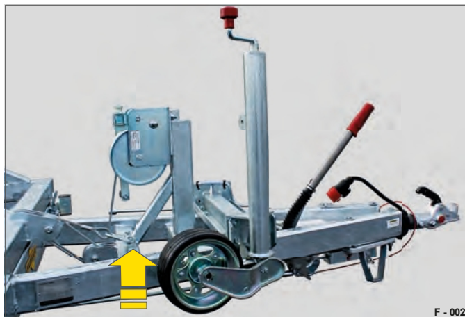
Obr. 1 Automatické opěrné kolo v jezdové poloze
