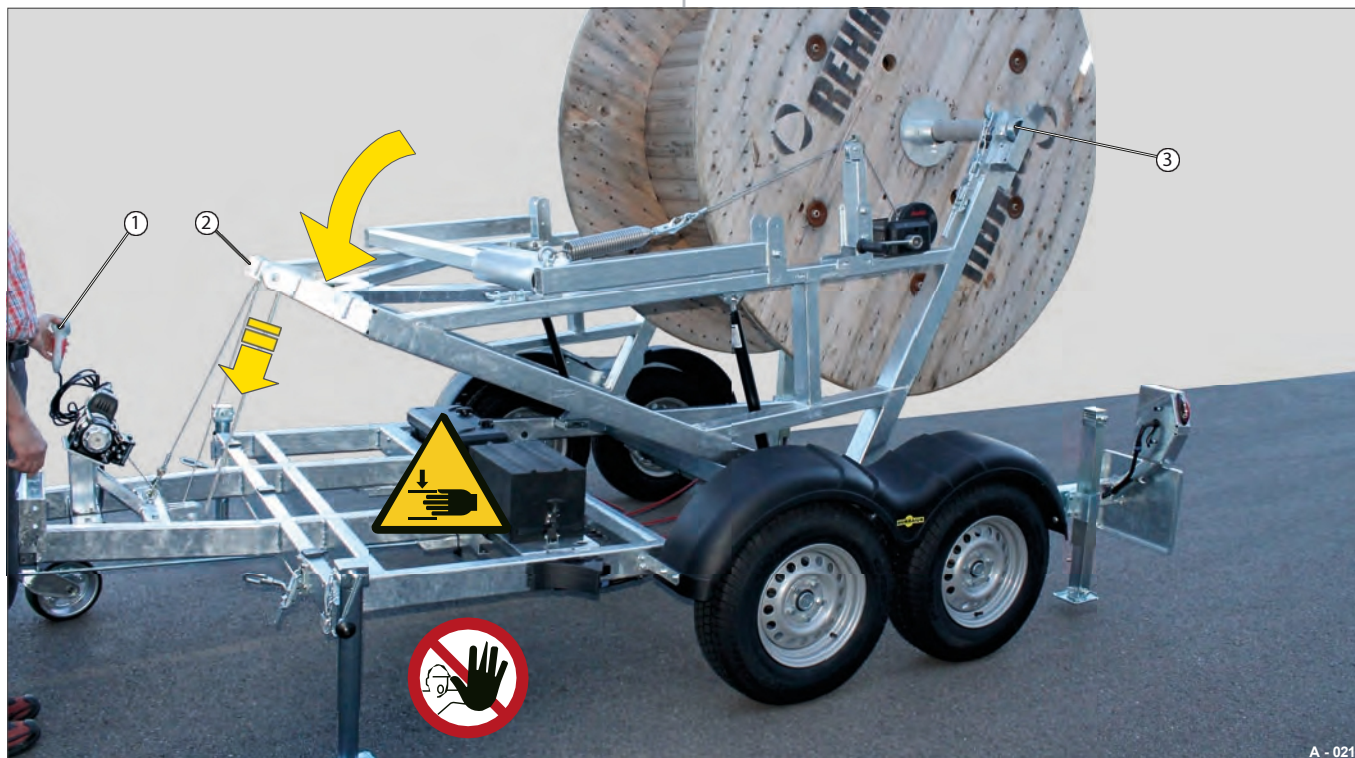
Obr. 12 Naklápění rámu bubnu dopředu
