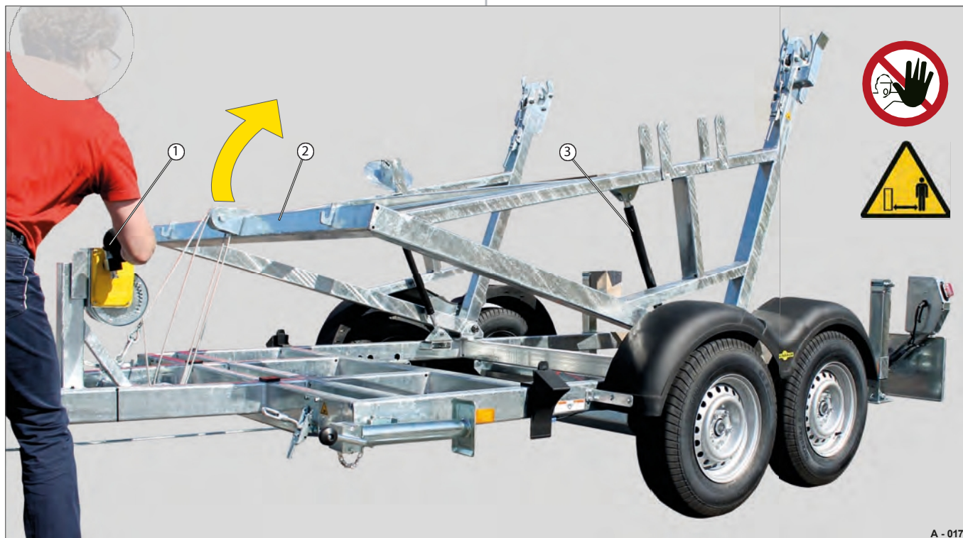
Obr. 8 Naklápění rámu bubnu dozadu
