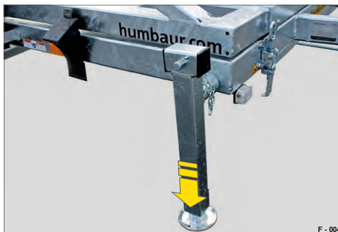
Obr. 4 Teleskopická podpěra kliky v podpěrné poloze
