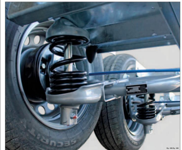
Mynd 21 EquiDrive PLUS S - fjöðrun með spiralfjöðrun
