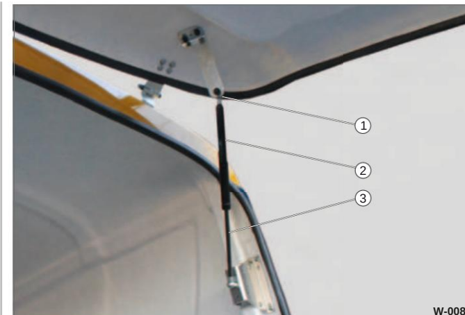
Mynd 8 Gasfjaður á afturhlara úr glerplasti
