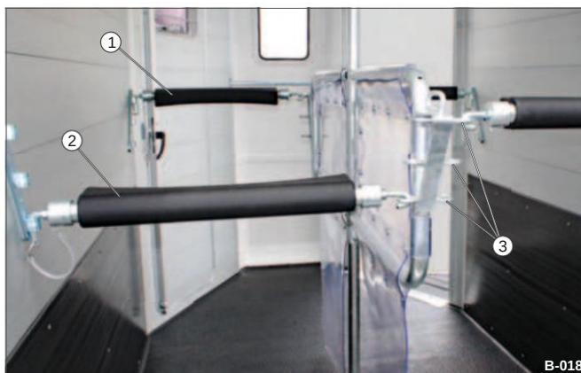
Mynd 22 Brjóst-/aftari stöng 1 Brjóststöng 2 Halabár 3 augnlok í 3 hæðum
