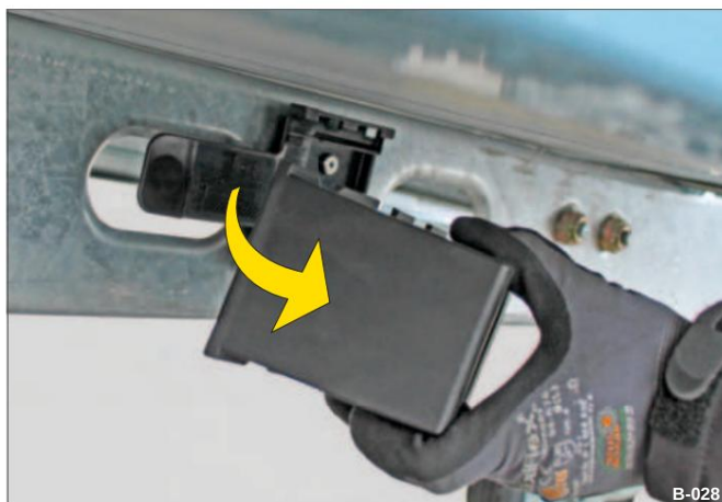
Mynd 35 Að fjarlægja hjólastoppið
