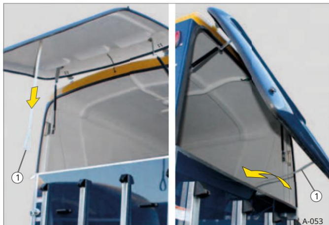
Sl. 55 Spuštanje stražnjih vrata GKF-a / spremanje upravljačkog remena 1 Upravljački remen
