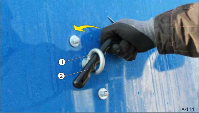
Sl. 116 Otključavanje izvana 1 prsten za vezivanje 2 hvataljka za kopito Umetnite hvataljku za kopita (Sl. 116/2) u prsten za vezivanje (Sl. 116/1). Okrenite alat za čiš ćenje kopita u smjeru suprotnom od kazaljke na satu.
