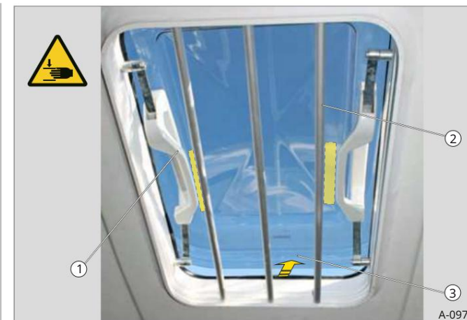
Sl. 99 Otvoren krovni prozor (u smjeru vož nje)
