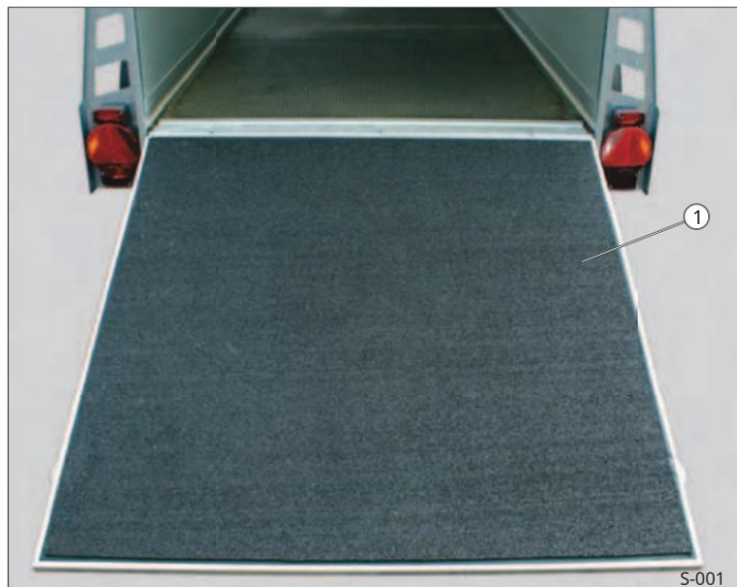
Sl. 2 Prijevoznik stoke Jednostruki: stražnja vrata 1 gumena granulirana podloga
