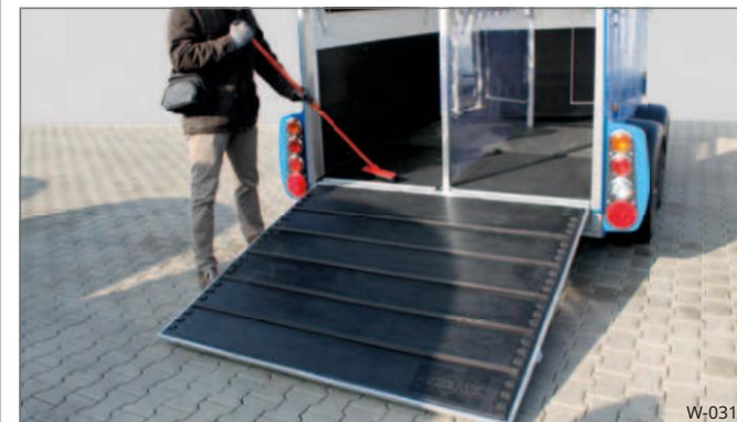
Sl. 31 Čišćenje stražnjih vrata / utovarnog prostora
