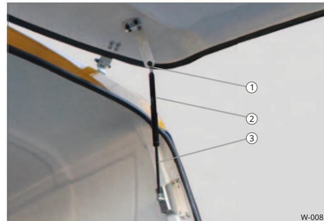
Sl. 8 Plinska opruga na stražnjim vratima od stakloplastike
