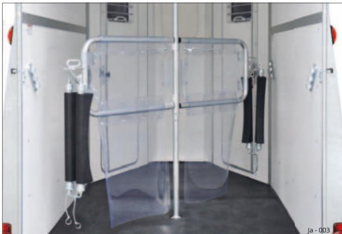
Sl. 8 Pregradni zid s okretnim središnjim stupom (primjer Notos)
