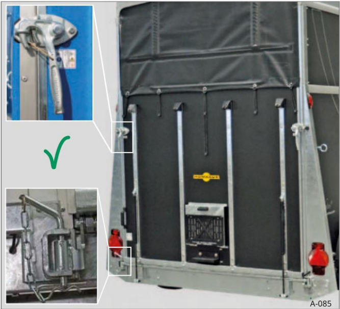
Sl. 87 Rotirajuća vrata zatvorena i osigurana
