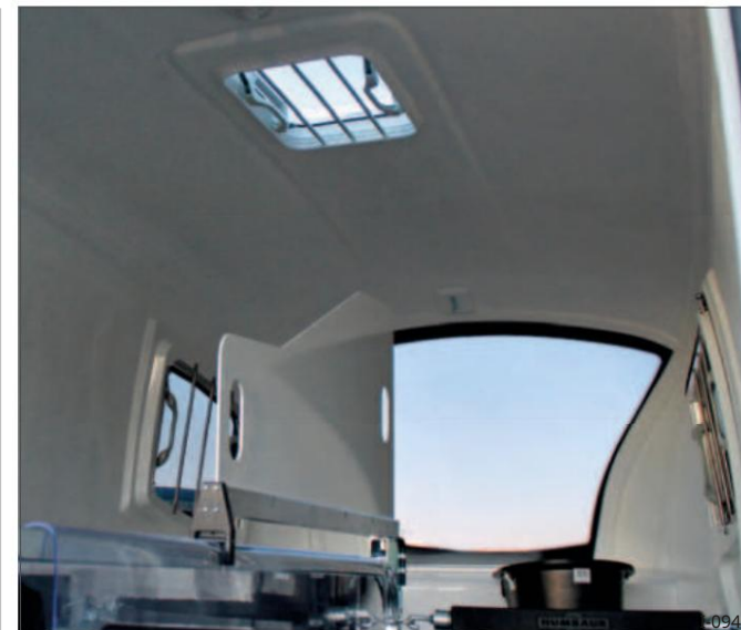
Sl. 20 Veliki panoramski prozor s krovnim ventilatorom
