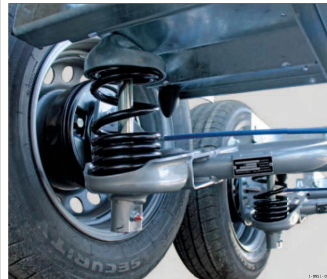
Sl. 21 EquiDrive PLUS S - ovjes s spiralnim oprugama
