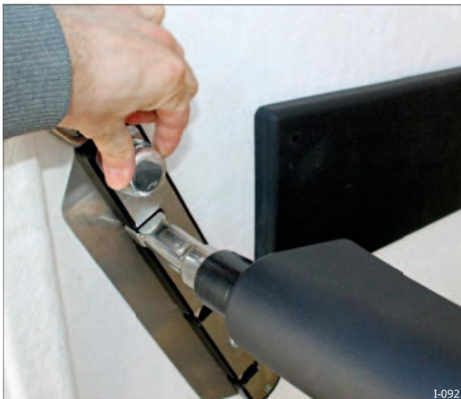
Sl. 18 Brzo otpuštanje u slučaju panike „EquiGuard“
