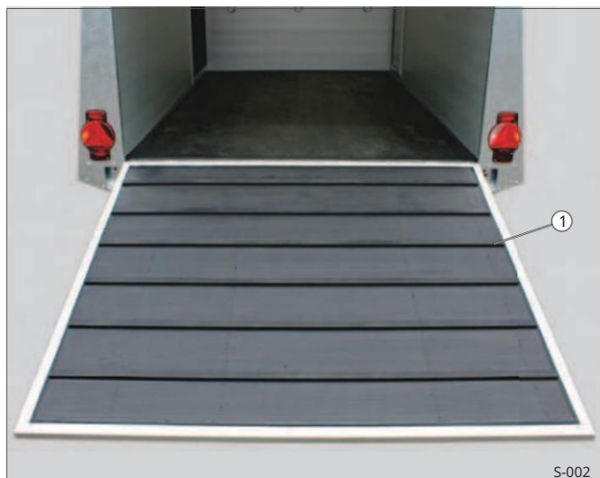
Sl. 3 Tandem za prijevoz stoke: stražnja vrata, 1 stepenica, gumena podloga
