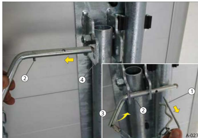
Sl. 25 Uklanjanje osigurača
