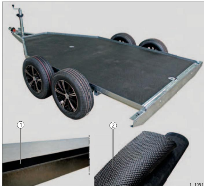
Sl. 11 AluBiComb podna konstrukcija
