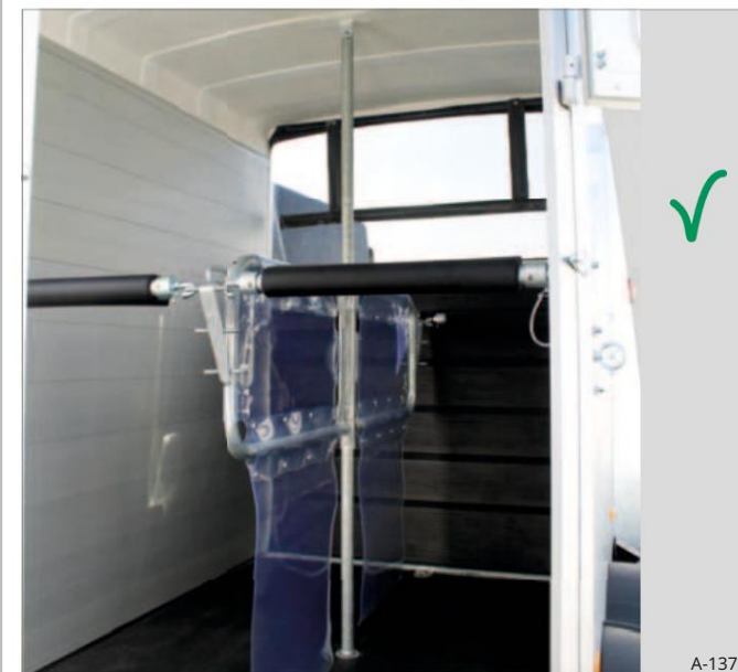
Sl. 143 Središ nja pregrada (rotirajuća) osigurana
