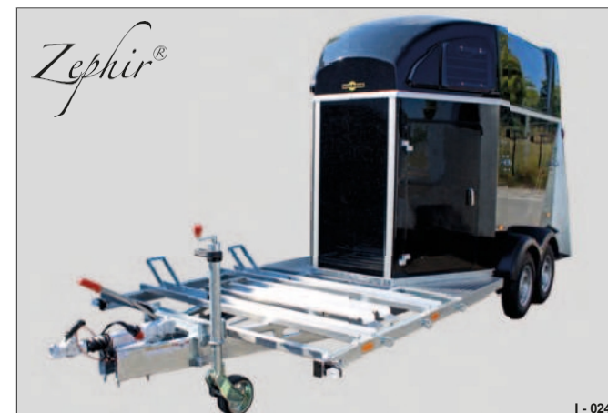
Slika 54 Voziček Zephyr (karoserija iz poliestra) z usmerjevalnikom vetra s prostorom za privezovanje z blažilnikom kolesa (100 km/h)
