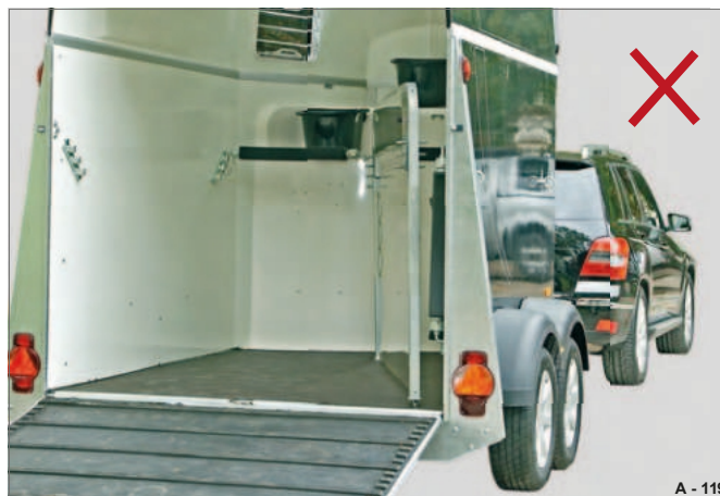
Slika 125 Nezavarovana sredinska pregrada
