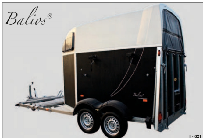
Slika 51 Voziček Balios (nadgradnja iz vezanega lesa in poliestra) brez usmerjevalnika vetra brez prostora za prijeme Nosilec vlečnega droga na strani
