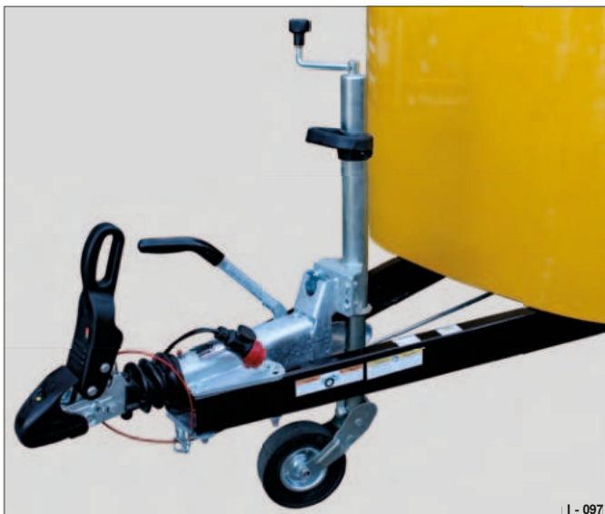
Slika 22 Spojka proti razlitju (ASK)
