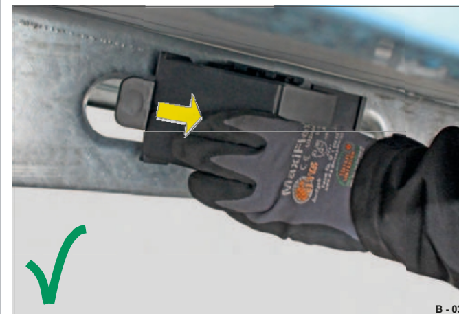
Slika 37 Pritrditev kolesnega opornika (vozni položaj)
