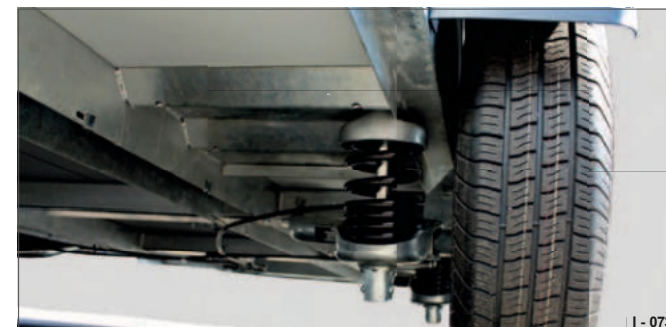
Slika 121 kot neodvisno vzmetenje koles
