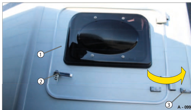
Slika 101 Odpiranje prezračevalnega okna
