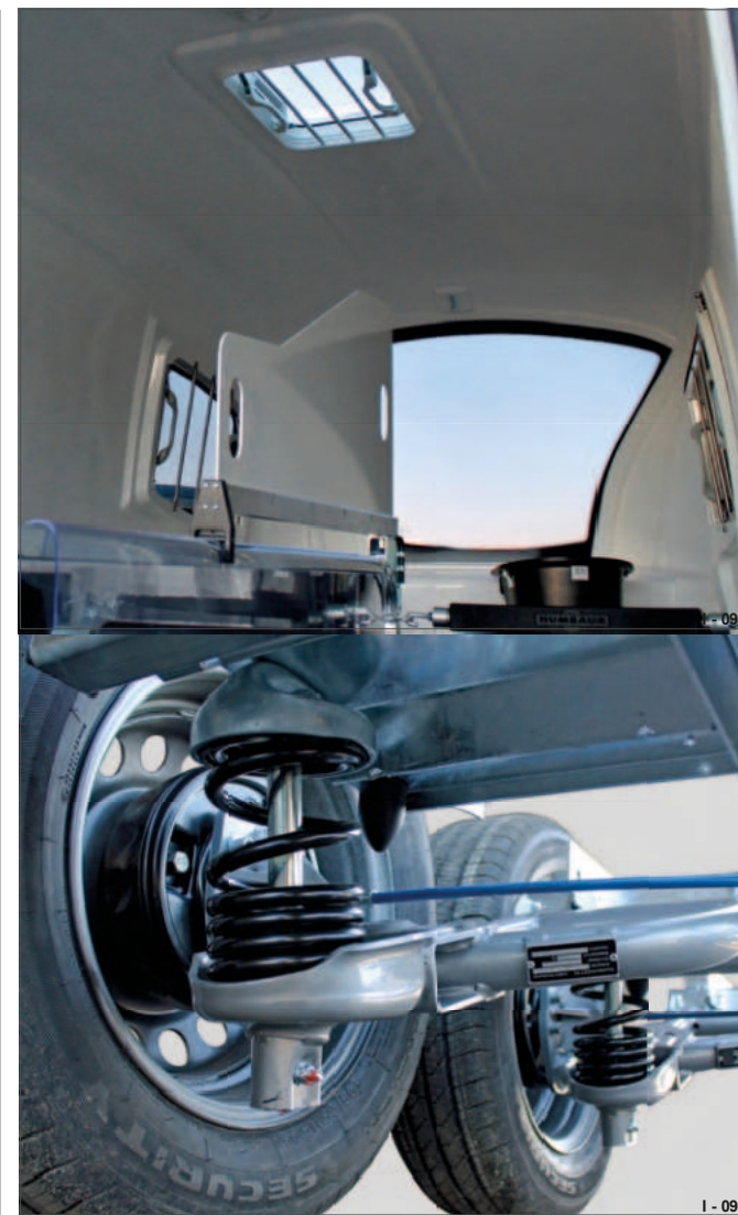
Slika 21 EquiDrive PLUS S - vzmetenje s spiralnimi vzmetmi
