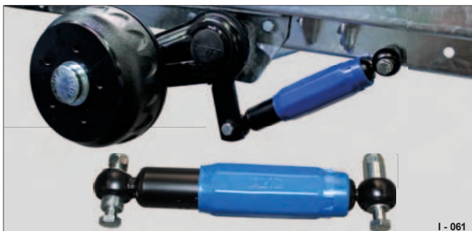
Slika 114 RSD ohlapen ali nameščen
