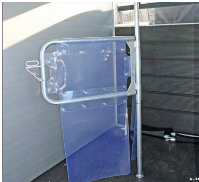
Fig. 138 Roterad position för mittväggen (Notos)
