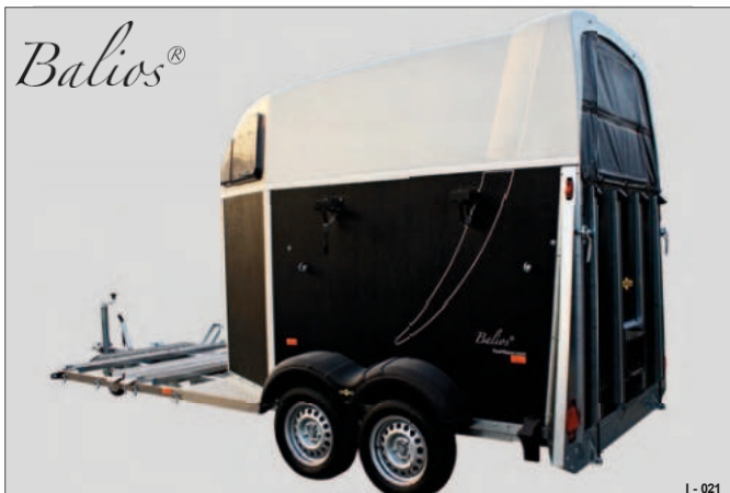
Fig. 51 Balios vagn (överbyggnad av plywood-polyester) utan vindavvisare utan sadelkammare Hållare för vagnens dragstång på sidan
