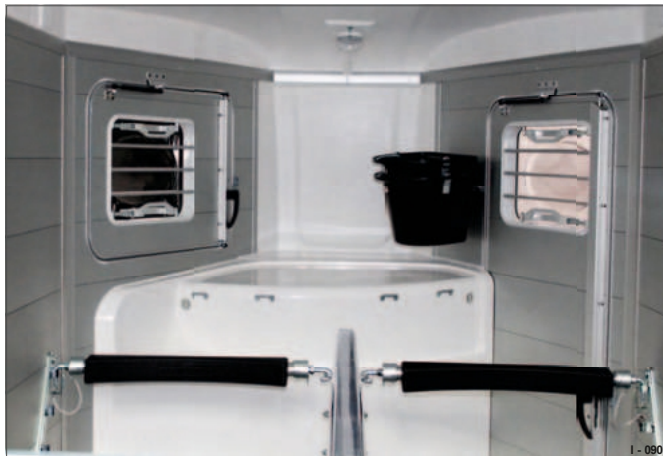
Fig. 9 EquiLock skiljevägg (Notos exempel)
