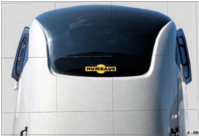
Fig. 88 Ventilationsfönster öppet på båda sidor
