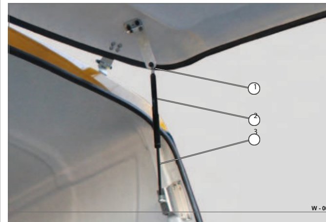
Fig. 8 Gasfjäder på bakluckan av glasfiberarmerad polyester
