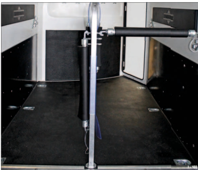
Fig. 23 Stoppning av sidoväggarna
