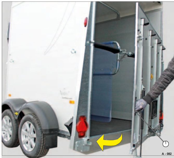
Fig. 86 Säkra låsbultens låsspärr
