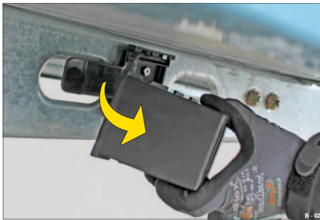
Fig. 35 Demontering av hjulbock
