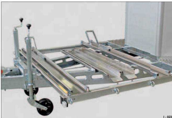
Fig. 53 Två stödhjul (tillval) för parkering av en tillkopplad släpvagn
