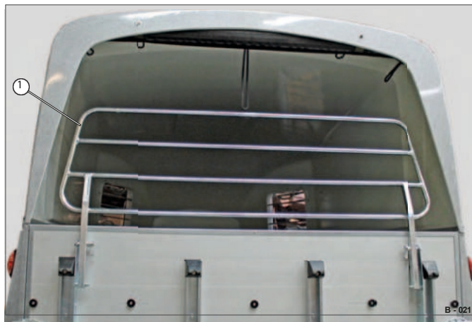
Rys. 25 Zabezpieczenie przed wyskoczeniem
