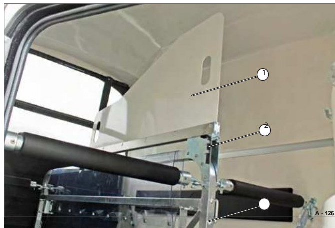
Rys. 132 Zamontowana ścianka działowa / pozycja spoczynkowa
