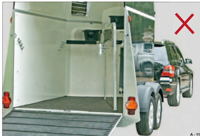
Rys. 125 Niezabezpieczona przegroda środkowa
