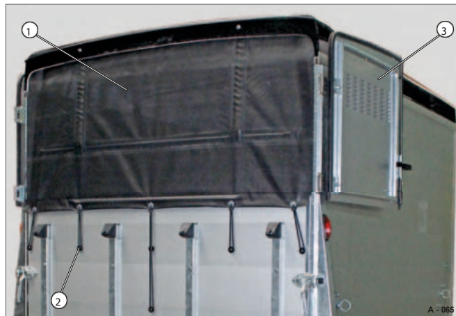
Rys. 67 Kłapy uchylne otwarte / pozycja jazdy
