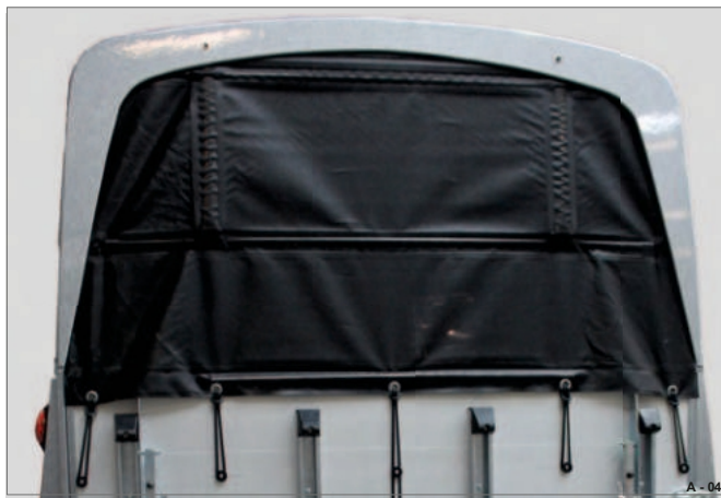
Rys. 45 Przykład plandeki rolowanej Xanthos
