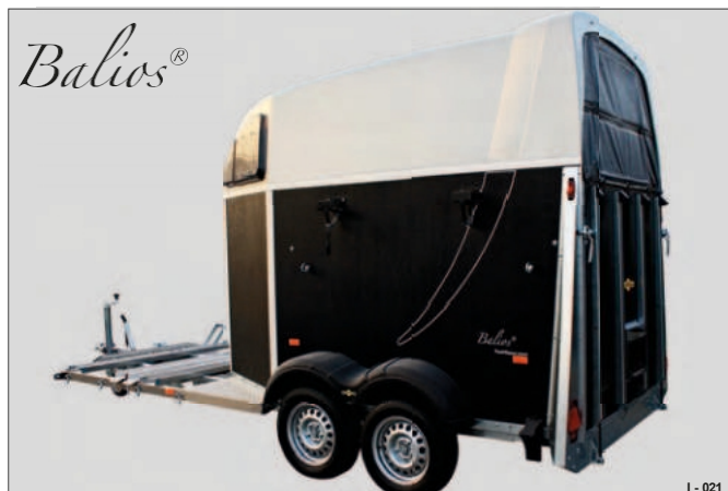
Rys. 51 Wózek Balios (nadbudowa ze sklejki i poliuretanu)
