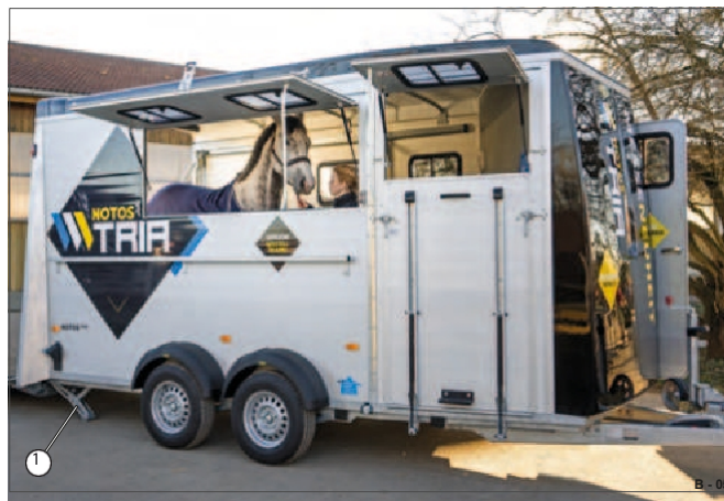
Rys. 43 Przyczepa podparta z tyłu
