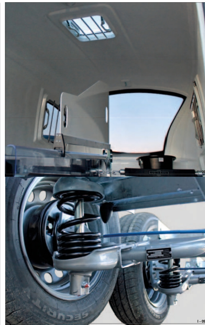
Rys. 21 EquiDrive PLUS S - zawieszenie na sprężynach śrubowych
