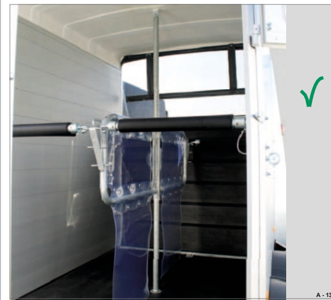
Rys. 143 Zabezpieczona przegroda środkowa (obrotowa)
