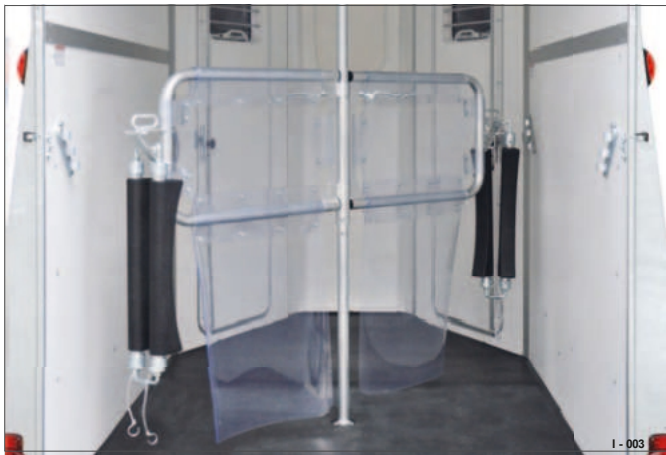
Rys. 8 Obrótowa ścianka działowa ze słupkiem środkowym (przykład Notos)
