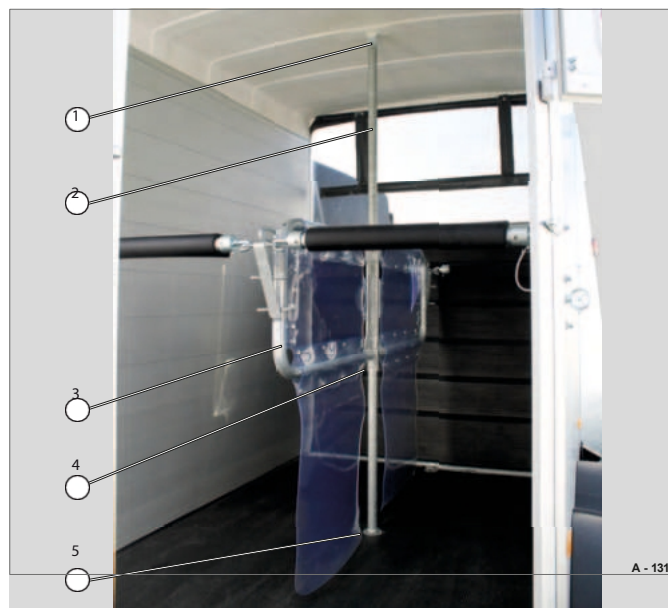
Rys. 137 Przegrody środkowe (Notos)
