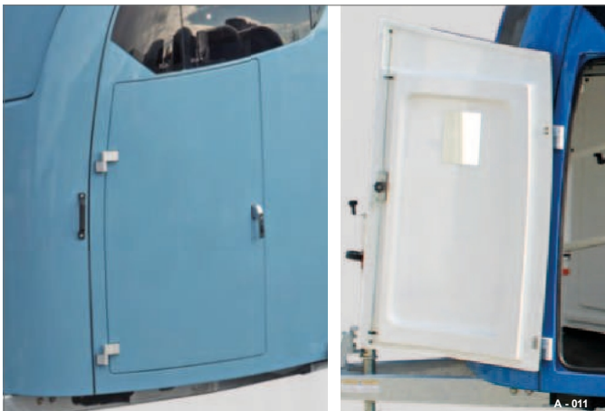
Rys. 13 Drzwi komory siodła zamknięte / otwarte
