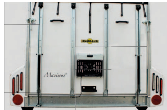
Rys. 44 Maximus DELUXE (S) - tyłne światła LED z funkcją specjalną Designerski błotnik
