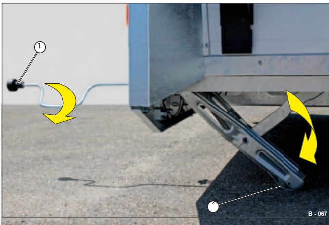
Rys. 7 Opuszczanie do pozycji podparcia
