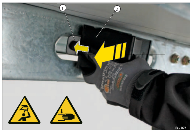
Rys. 34 Odblokowywanie klina pod koło
