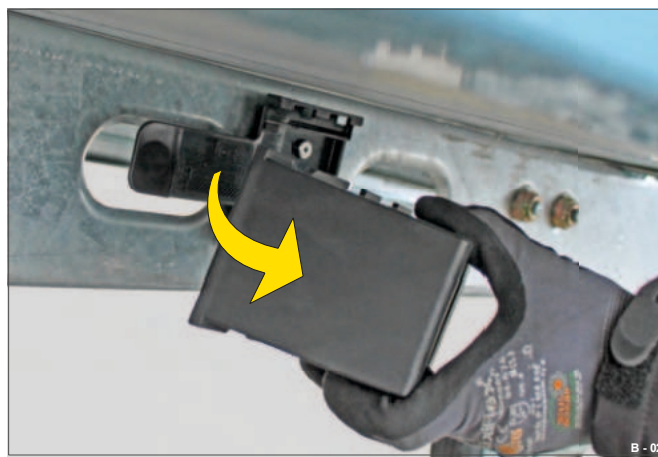
Rys. 35 Zdejmowanie klina pod koło
