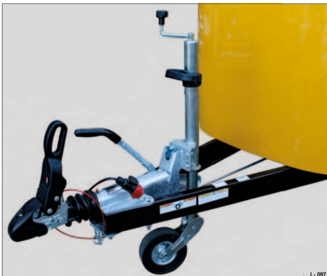
Rys. 22 Sprzęgło zapobiegające wyciekom (ASK)
