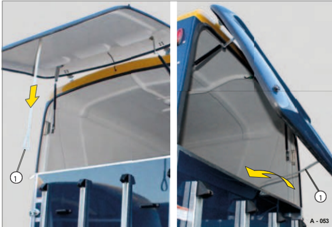
Rys. 55 Opuszczanie kłapy tylnej GKF / chowanie pasa roboczego
