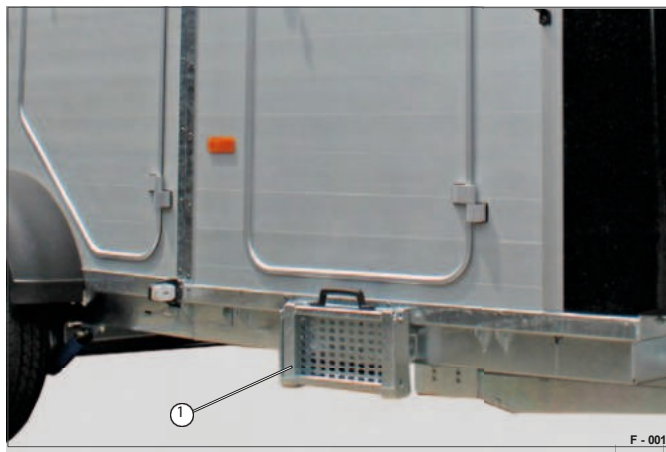
Rys. 10 Stopień przed dostępną kabiną (pozycja podróżna)
