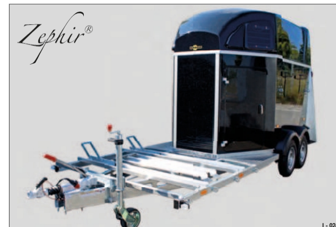
Rys. 54 Wózek Zephyr (nadwozie w całości wykonane z poliuretanu)
