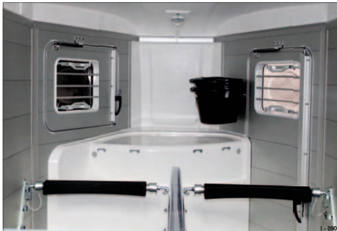
Rys. 9 Ścianka działowa EquiLock (przykład Notos)
