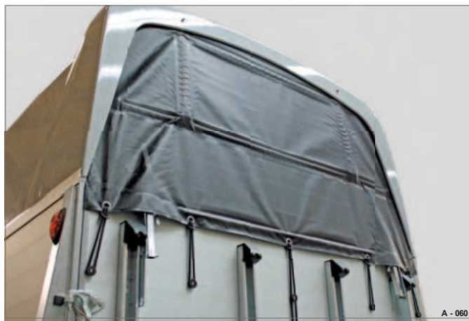
Rys. 62 Kratka foliowa z owiewką / plandeką rolowaną
