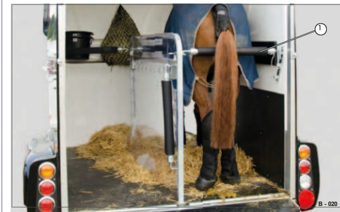
Rys. 24 Tylina belka - koń zabezpieczony
