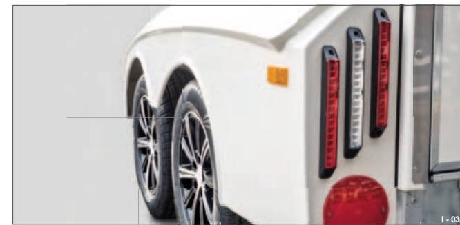
Rys. 83 Tylne światła LED (Maximus)
