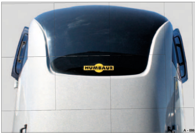
Rys. 88 Okno wentylacyjne otwarte z obu stron
