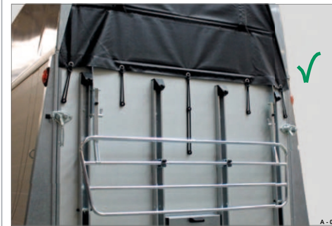
Rys. 65 Bramka dla żrebiąt złożona i zabezpieczona
