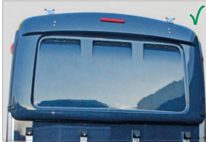
Rys. 57 Kłapa tylna GRP zamknięta i zabezpieczona
