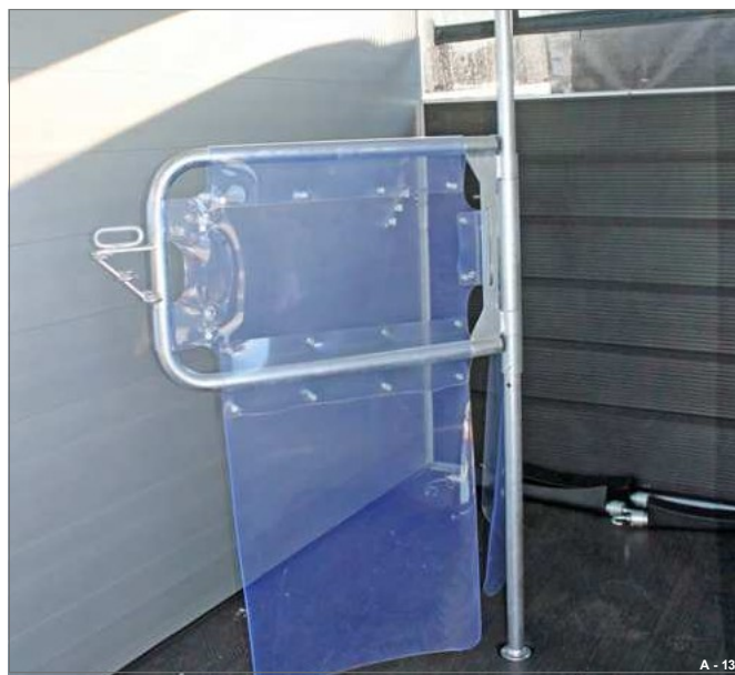
Rys. 138 Obrócona pozycja przegrody środkowej (Notos)
