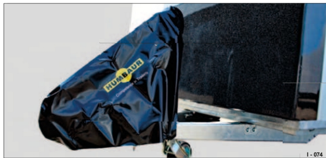
Rys. 122 Zabezpieczenie zaczepu najazdowego
