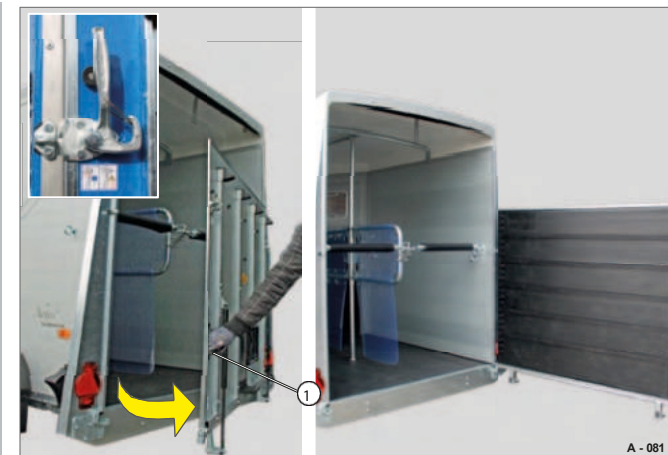
Rys. 83 Drzwi wahadłowe otwarte / uchylone
