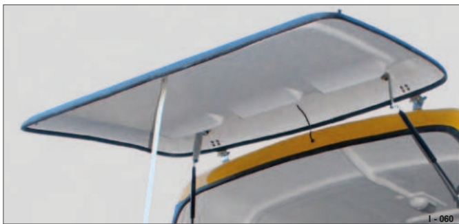
Fig. 113 Vindflap i glassfiberarmert polyester bak i stedet for vindavviser
