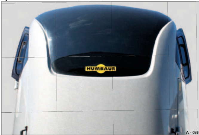
Fig. 88 Ventilasjonsvindu åpent på begge sider
