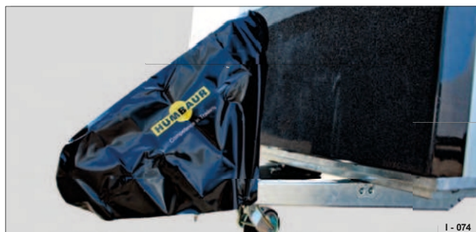
Fig. 122 Beskyttelse av påløpsfestet
