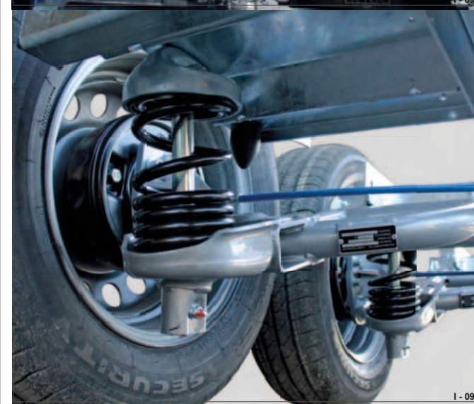
Fig. 21 EquiDrive PLUS S - fjæring med spiralfjærer
