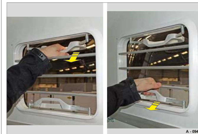
Fig. 96 Lukking av ventilasjonsvinduet
