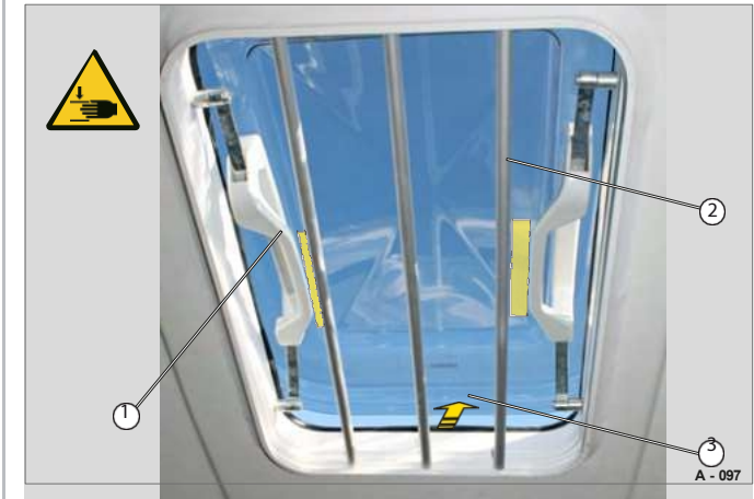
Fig. 99 Takvindu åpent (i kjøreretningen)
