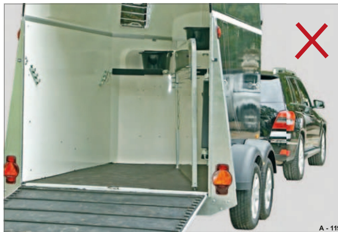
Fig. 125 Midtvegg uten sikring
