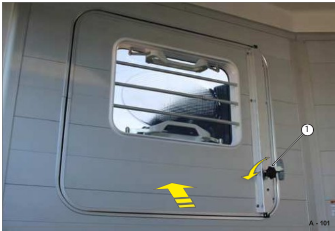
Fig. 103 Åpning av ventilasjonsvinduet fra innsiden
