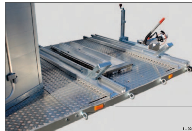
Fig. 55 Dekket vognramme (ekstrautstyr) Aluminiumsplate som deksel
