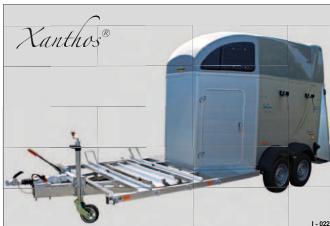
Fig. 52 Xanthos-vogn (overbygning av aluminium-polyester) med vinddeflektor uten takrom med AluBiComp-base
