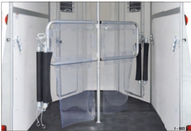
Fig. 8 Svingbar midtstolpevegg (Notos-eksempel)
