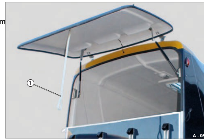
53 pav. 53 Atidarytos GRP galinės durys
