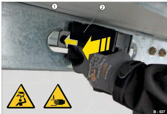
34 pav. 34 Ratų fiksatoriaus atrakinimas
