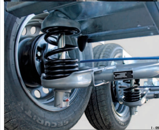
21 pav. "EquiDrive PLUS S" - spyruoklinė pakaba
