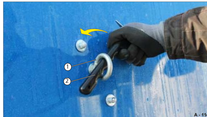
116 pav. 116 Atrakimas iš išorės
