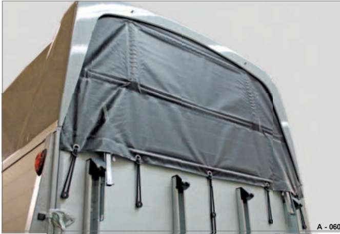
62 pav. Kailinės grotelės su vėjo deflektoriumi / ritiniu brezentu
