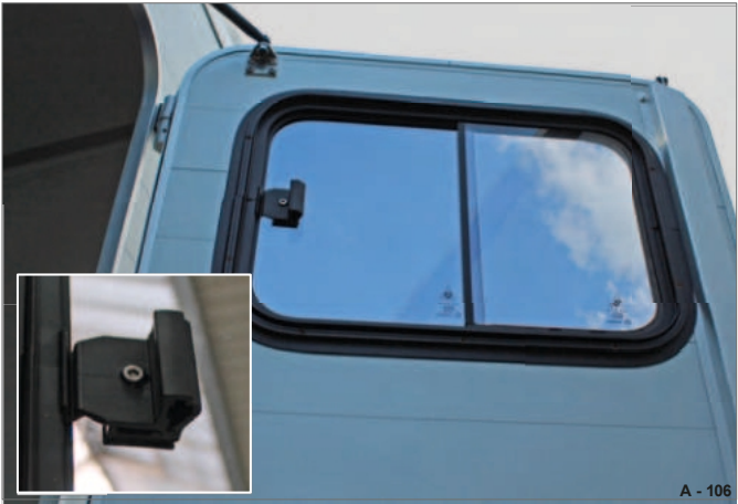
108 pav., užrakinta Rankena turi užsikabinti.
