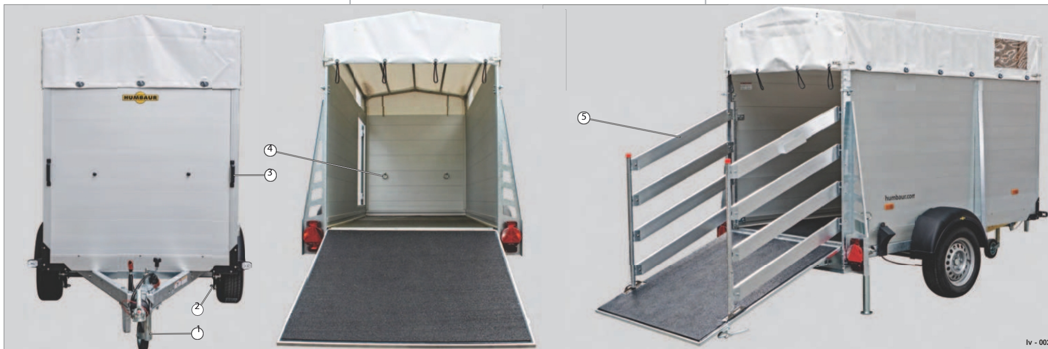
67 pav. Bendras vaizdas: HEV vienašė priekaba iš aliuminio
