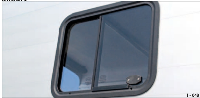
100 pav. Stumdomas langas vietoj sklendžių
