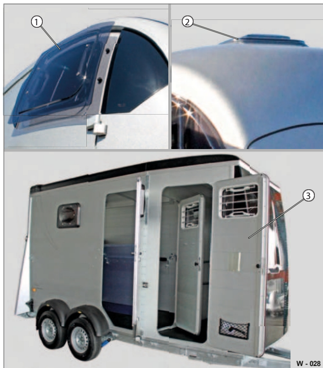
28 pav. Priekabos vėdinimas / džiovinimas
