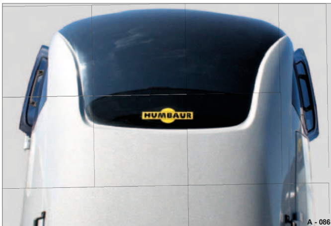
88 pav. Abiejose pusėse atidarytas ventiliacijos langas
