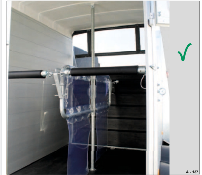
Kuva 143 Keskimmäinen väliseinä (käännettävä) kiinnitetty.
