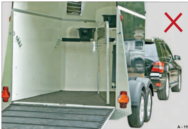
Kuva 125 Keskimmäinen väliseinä kiinnittämättömänä
