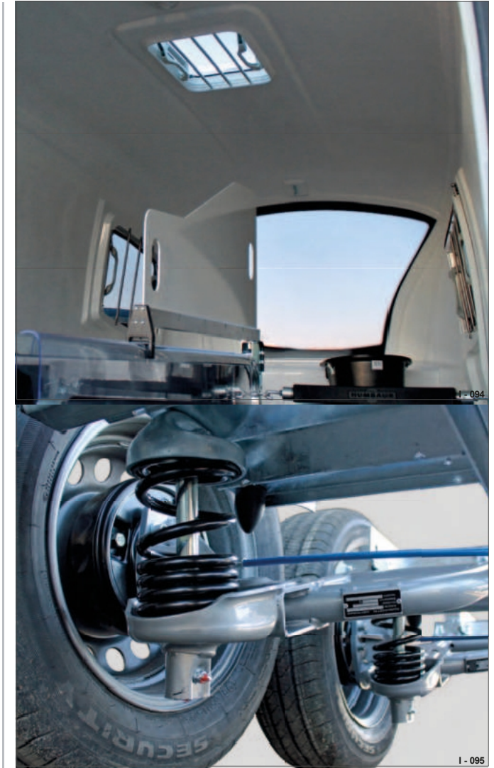
Kuva 21 EquiDrive PLUS S - kierrejoussijousitus
