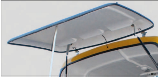
Kuva 113 Takimmainen lasikuituinen tuulilaippa tuulensuojalevyn sijasta.
