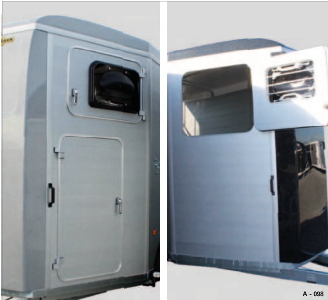
Kuva 100 Ilmanvaihto-ikkuna suljettu / avattu
