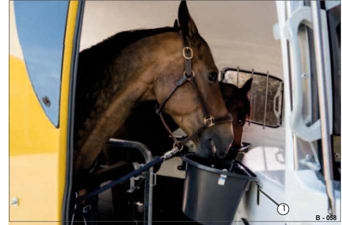
Kuva 52 Käytössä olevat ruokintakaukalot
