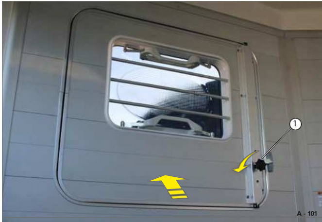
Kuva 103 Tuuletusikkunan avaaminen sisäpuolelta
