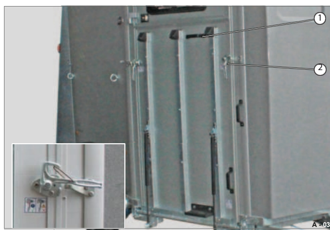
Kuva 39 Etuluukun alas taittaminen
