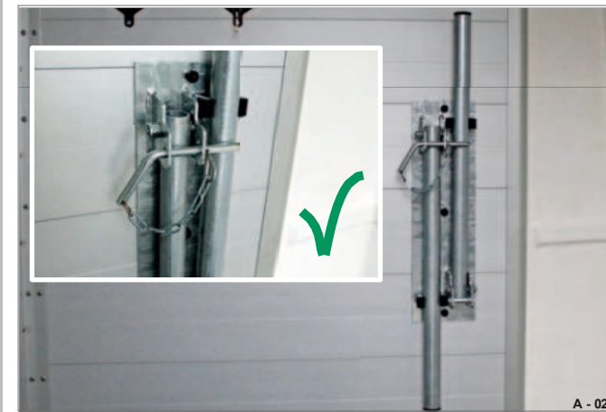
Fig. 31 Sadelholder foldet ind og fastgjort
