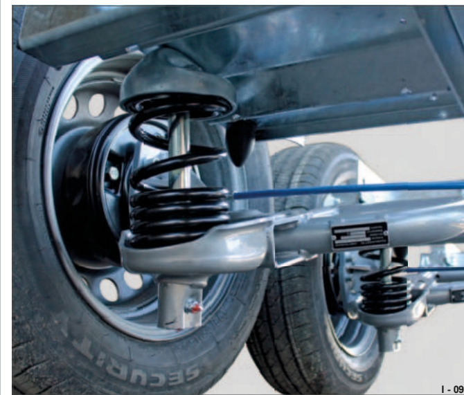
Fig. 21 EquiDrive PLUS S - affjedring med spiralfjedre
