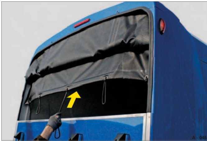
Fig. 47 Sammenrulning af vindafviser / rullepresenning
