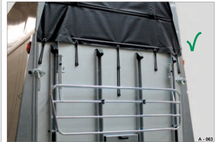
Fig. 65 Følle's låge foldet ned og sikret
