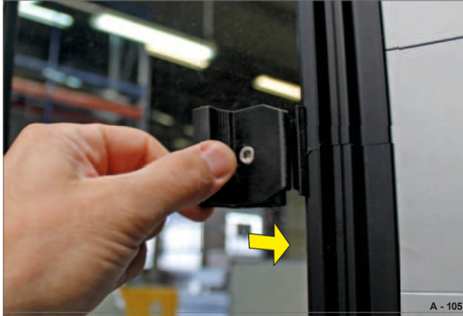
Fig. 107 Lukning af det glidende vindue ► Skub vinduet lukket i håndtaget.
