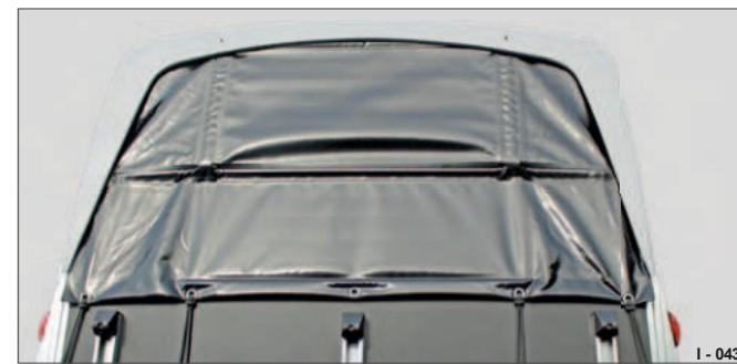
Fig. 94 Rullepresenning i stedet for vindafviser
