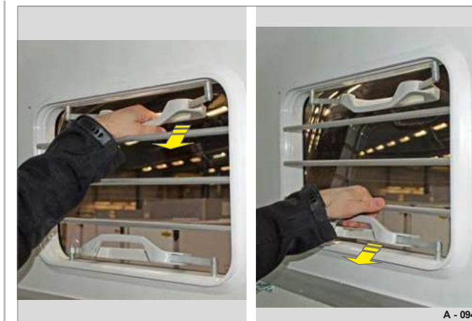
Fig. 96 Lukning af udluftningsvinduet
