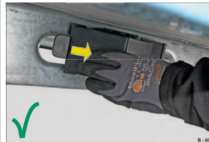
Fig. 37 Fastgørelse af hjulkilen (køreposition)
