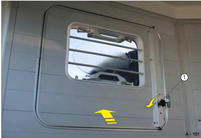
Fig. 103 Åbning af ventilationsvinduet indefra
