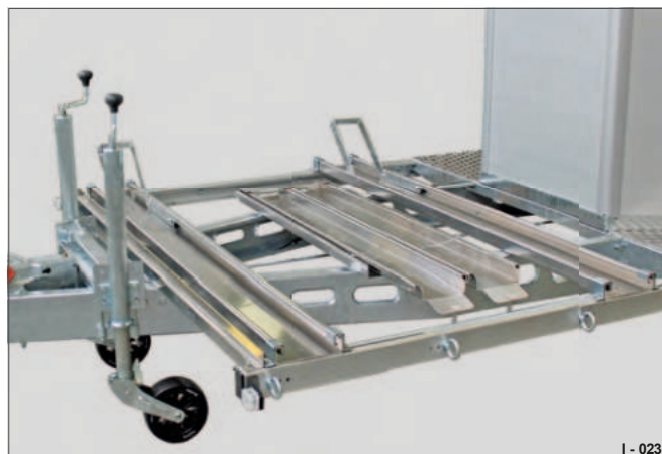
Fig. 53 To støttehjul (ekstraudstyr) til parkering af en afkoblet trailer
