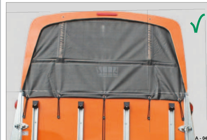
Fig. 51 Vindafviser / rullepresenning lukket
