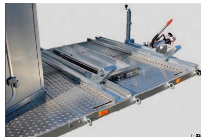
Fig. 55 Overdækket vognramme (ekstraudstyr) Aluminiumsplade som afdækning
