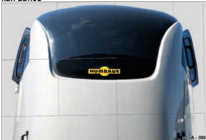
Fig. 88 Udluftningsvindue åbent i begge sider
