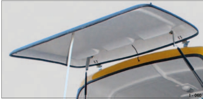
Fig. 113 GRP-vindflap bagpå i stedet for vindafviser
