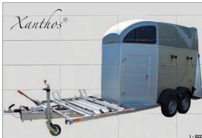
Fig. 52 Xanthos-vogn (overbygning af aluminium-polyester) med vindafviser uden sadelrum med AluBiComp-base
