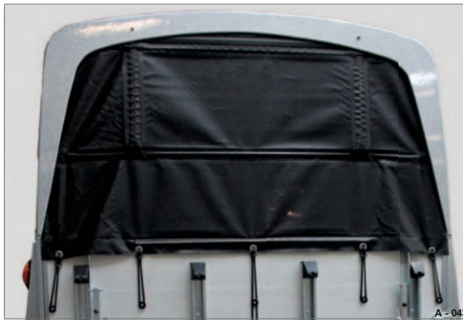
Fig. 45 Eksempel på Xanthos rullepresenning
