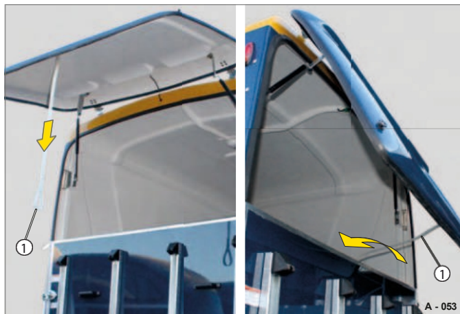
Obr. 55 Stažení zadních dveří GKF / uložení ovládacího pásu
