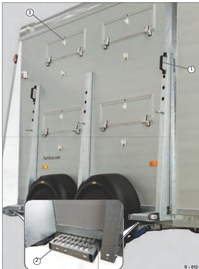
Obr. 13 Velkokapacitní přívěs pro hospodářská zvířata: ovládání klapek
