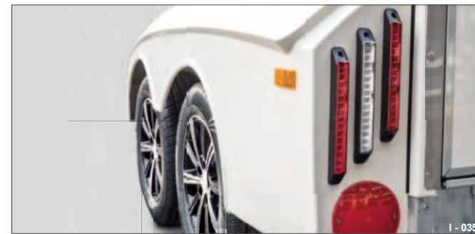
Obr. 83 Zadní světla LED (Maximus)
