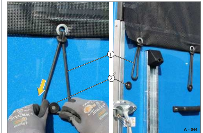
Obr. 46 Otevření pružných uzávěrů
