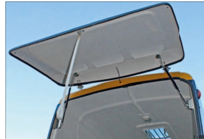
Obr. 7 Větrná klapka (volitelná)
