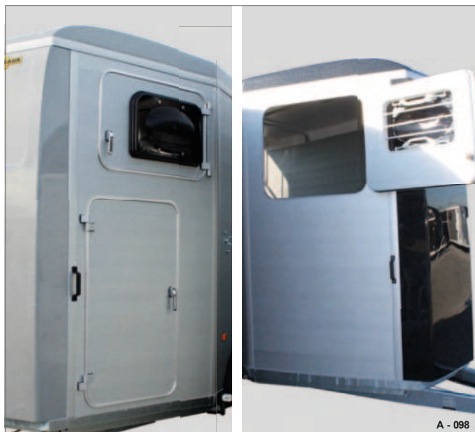
Obr. 100 Větrací okno zavřené / otevřené
