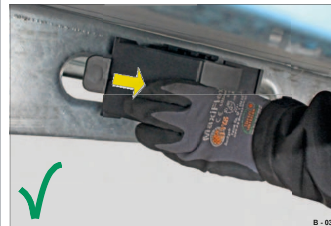
Obr. 37 Upevnění klínu kola (poloha řidiče)
