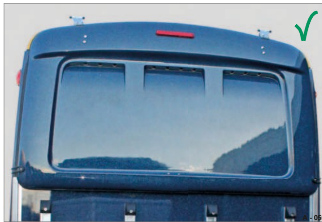
Obr. 57 Zavřené a zajištěné zadní dveře z laminátu
