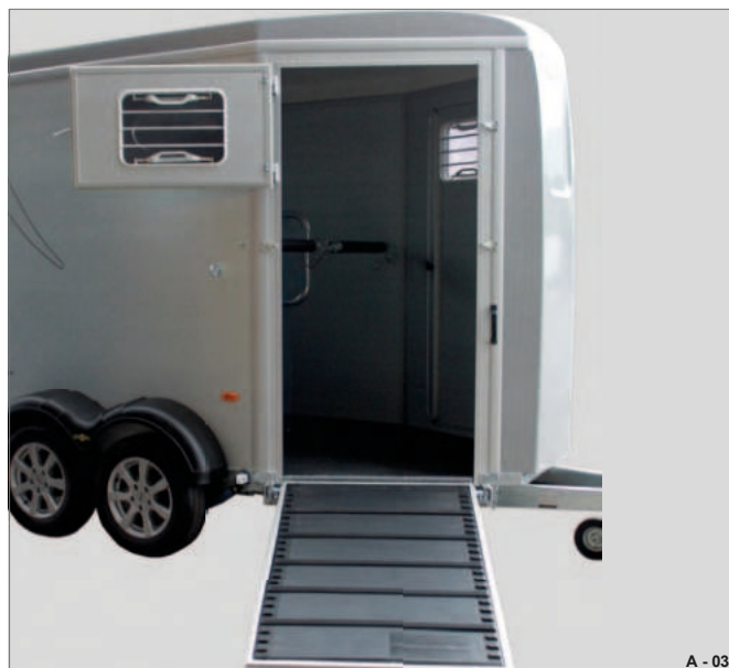
Obr. 35 Přední výstup Notos ALU sklopený dolů
