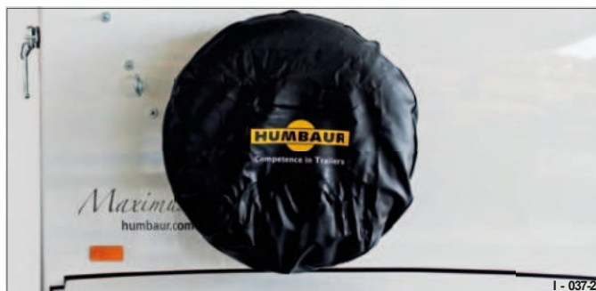
Obr. 88 boční montáž pro velikost kol 13" a 14"
