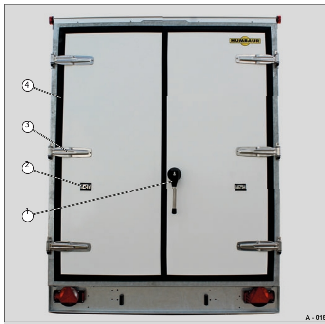
Slika 15 Dvokrilna vrata hladilnice (zaprta)
