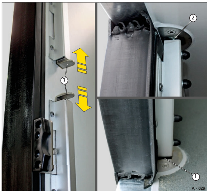
Slika 26 Zaklepni mehanizem vratnega krila je zaklenjen
