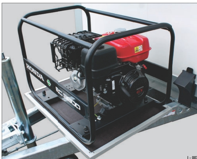
Slika 11 Generator električne energije Honda EC 3600 / 3,6 kVA z mehkim pokrovom
