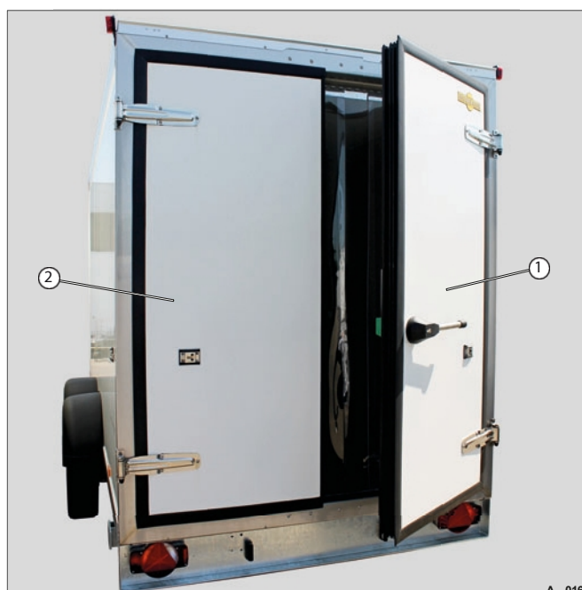
Slika 16 Vrata hladilnice (odklenjena)
