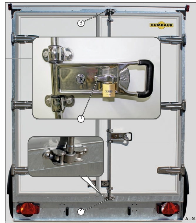
Slika 14 Vrata portala zadnje plošče so zaklenjena
