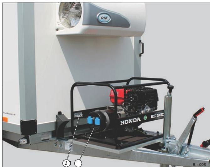
Slika 7 Generator energije na vlečnem drogu
