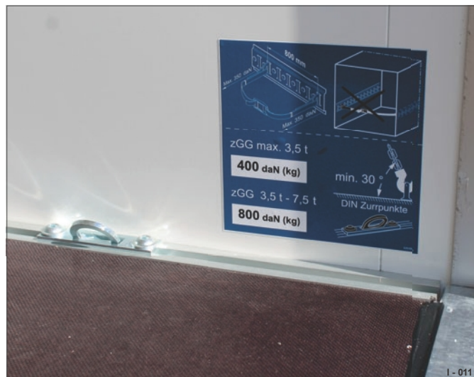
Slika 21 4 kosi na vsaki strani, vgrajeni v talno tirnico
