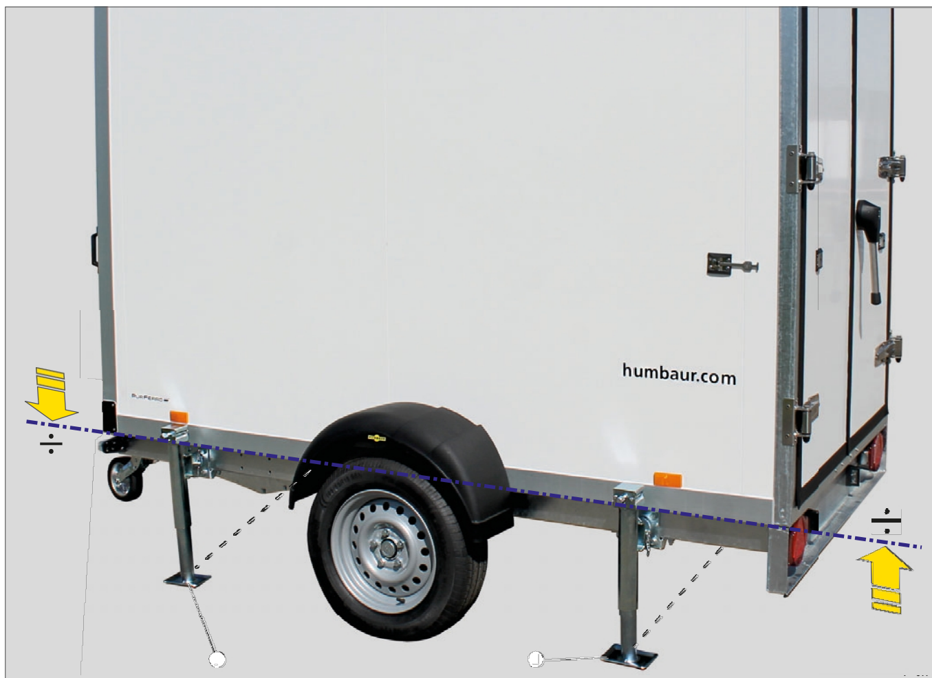
Fig. 10 Kylväska med stöd på 4 sidor, horisontellt balanserad
