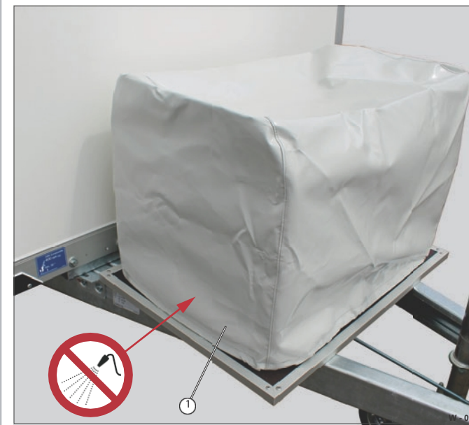
Fig. 20 Rengöring av kraftgeneratorm
