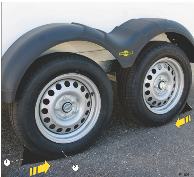
Fig. 4 Hjuldämpare placerade undertill i parkeringsläge
