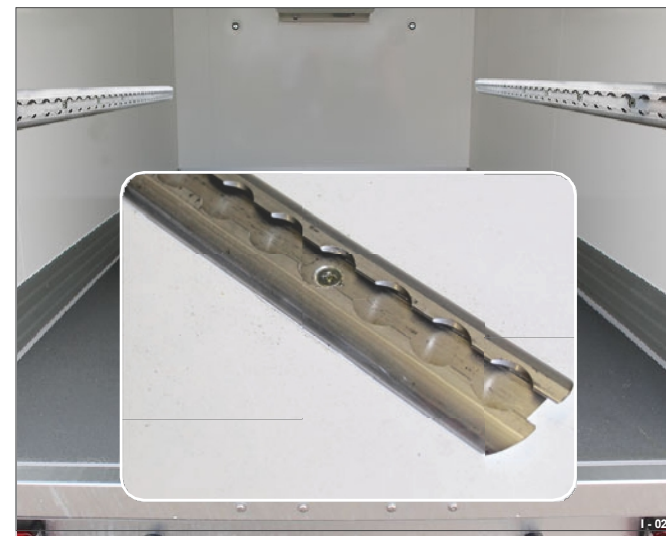
Fig. 26 Skruvas fast på sandwichvägg
