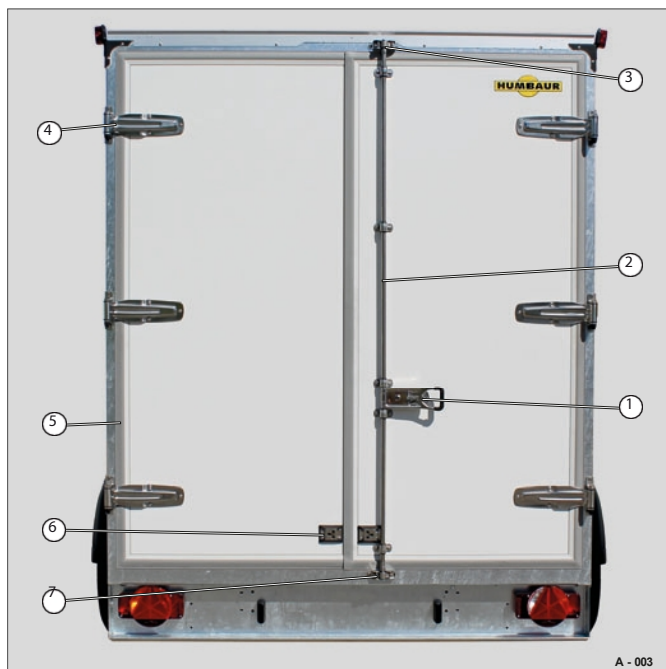
Fig. 3 Bakre portaldörr med dubbla dörrblad (stängd i köräge)
