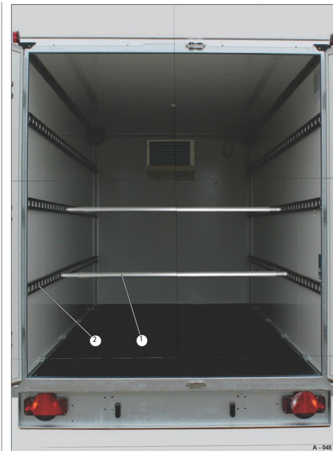
Fig. 48 Spännstänger säkrade (låsbåge)
