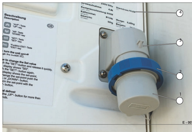
Fig. 8 Nätanslutning (på utsidan av kylaggregatet)
