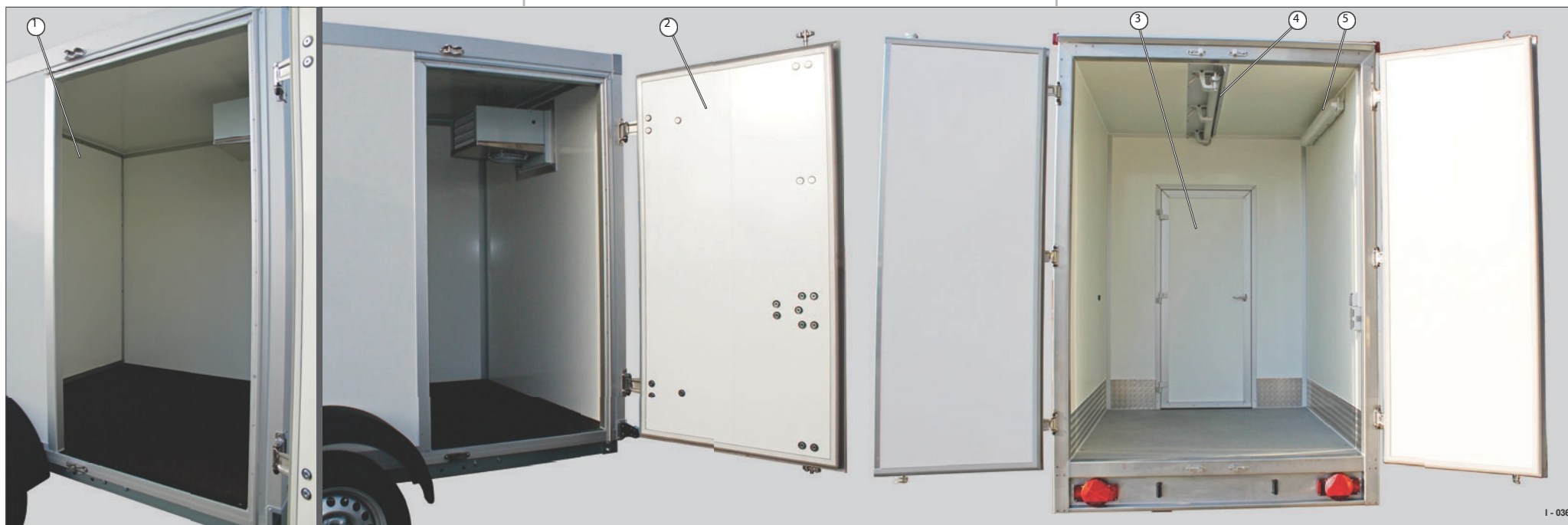
Fig. 38 Tandem-kylbox med mellanvägg
