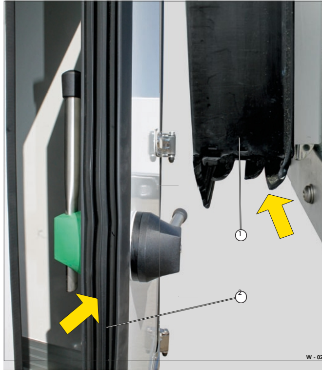
Fig. 11 Dörrtätning 4-faldig (Cool Trailer Profi)
