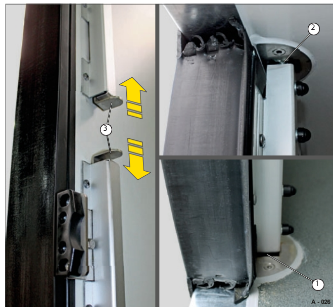
Fig. 26 Dörrbladets låsmekanism låst
