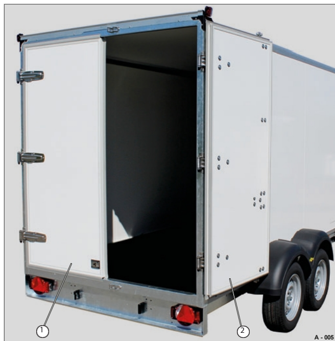
Fig. 4 Portallucka på bakre panelen (1 panel öppen)
