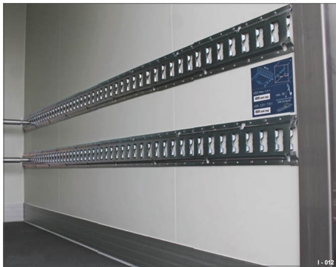
Fig. 22 Skruvas fast på sandwichvägg
