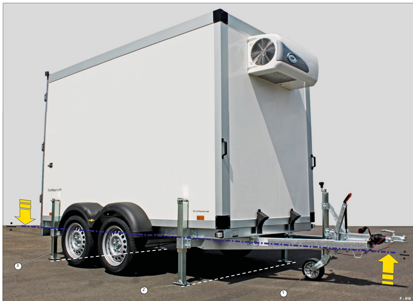
Fig. 17 Kylskåp med stöd på 4 sidor, horisontellt balanserat
