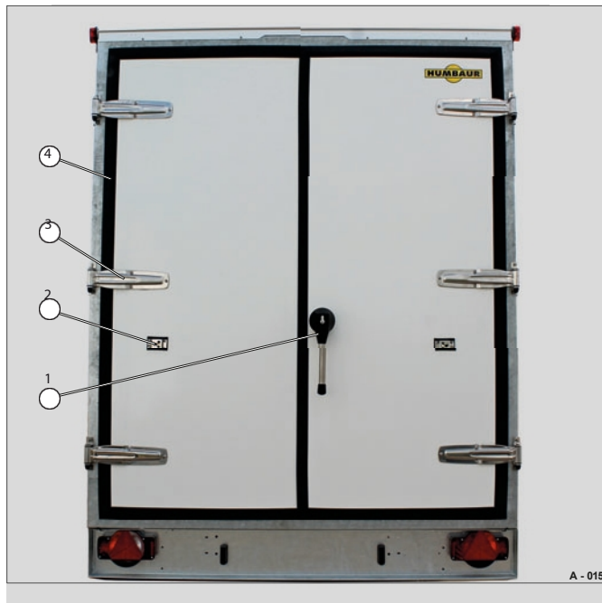
Fig. 15 Dubbelbladiga kylrumsdörrar (stängda)
