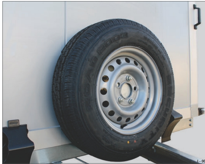
Fig. 17 Reservhjul med e-wheel-hållare, framsida
