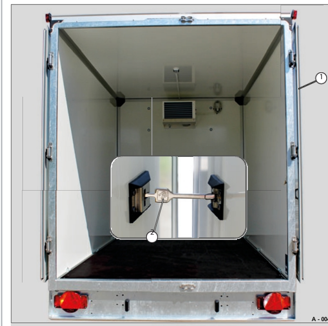
Fig. 5 Portallucka på baksidan (helt öppen)
