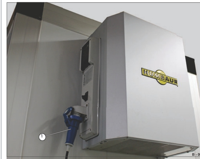
Fig. 3 Unidade de arrefecimento ligada a 230 V
