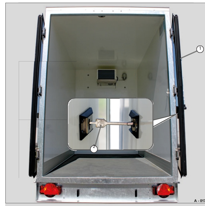
Fig. 18 Portas da câmara frigorífica (abertas)
