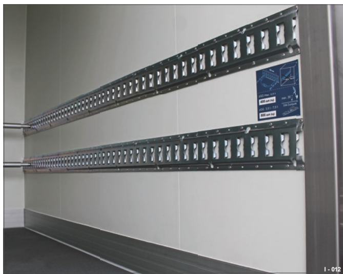
Fig. 22 Aparafusada na parede sandwich
