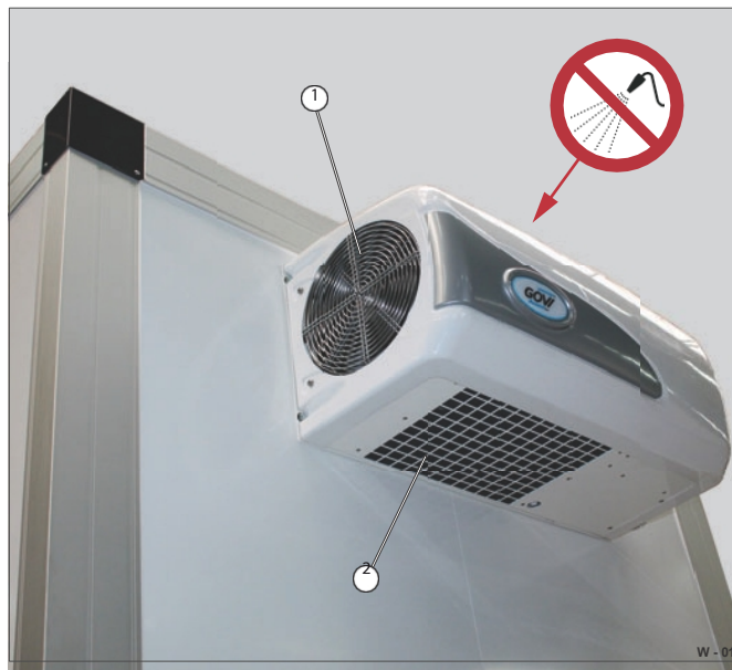
Fig. 19 Limpeza da unidade de arrefecimento
