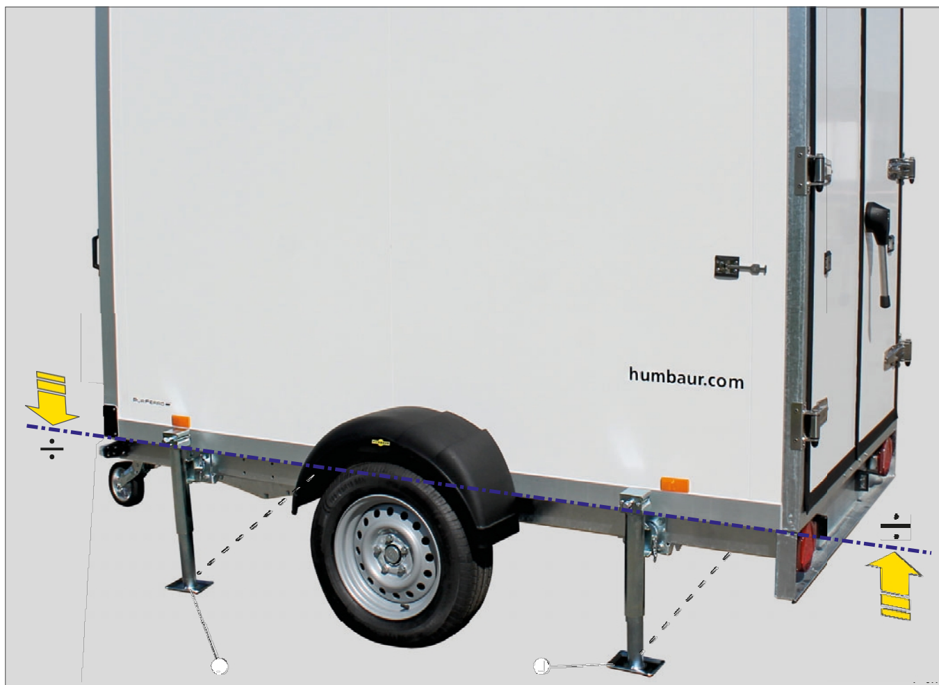
Fig. 10 Caixa frigorífica 4 - apoiada lateralmente, equilibrada horizontalmente
