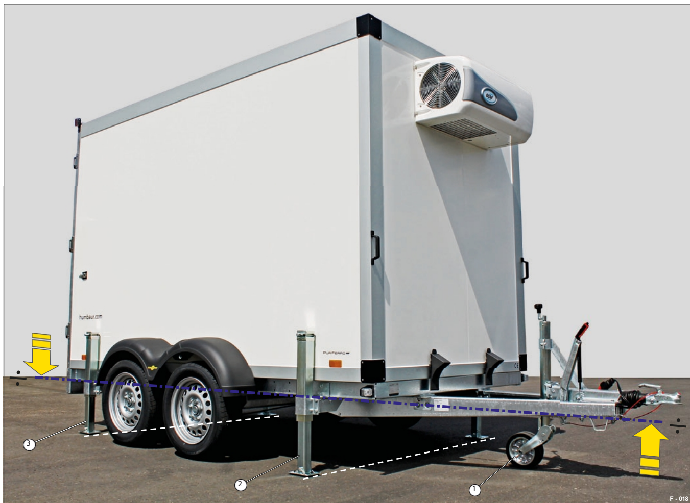
Fig. 17 Corpo da caixa frigorífica apoiado em 4 lados, nivelado horizontalmente
