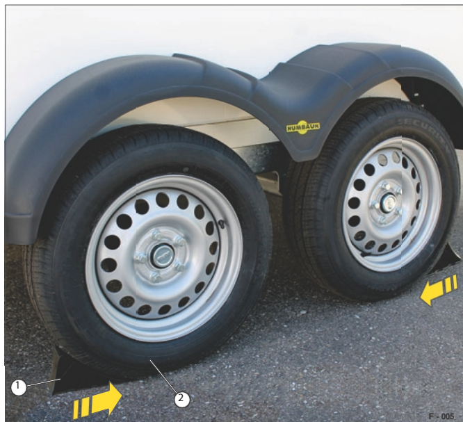
Fig. 4 Calços de roda colocados na posição de estacionamento
