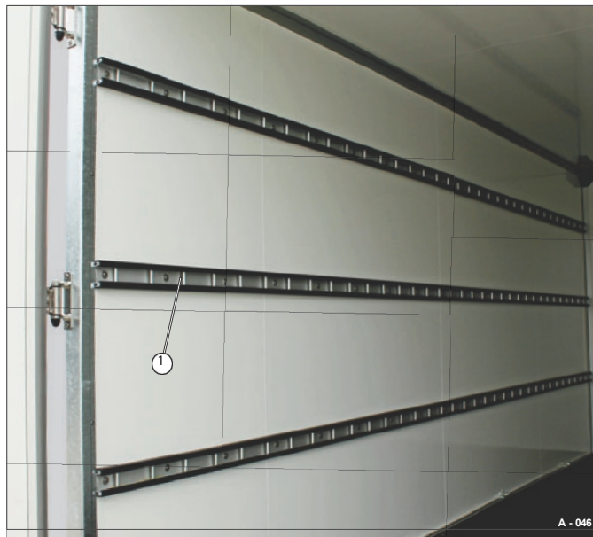
Fig. 46 Exemplo: Calha de amarração de barras
