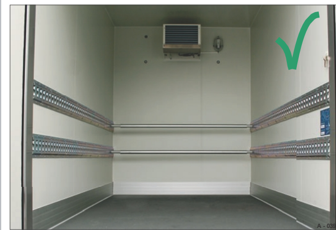
Fig. 39 Barras de bloqueio fixas (posição de deslocação)
