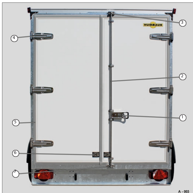
Fig. 3 Porta de portal de duas folhas da parede traseira (fechada em posição de deslocação)
