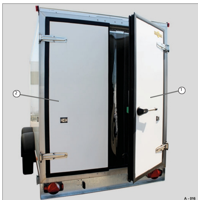
Fig. 16 Portas da câmara frigorífica (destrancadas)
