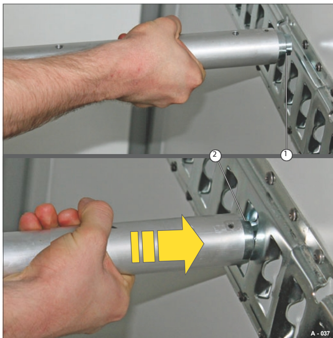
Fig. 37 Fixação da barra de bloqueio
