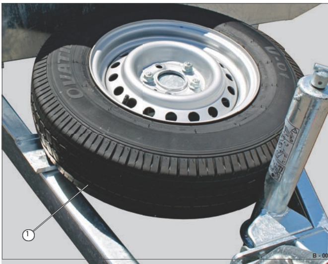
Fig. 5 Exemplo: Roda sobresselente na barra de tração longa
