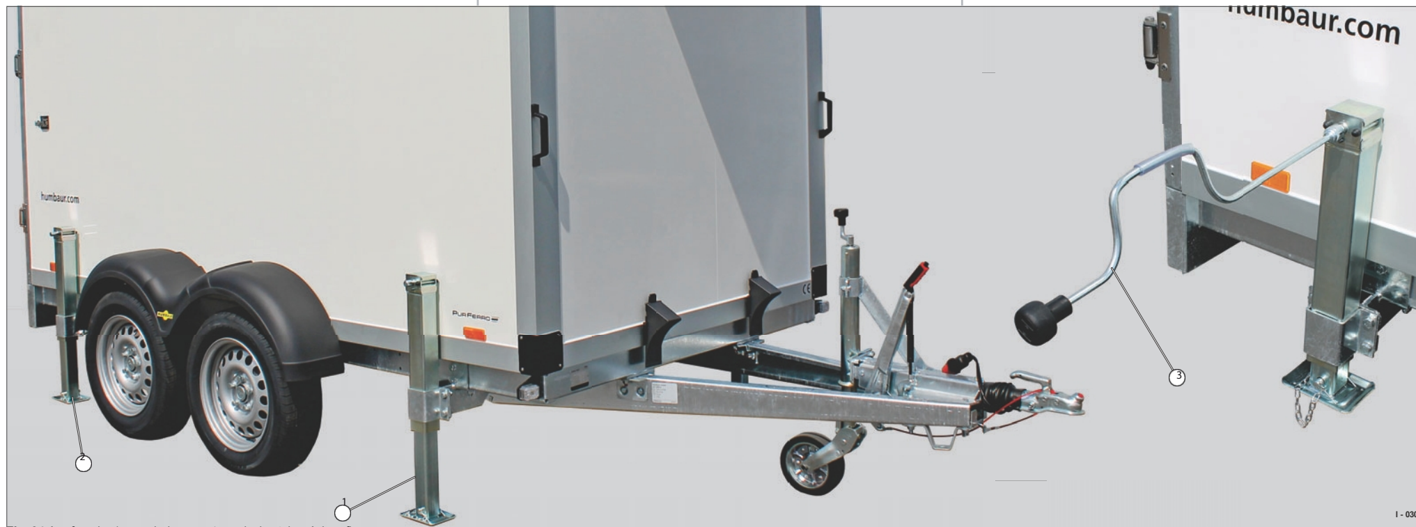
Fig. 34 Arrefecedor / congelador com 4 manivelas telescópicas fixas
