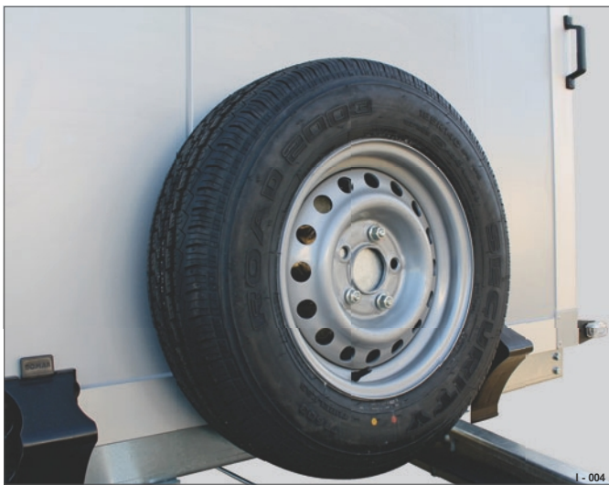
Fig. 4 Exemplo: Roda de reserva na parede frontal
