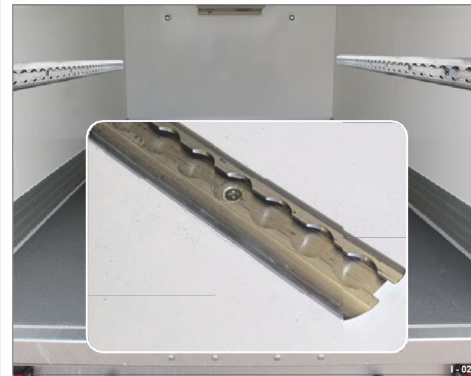
Rys. 26 Przykręcony do ściany warstwowej
