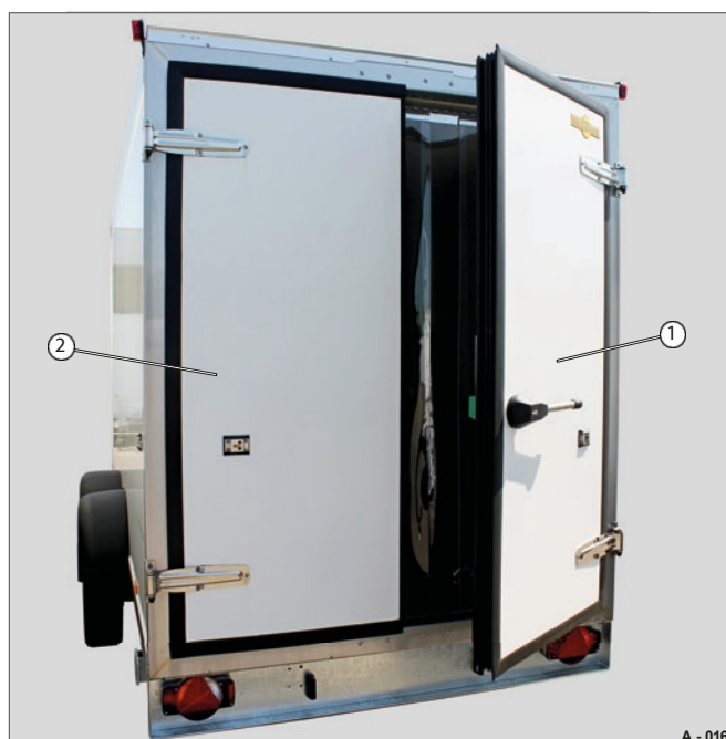
Rys. 16 Drzwi chłodni (odblokowane)
