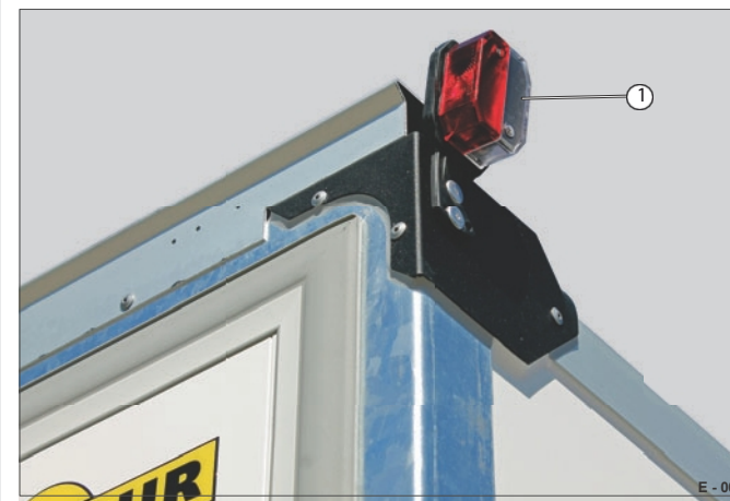
Rys. 4 Światło obrysowe / światło obrysowe (góra)
