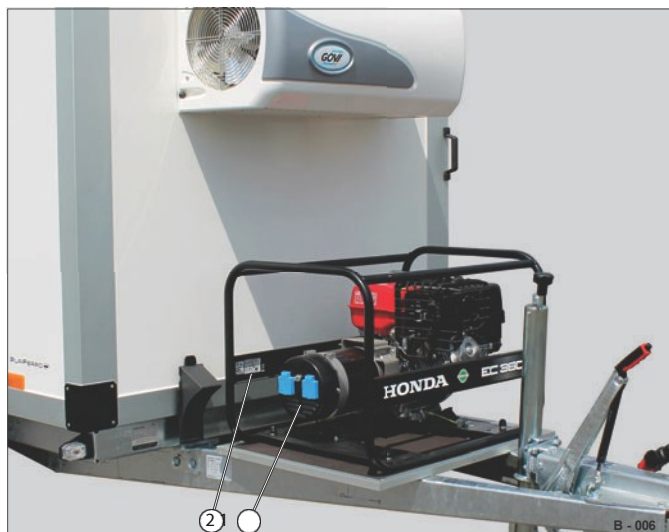
Rys. 7 Agregat prądowy na dyszlu
