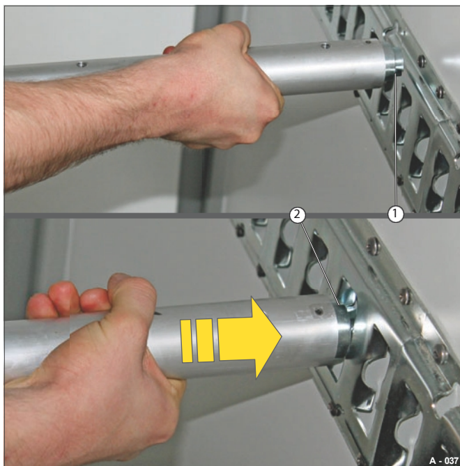
Rys. 37 Zabezpieczanie pręta blokującego
