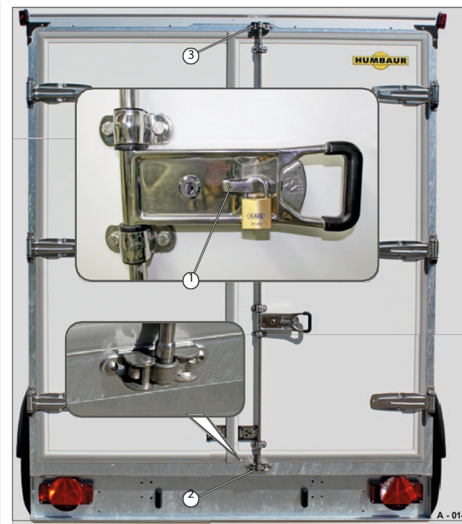
Rys. 14 Zamknięte drzwi portalowe panelu tylnego
