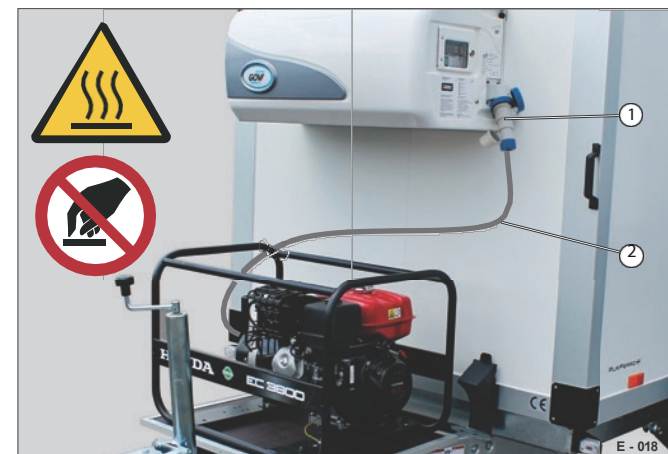
Rys. 19 Podłączony kabel adaptera
