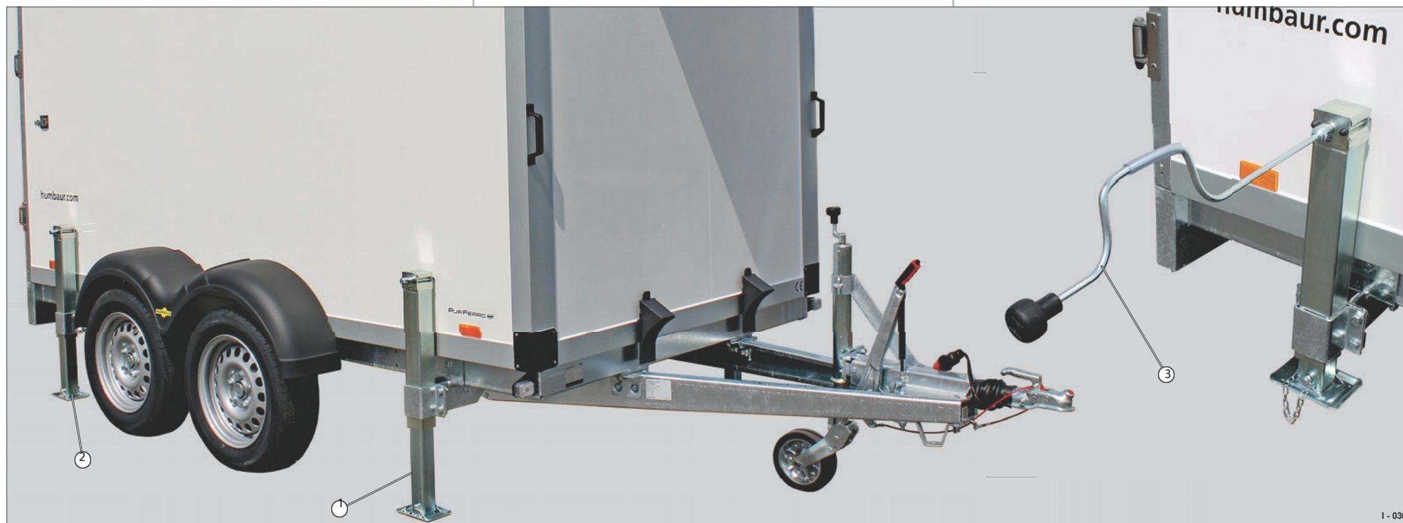
Rys. 34 Chłodziarko-zamrażarka z 4 wytrzymałymi teleskopowymi wspornikami korbowymi
