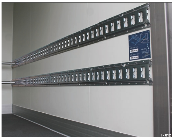
Fig. 22 Skrudd fast på sandwichvegg
