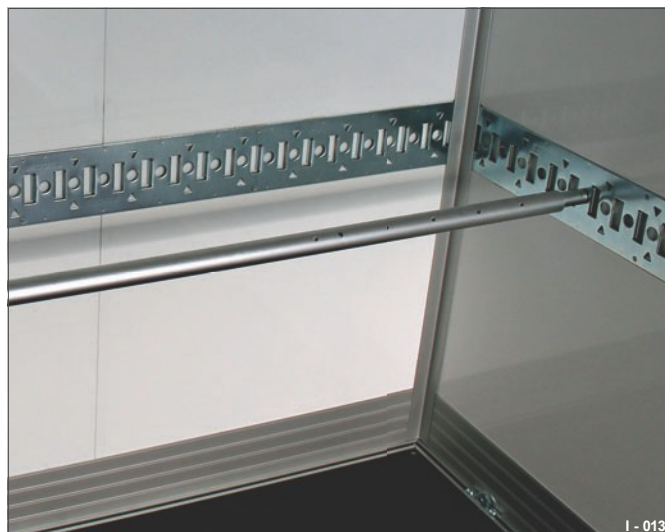
Fig. 23 Forsenket i sandwichveggen
