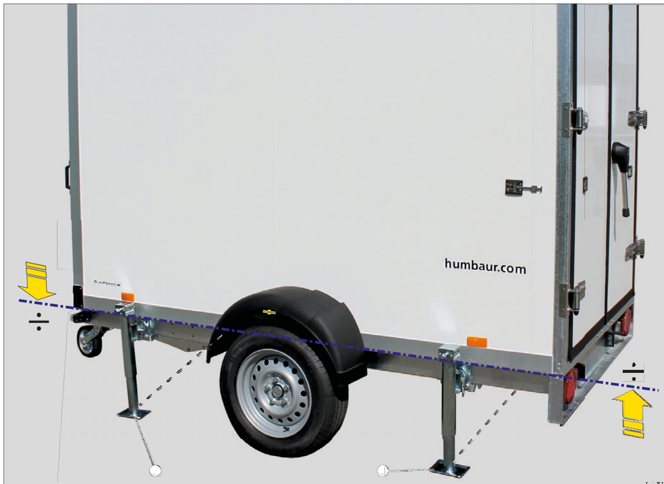
Fig. 10 Kjøleboks 4 - sidestøttet, horisontalt balansert
