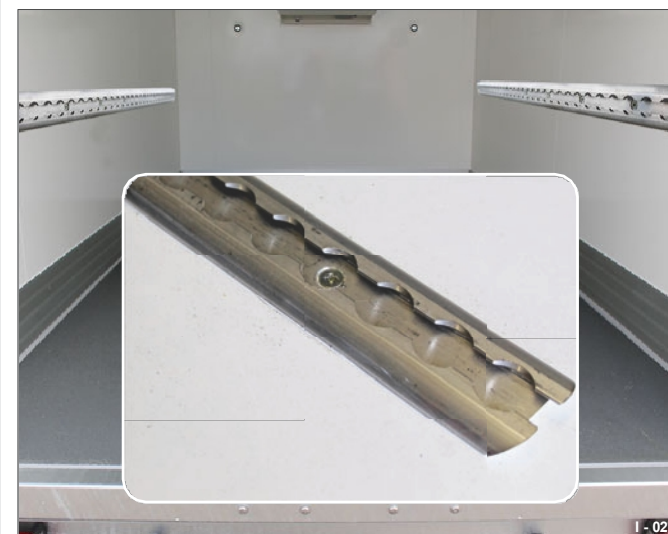
Fig. 26 skrudd på sandwichvegg
