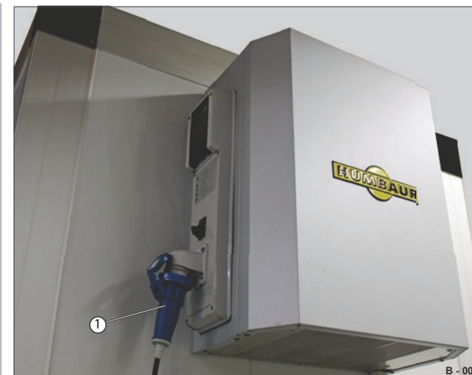
Fig. 3 Kjøleaggregat koblet til 230 V
