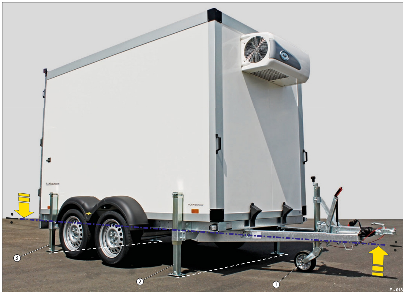
Fig. 17 Kjøleboksskarosseri med støtte på 4 sider, horisontalt nivellert
