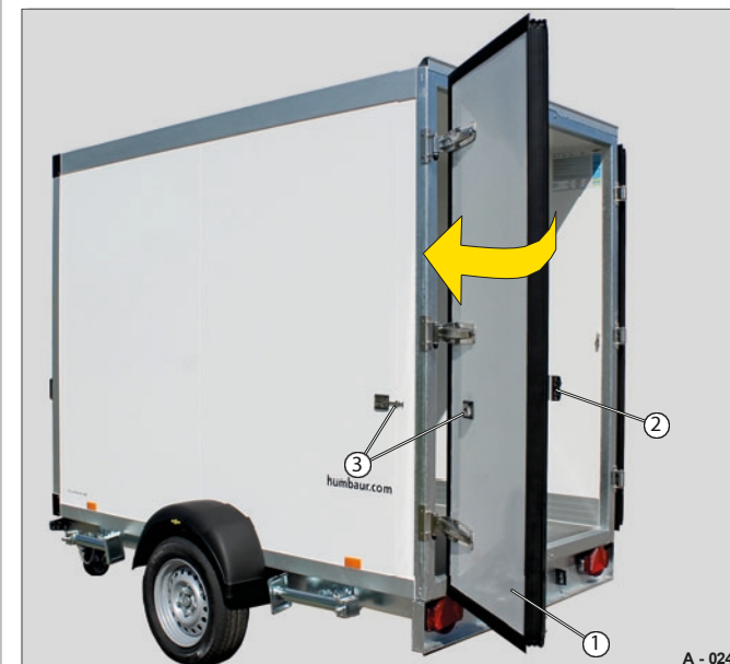
Fig. 24 Åpning av dørbladet
