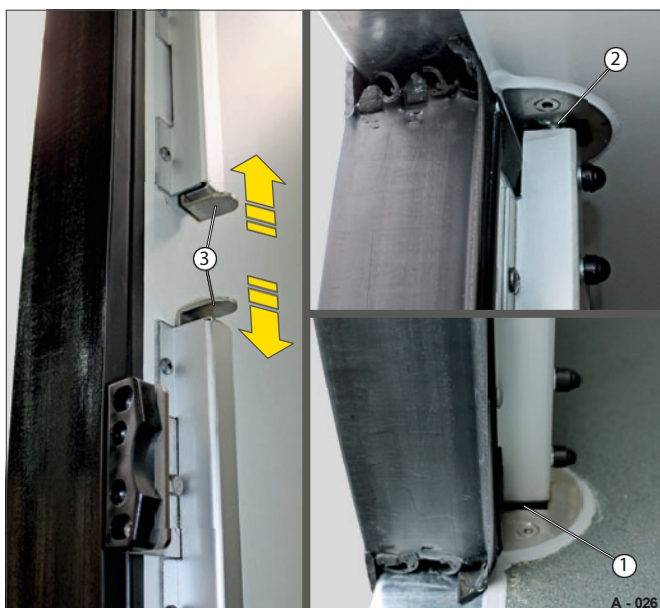
Fig. 26 Låsemekanisme for dørblad låst
