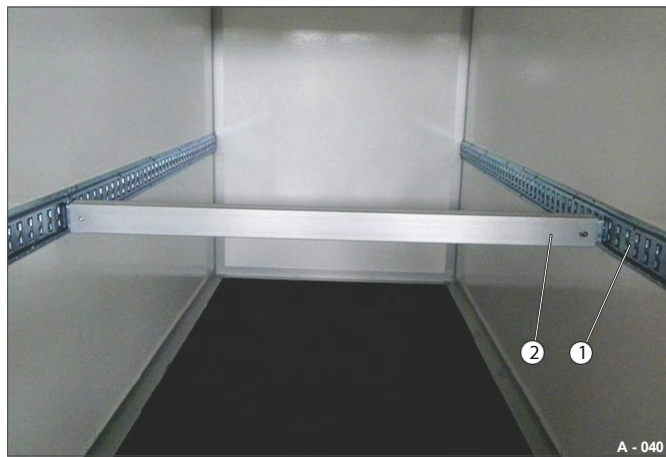
Fig. 40 Eksempel: Teleskopisk låsebjelke (kjørestilling)
