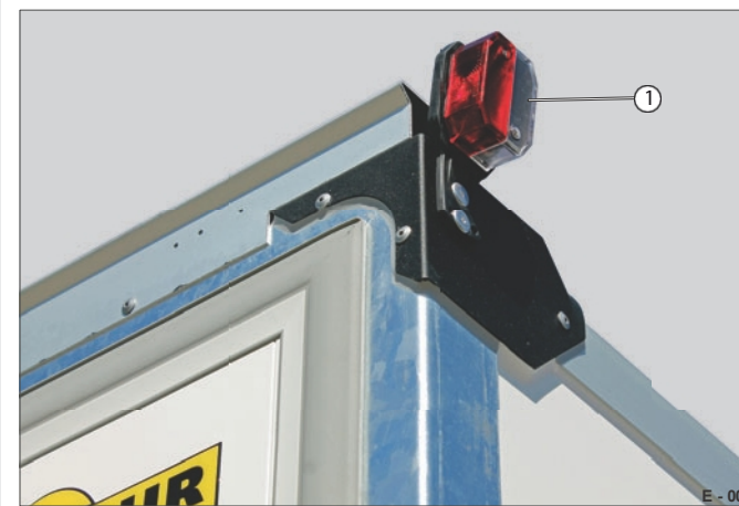
Fig. 4 Klargjørings-/markeringslys (øverst) 1 Klargjørings-/markeringslys (rød/hvit)
