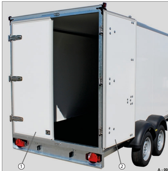
Fig. 4 Portaldør i bakvegg (1 fløy åpen)
