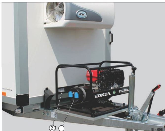
Fig. 7 Strømgenerator på trekkstang
