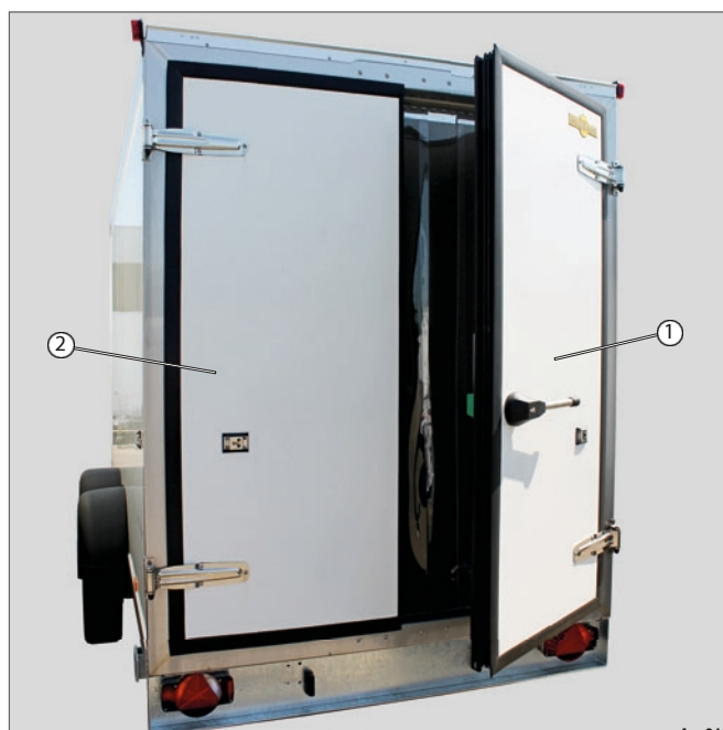
Fig. 16 Dører til kjølerom (ulåst)
