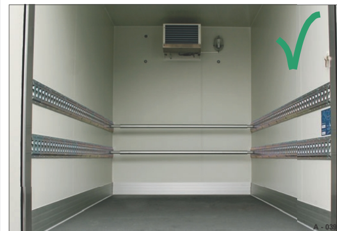
Fig. 39 Låsestangene er sikret (kjørestilling)
