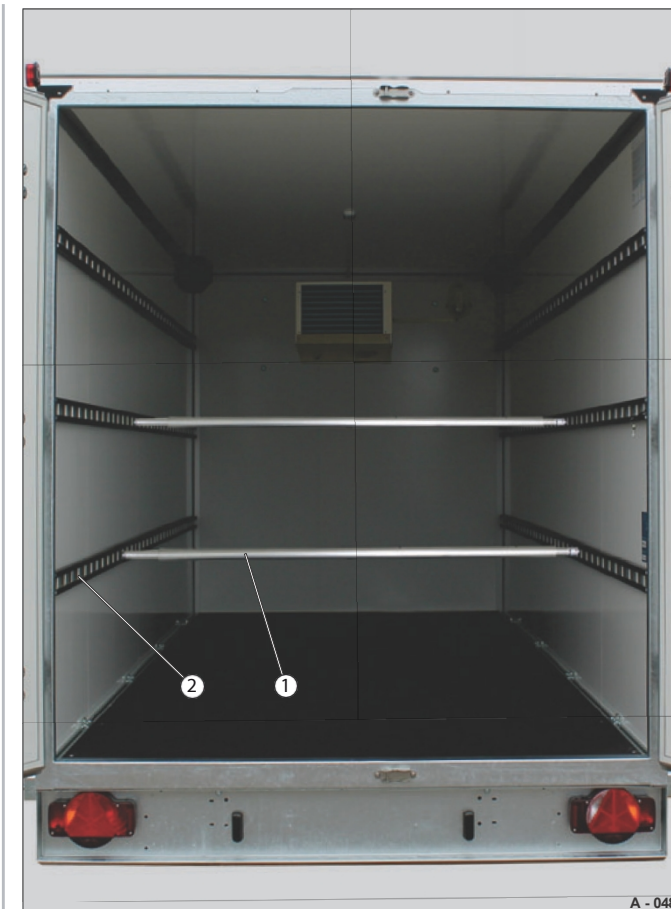
Fig. 48 Låsebommene er sikret (kjørestilling)
