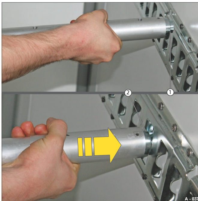
Fig. 37 Sikring av låsestangen
