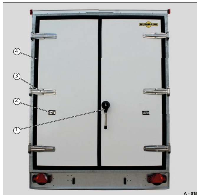
Fig. 15 Dører til kjølerom med to fløyer (lukket)
