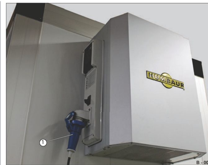
3 pav. Aušinimo įrenginys, prijungtas prie 230 V įtampos
