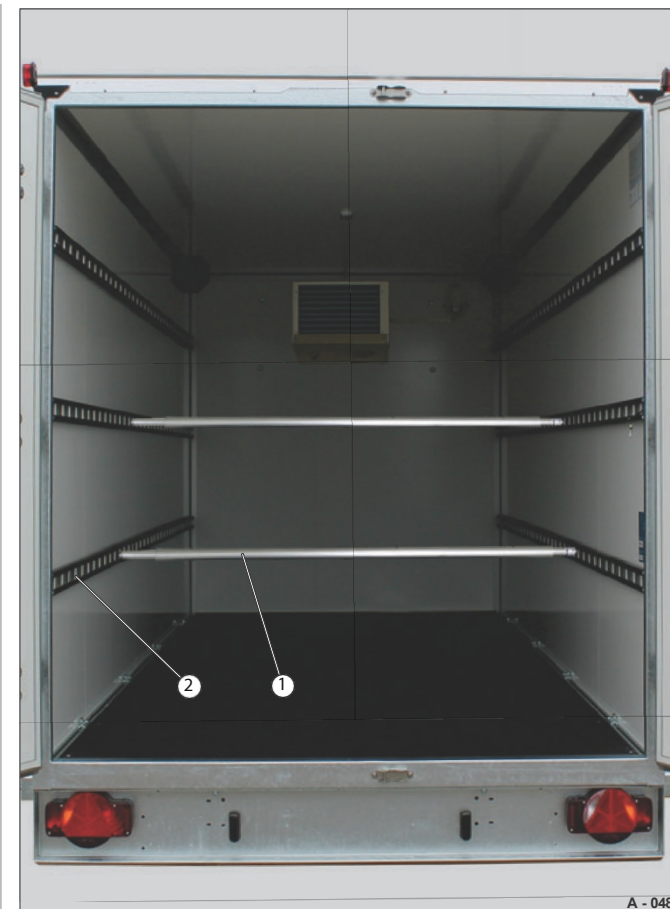
48 pav. 48 Užfiksuoti fiksavimo strypai (važiavimo padėtis)
