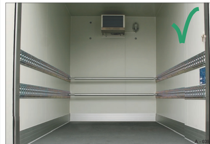
39 pav. 39 Užfiksuoti fiksavimo strypai (važiavimo padėtis)
