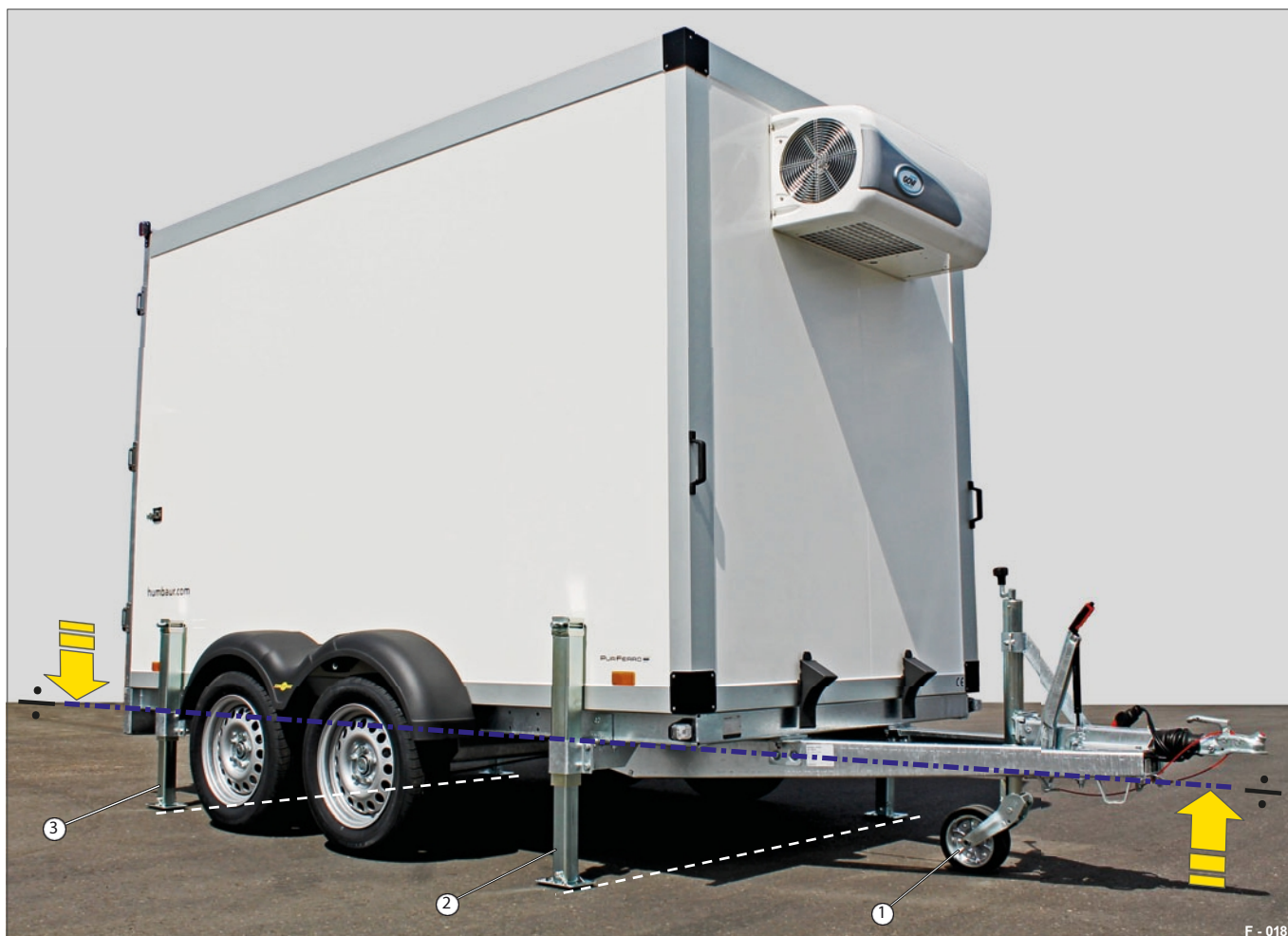
17 pav. 17 Šaldymo dėžė, paremta iš 4 pusių, horizontaliai subalansuota
