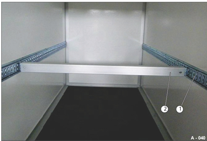
40 pav. 40 pavyzdys: teleskopinė fiksavimo sija (važiavimo padėtis)
