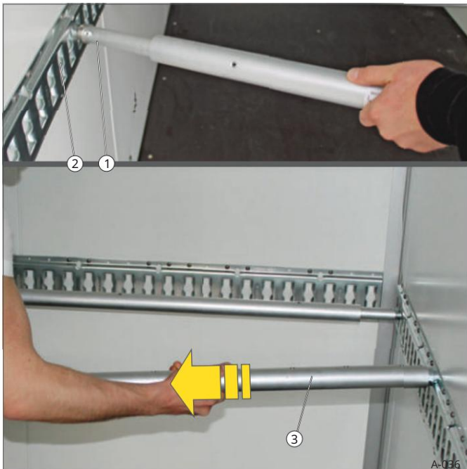
Sl. 36 Postavljanje zaporne šipke
