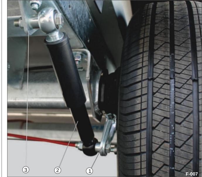
Mynd 6 Hjóldeyfir settur upp
