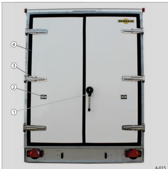
Sl. 15 Dvokrilna vrata hladnjače (zatvorena)
