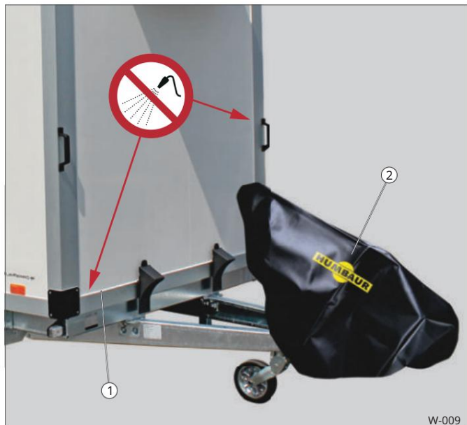
Sl. 18 Čišćenje PurFerro sendvič panela
