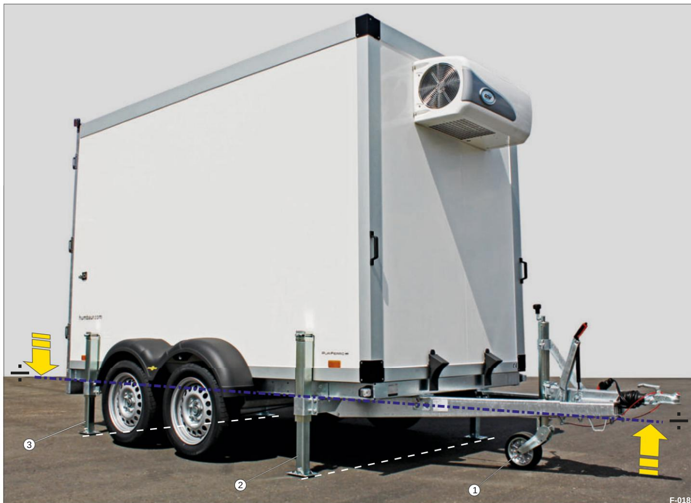
Mynd 17 Kælikassi 4 - studdur á 4 hliðum, lárétt jafnvægi
