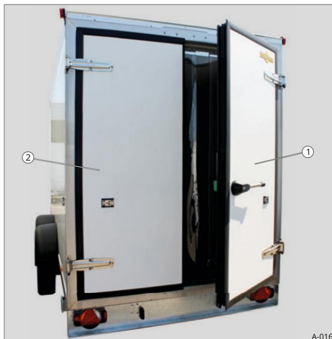
Sl. 16 Vrata hladne komore (otključana)
