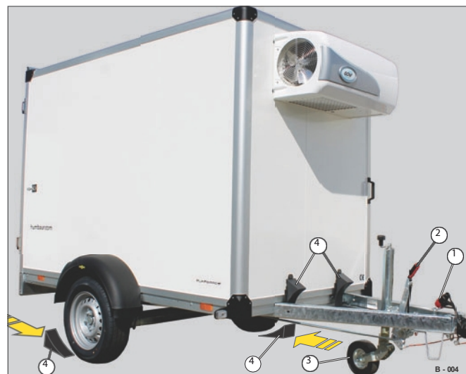
2. ábra A dobozos pótkocsi rögzítve
