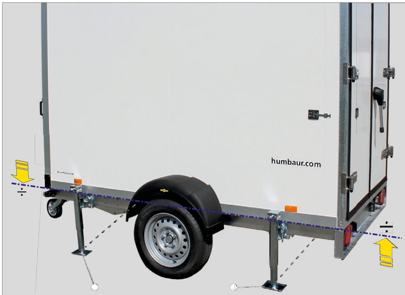
10. ábra 4 oldalról alátámasztott, vízszintesen kiegyensúlyozott hűtőláda
