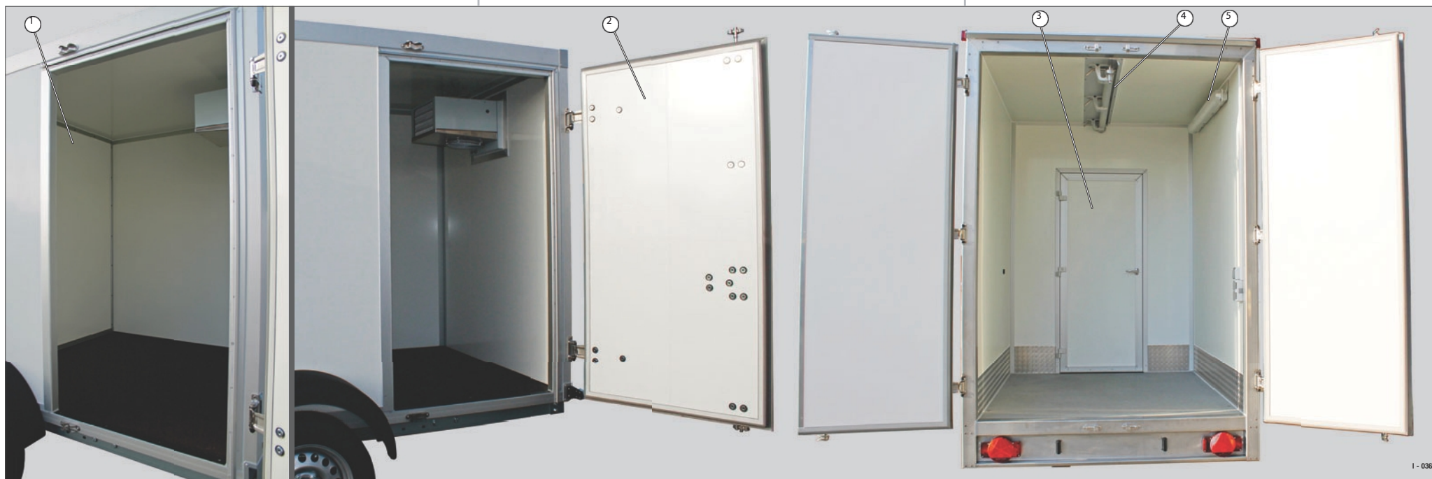
58. ábra Tandem hűtőláda válaszfallal
