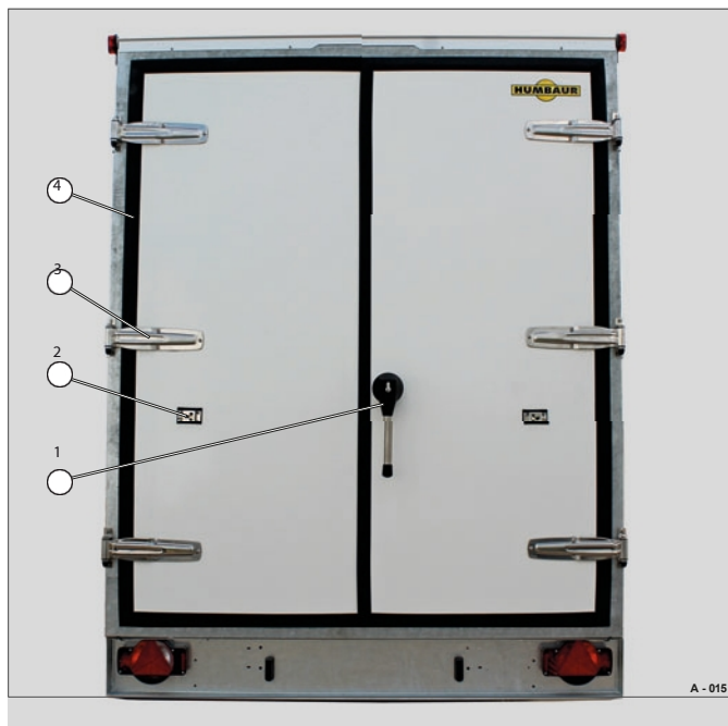
15. ábra Kétszárnyú hűtőkamra ajtók (zárván)
