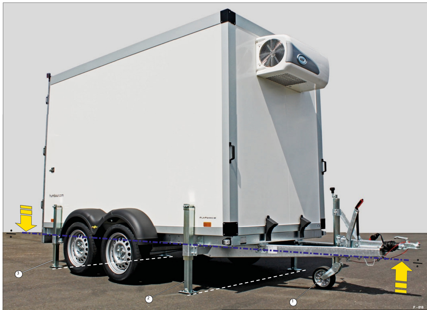
17. ábra 4 oldalról alátámasztott, vízszintesen kiegyensúlyozott hűtőláda
