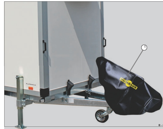
6. ábra Felülfutó vonószerkezet / lefedett tengelykapcsoló
