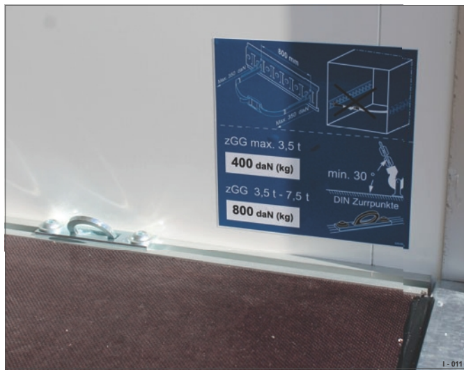
21. ábra 4 darab oldalanként a padlósínbe integrálva
