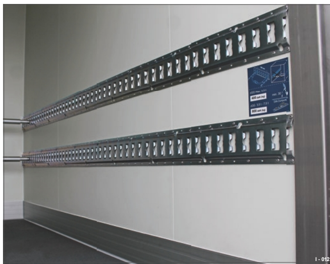
22. ábra Szendvicsfalra csavarozva
