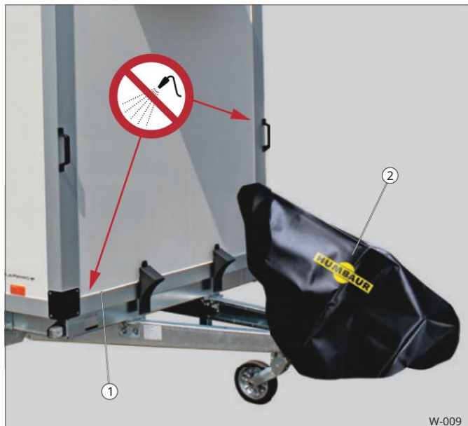
Sl. 18 Čišćenje PurFerro sendvič panela
