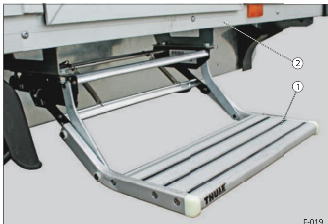
Sl. 18 Izvučena stepenica 1 Izvučena stepenica 2 Konstrukcija
