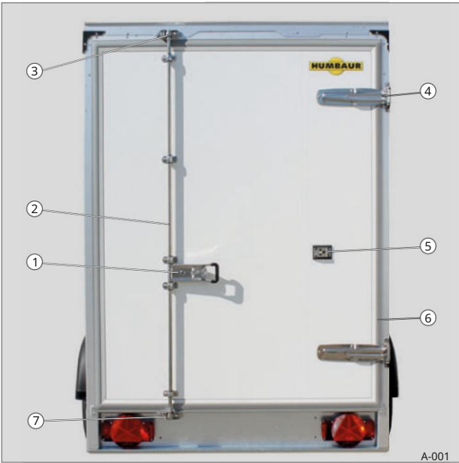
Sl. 1 Jednokrilna portalna vrata na stražnjoj stijenci (zatvoreno u položaju za vožnju)
