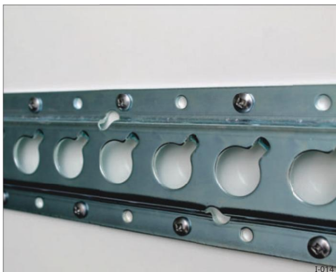
Sl. 24 pričvršćeno vijcima na sendvič zid
