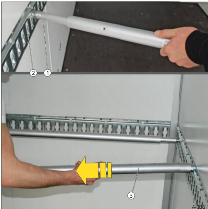
Sl. 36 Postavljanje zaporne šipke
