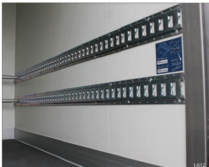
Sl. 22 pričvršćeno vijcima na sendvič zid
