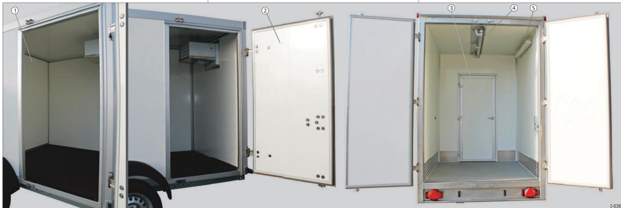
Sl. 38 Tandem rashladni sanduk s pregradnom stijenkom
