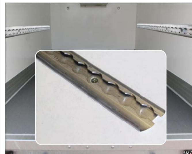
Sl. 26 pričvršćeno vijcima na sendvič zid
