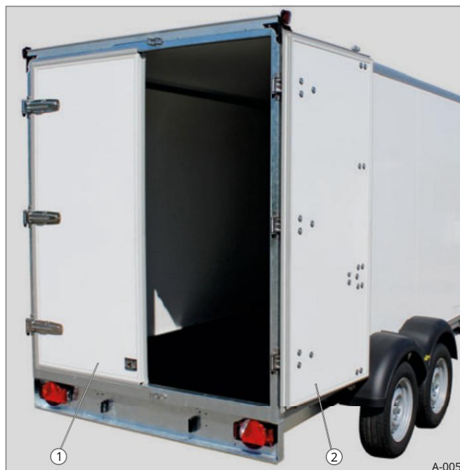
Sl. 4 Stražnja zidna portalna vrata (1 krilo otvoreno)
