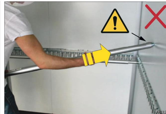
Sl. 32 Opasnost od oštećenja unutarnje stijenke
