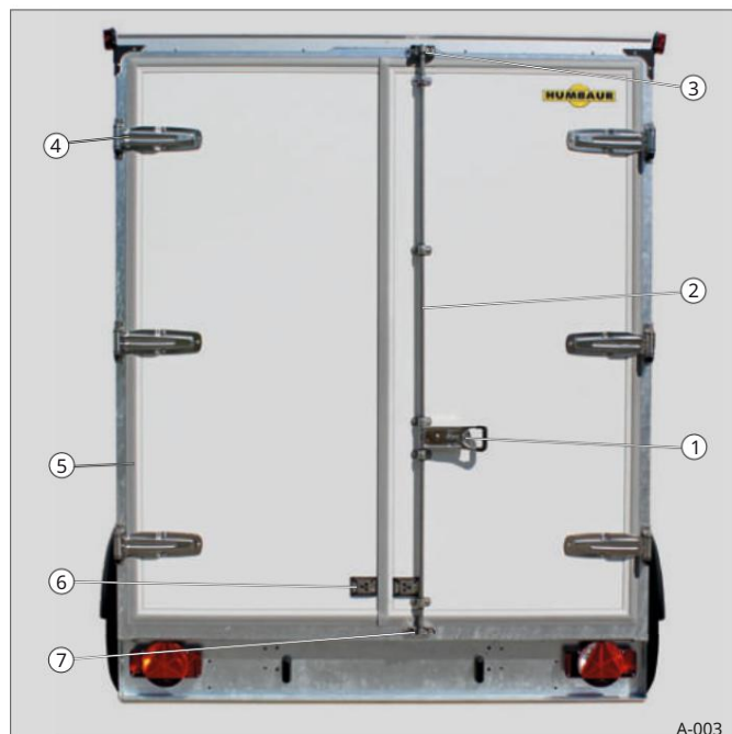
Sl. 3 Dvokrilna portalna vrata na stražnjoj stijenci (zatvorena u položaju za vožnju)
