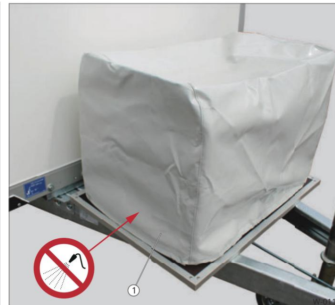
Sl. 20 Čišćenje generatora
