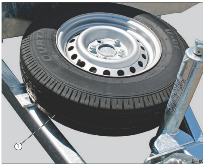
Fig. 5 Eksempel: Reservehjul på den lange trækstang
