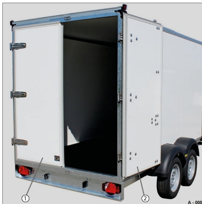
Fig. 4 Portaldør til bagpanel (1 panel åbent)
