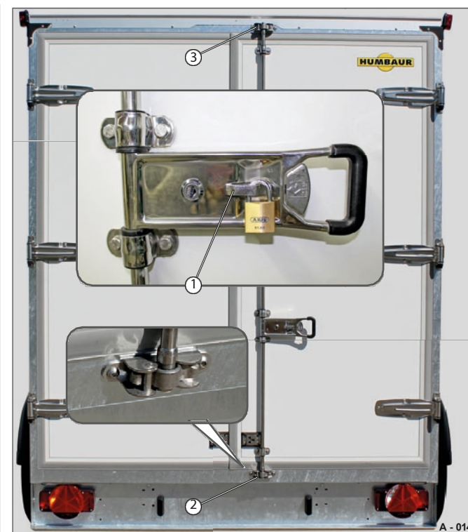
Obr. 14 Zavřené portálové dveře zadního panelu
