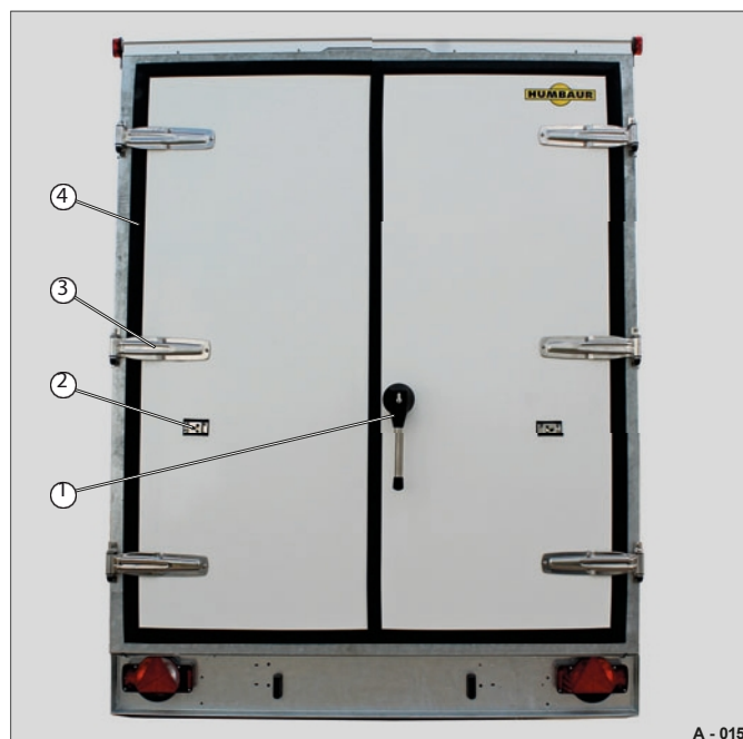
Obr. 15 Dvoukřídlé dveře chladírny (zavřené)
