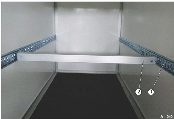
Obr. 40 Příklad: Teleskopický zajišťovací nosník (pojízdňá poloha)
