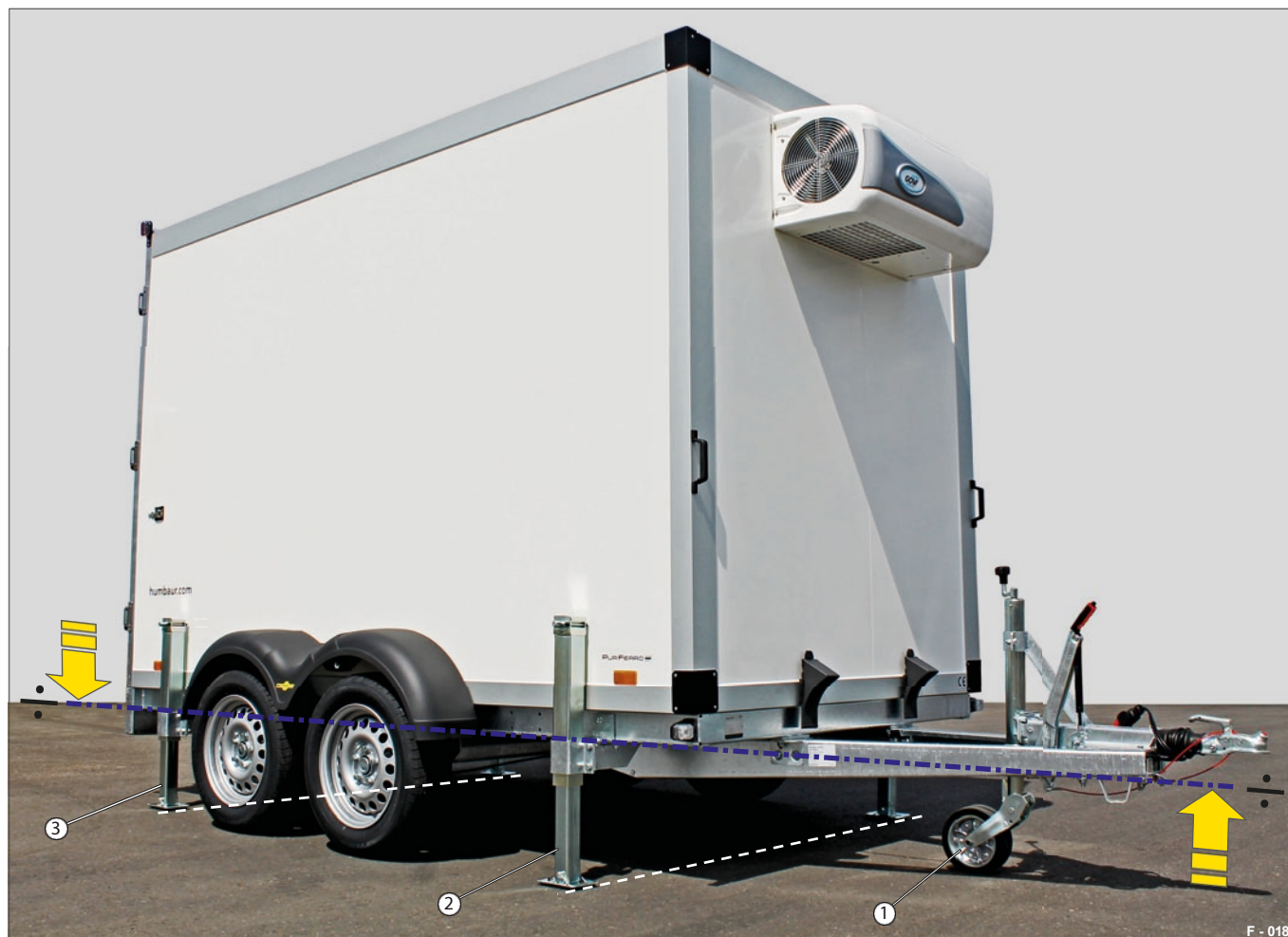
Obr. 17 Chladicí skříň podepřená ze 4 stran, horizontálně vyvážená
