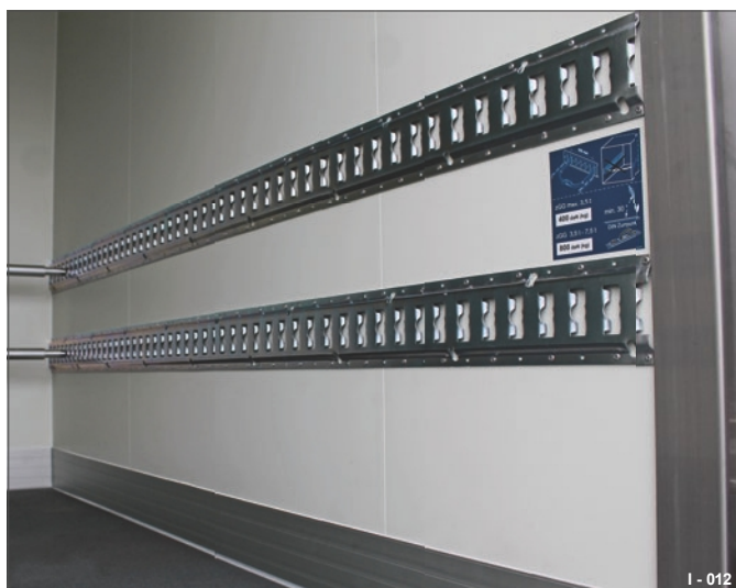
Obr. 22 Přišroubování na sendvičovou stěnu
