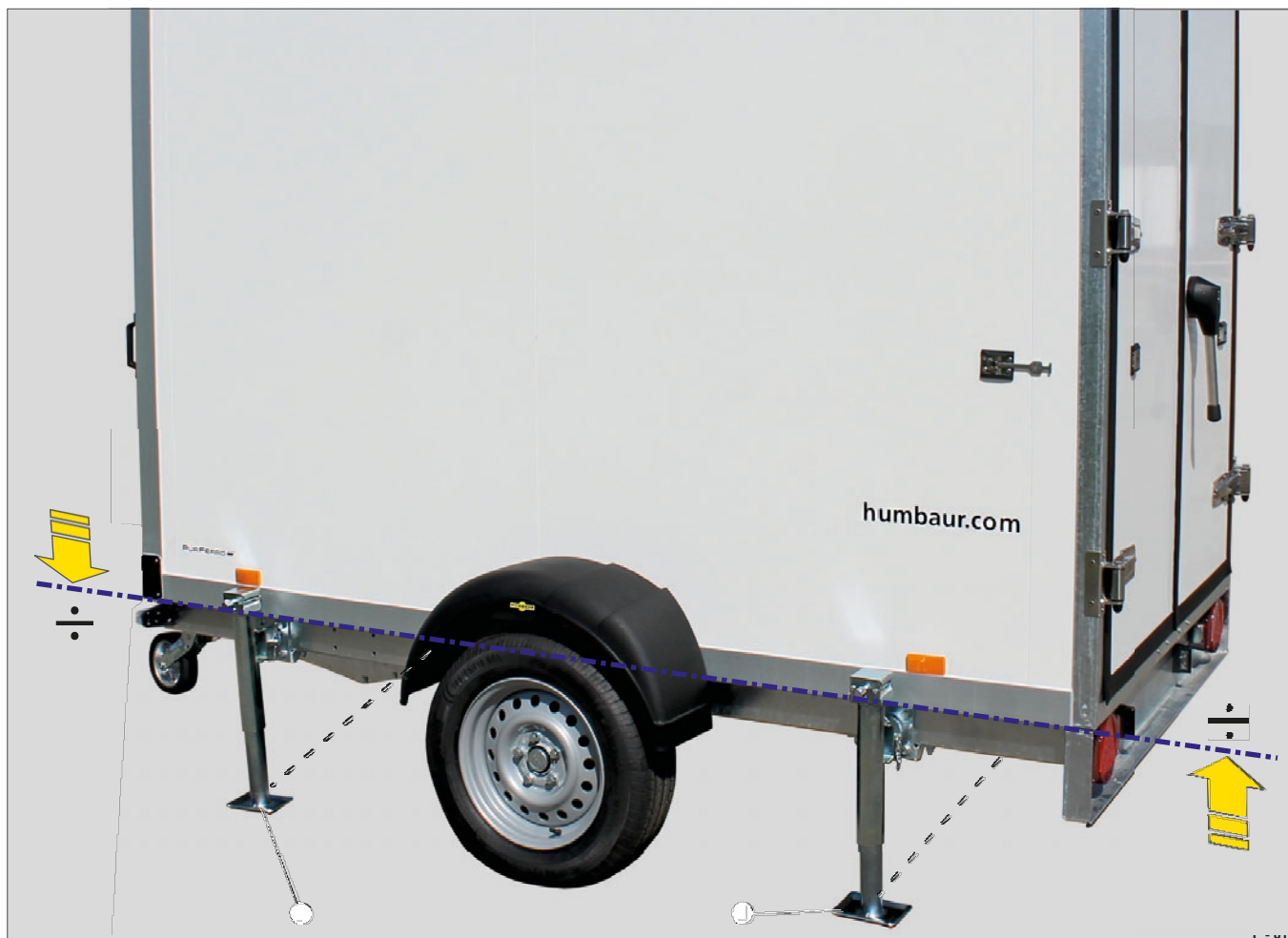
Obr. 10 Chladicí skříň podepřená ze 4 stran, horizontálně vyvážená
