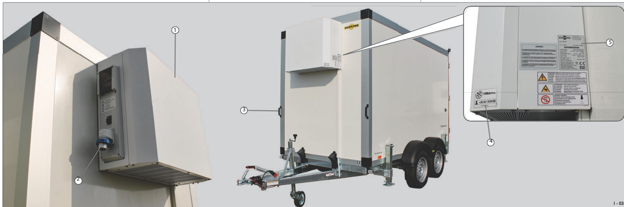
Obr. 37 Tandemová chladicí skříň s jednotkou Humbaur
