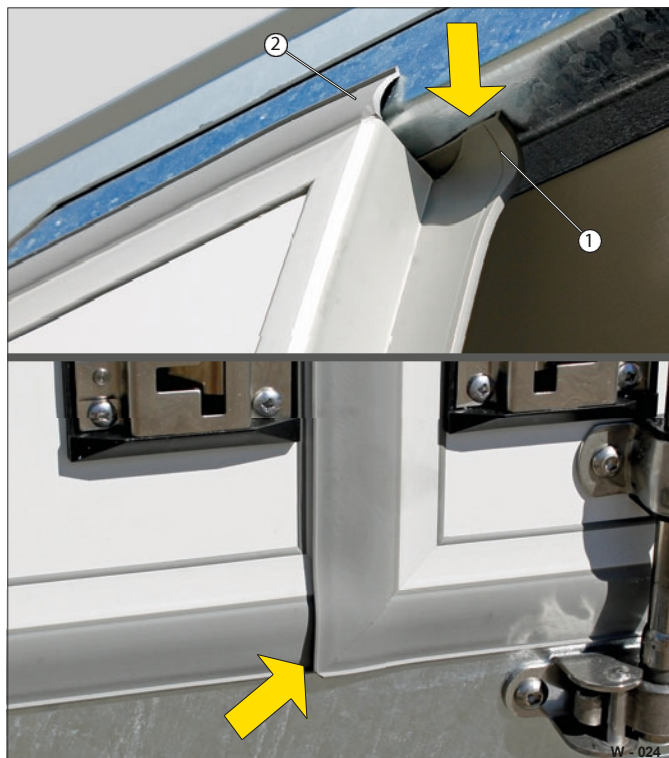
Obr. 10 Těsnění dveří, dvojitě (Cool Trailer Basic)
