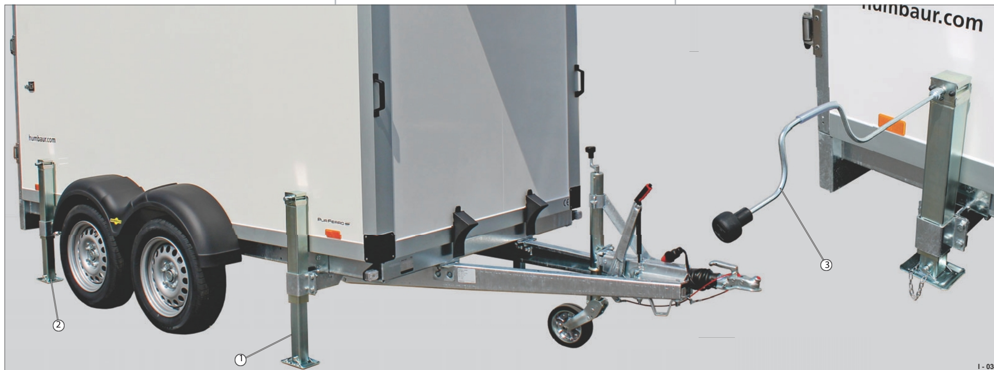
Obr. 34 Chladnička / mraznička se 4 robustními teleskopickými podpěrami na klíky
