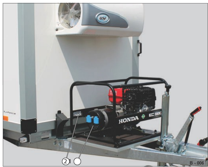
Obr. 7 Generátor energie na oji
