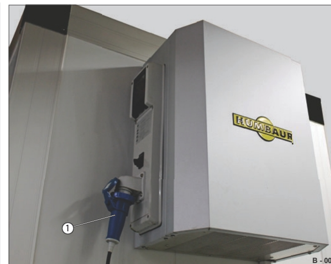
Obr. 3 Chladicí jednotka připojená na 230 V
