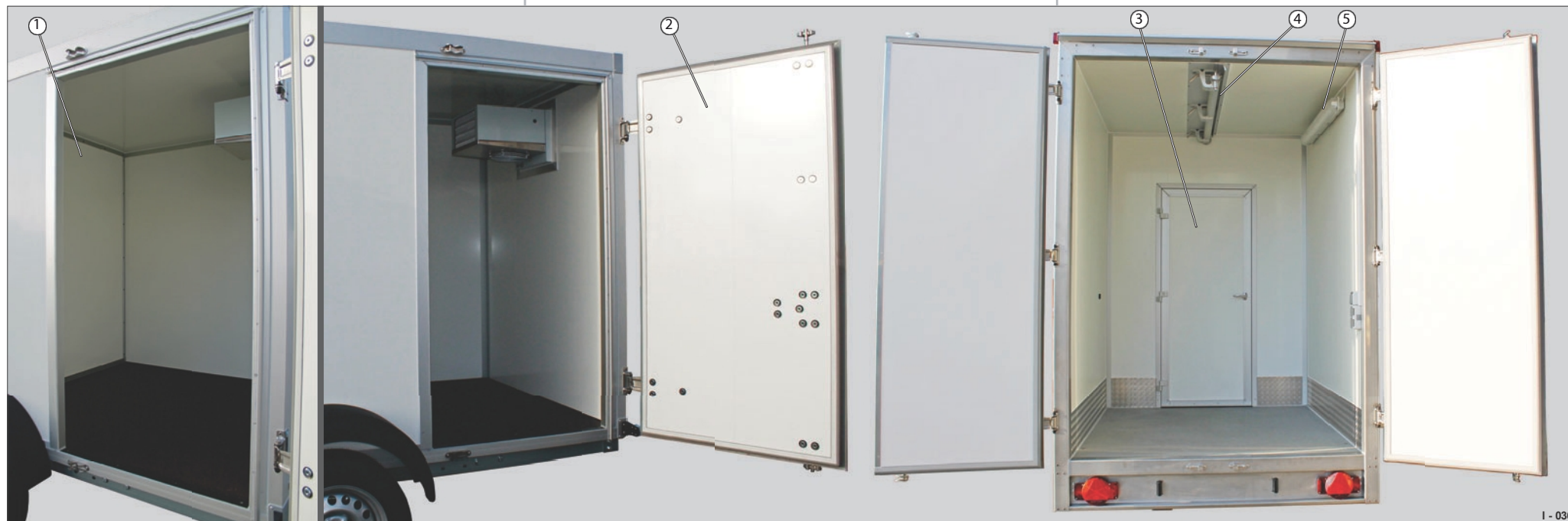
Obr. 38 Tandemový chladicí box s dělicí stěnou
