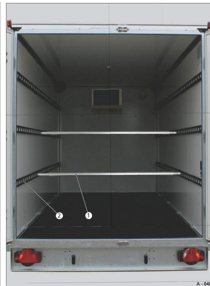
Obr. 48 Zajišťovací tyče zajištěné (pojízdna poloha)
