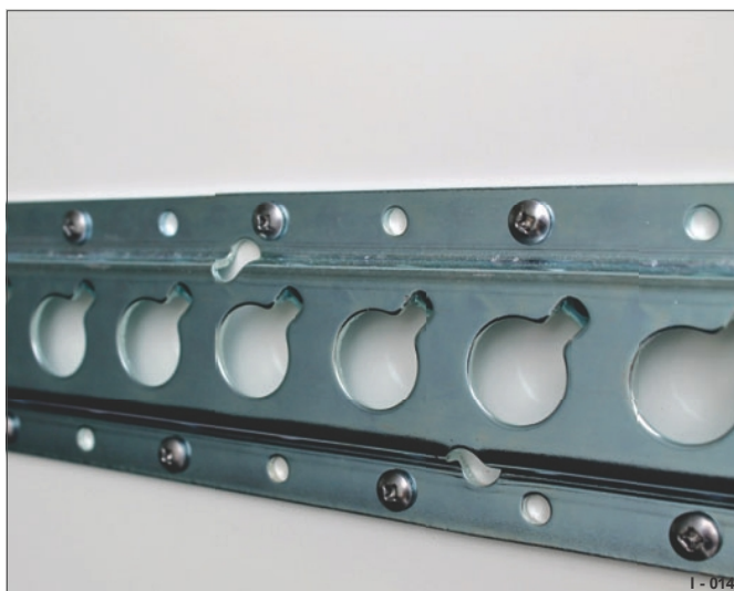
Obr. 24 Přišroubování na sendvičovou stěnu
