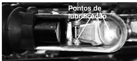
Pontos de lubrificação do acoplamento de cabeça esférica
