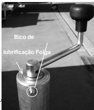
Utilizar uma massa lubrificante multiusos disponível no mercado para a lubrificação. Lubrificar a roda de apoio com uma pistola de lubrificação através dos bicos de lubrificação (imagem: *Lubrificação da roda de apoio*). Se não existir um bocal de lubrificação na sua versão da roda de apoio, deite óleo de máquina disponível no mercado na abertura (imagem: *Lubrificação da roda de apoio*). Limpe o excesso de óleo com um pano, para que não entre em contacto com o ambiente.
