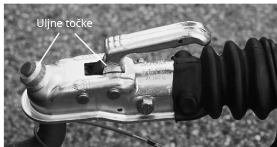
Mjesta za ulje na kuglastoj spojnici
