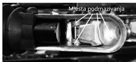
Mjesta podmazivanja kuglaste spojke
