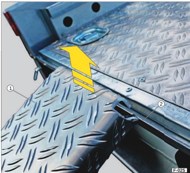
Mynd 33 Hleðslurampi fjarlægður
