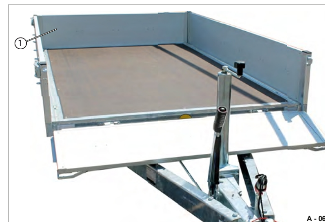
Slika 13 Zaprta zadnja stranica za spust
