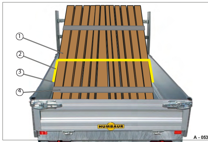
Slika 60 Pritrdjevanje bremena s H-okvirjem
