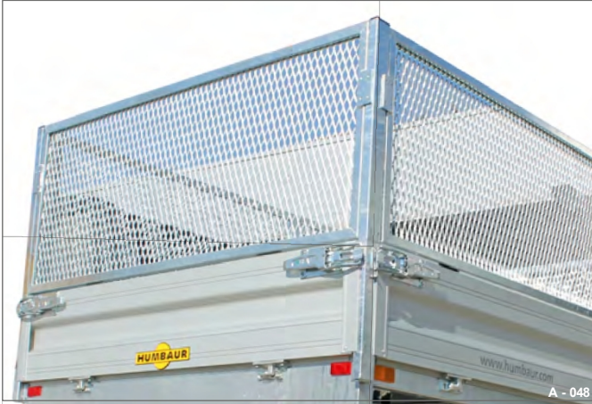
Slika 38 Pritrditev jeklene rešetke Potovalni položaj
