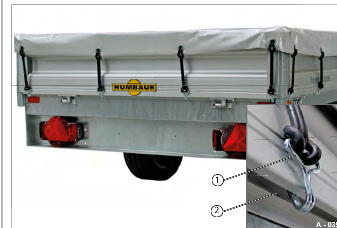
Slika 51 Pritrjena ravna ponjava (s padajočo stranjo podlago)
