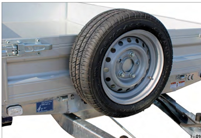
Slika 13 Rezervno kolo / nosilec na sprednji stranici
