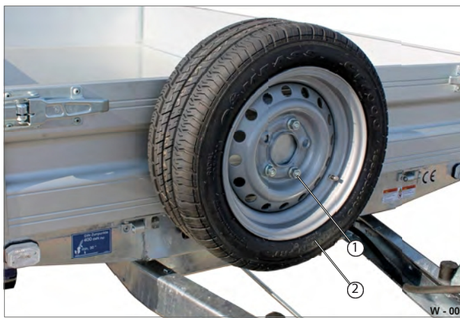
Slika 4 Preverjanje nosilca rezervnega kolesa
