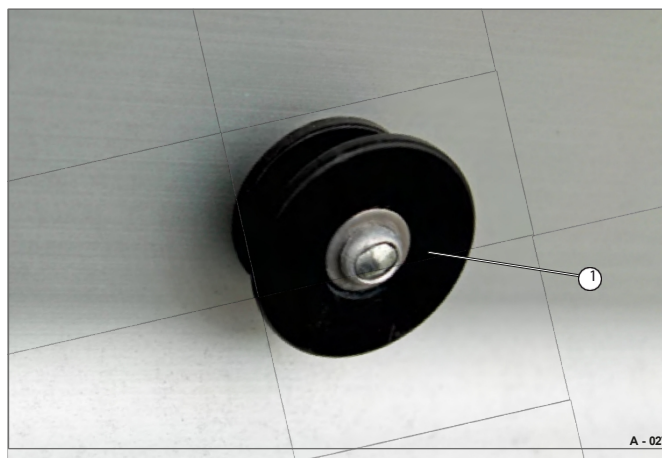
Fig. 42 Fästelement för täcknät
