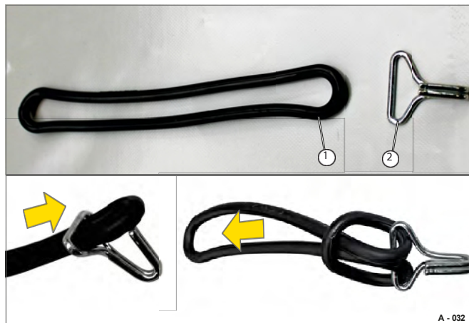
Fig. 47 Förberedelse av spännkabeln med krok
