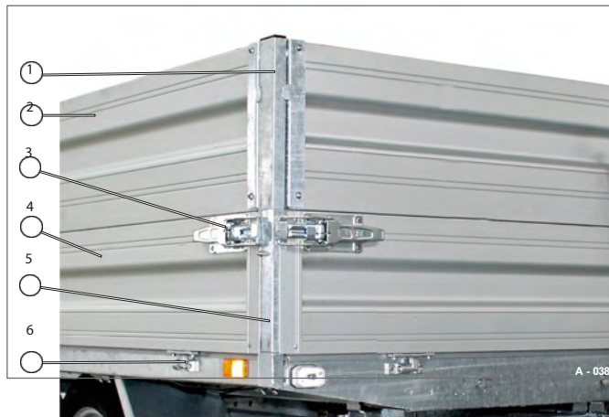
Fig. 29 Förlängning på gavel monterad
