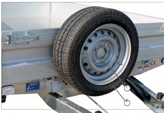
Fig. 4 Kontroll av reservhjulshållaren
