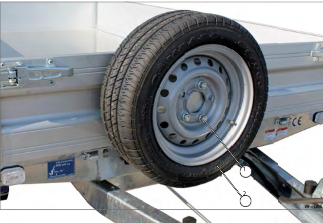
Fig. 4 Verificação do suporte da roda sobresselente
