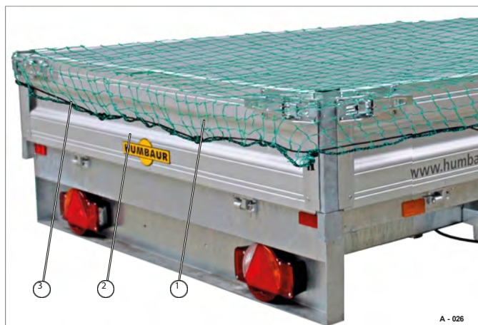
Fig. 41 Rede de cobertura, montada
