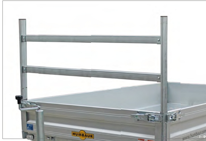
Fig. 12 Fixação do lado da queda frontal em escoras de canto
