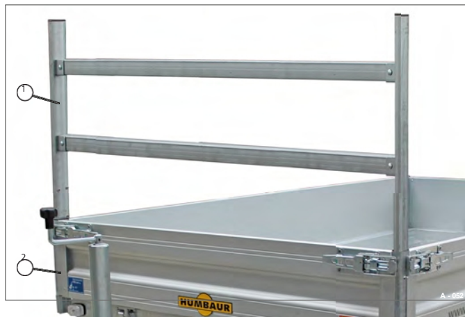
Fig. 59 Estrutura em H montada
