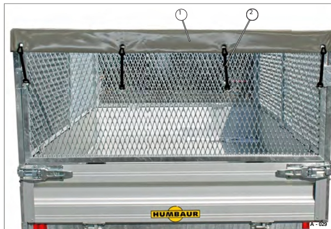
Fig. 44 Exemplo: Lona plana com fixação de grelha de aço
