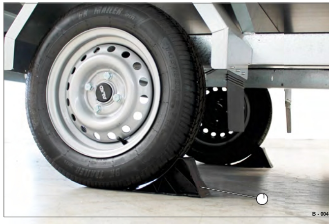
Fig. 9 Calços colocados por baixo
