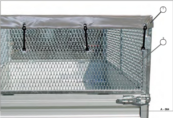
Fig. 54 Encerado plano (com fixação de grelha de aço)
