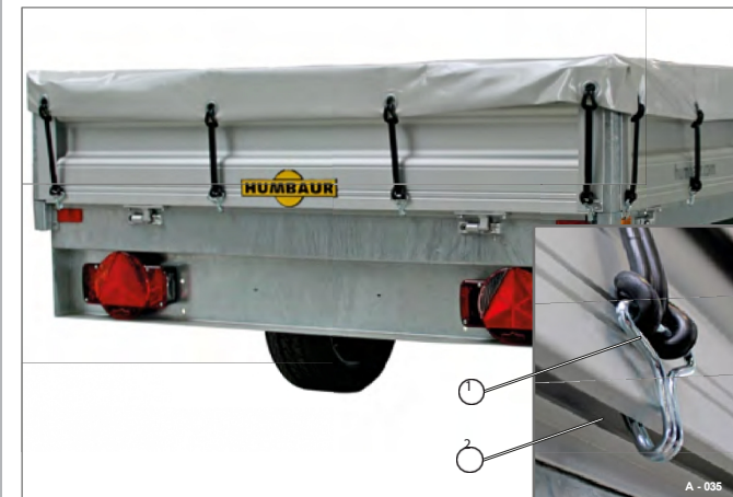
Fig. 51 Lona plana fixada (com o lado da base caldo)
