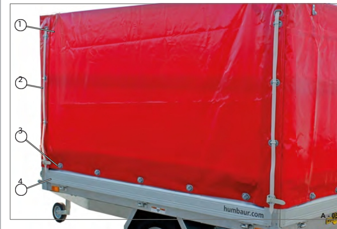
Rys. 58 Zabezpieczona plandeka wysoka (pozycja podróżna)
