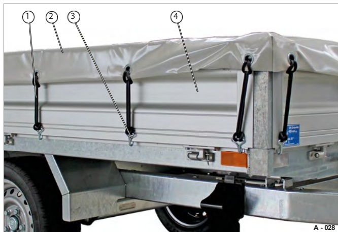
Rys. 43 Przykład: Płaska plandeka na burtę podstawy
