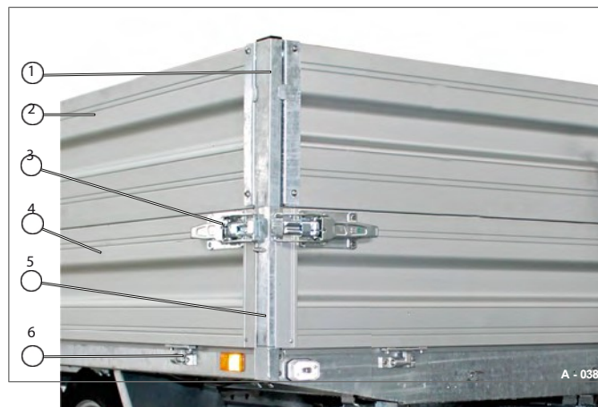
Rys. 29 Zamontowane przedłużenie burty
