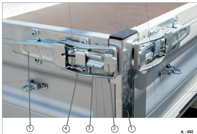
Rys. 3 Blokada naciągu, zabezpieczona
