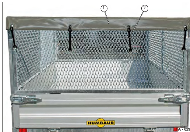
Rys. 44 Przykład: Płaska plandeka z mocowaniem siatki stalowej
