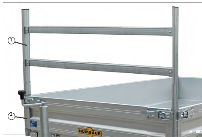
Rys. 59 Zamontowana rama H
