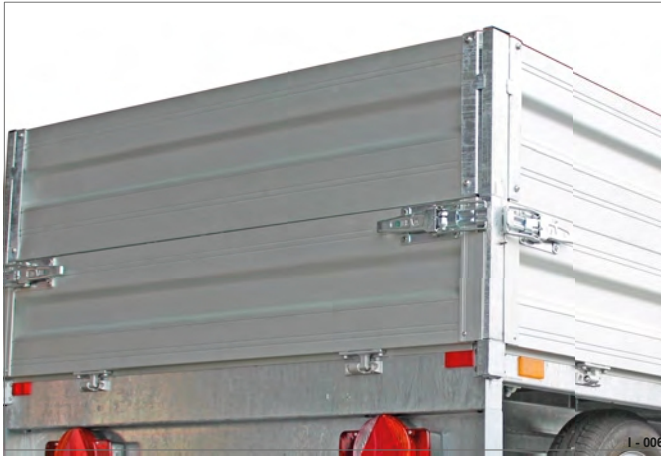
Rys. 6 Zawieszone na klonicach narożnych
