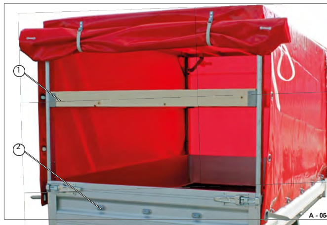
Rys. 56 Wysoka plandeka, otwarta z tyłu
