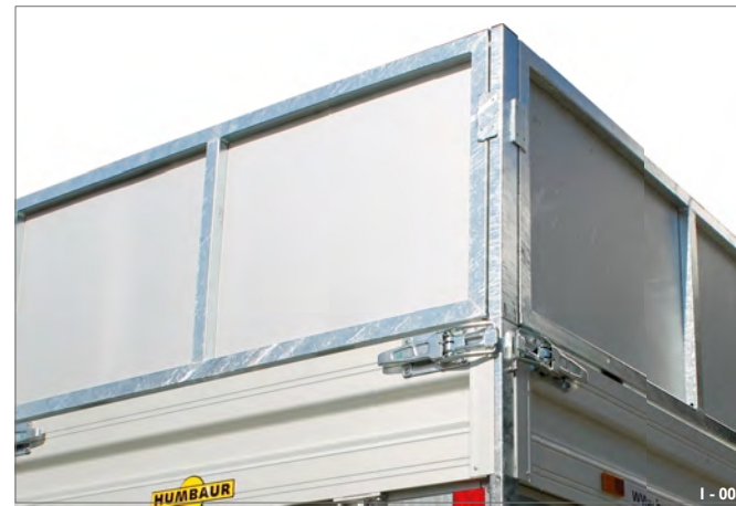
Fig. 8 Opphengt i hjørnestolper
