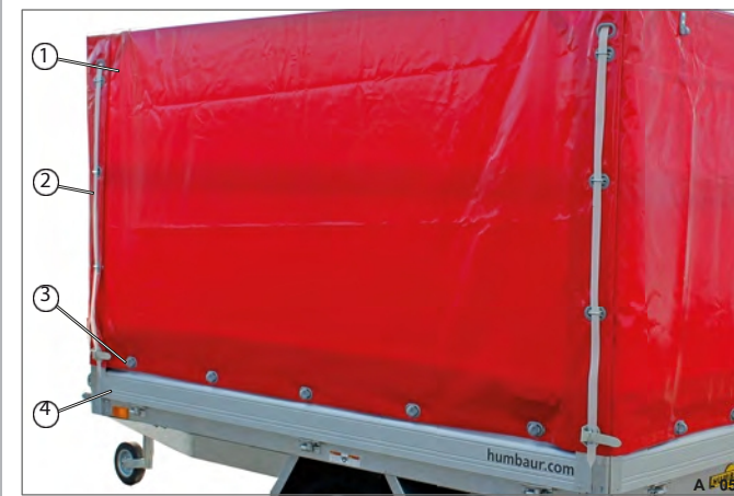
Fig. 58 Presenning, sikret (kjørestilling)
