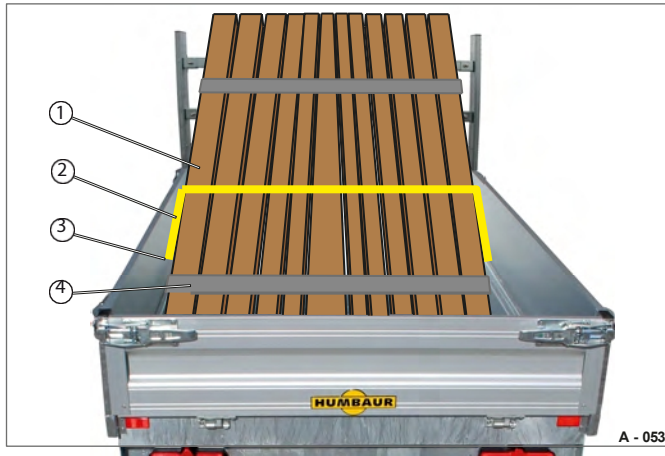
Fig. 60 Lastsikring med H-ramme
