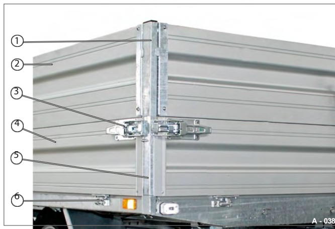
Fig. 29 Forlengelse av gavl montert
