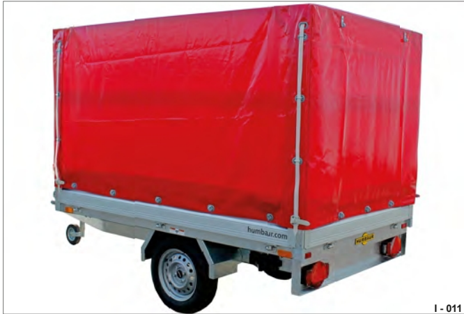
Fig. 10 Høy presenning i høyden 1300 / 1600 mm
