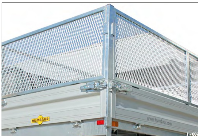
Fig. 7 Opphengt i hjørnestolper
