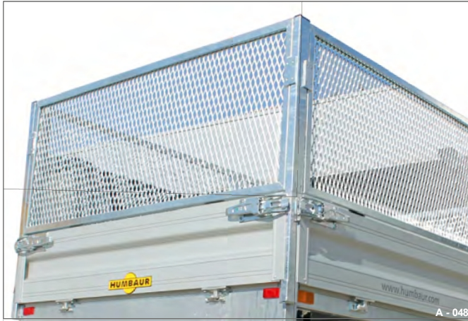
Fig. 38 Kjørestilling for forlengelse av stålgitter
