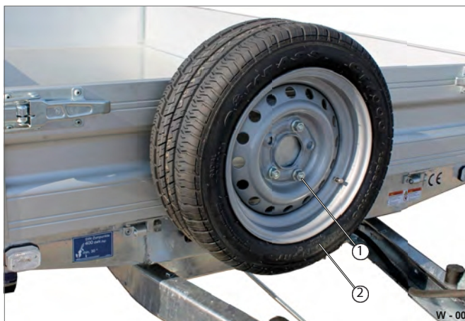
Fig. 4 Kontroll av reservehjulholderen
