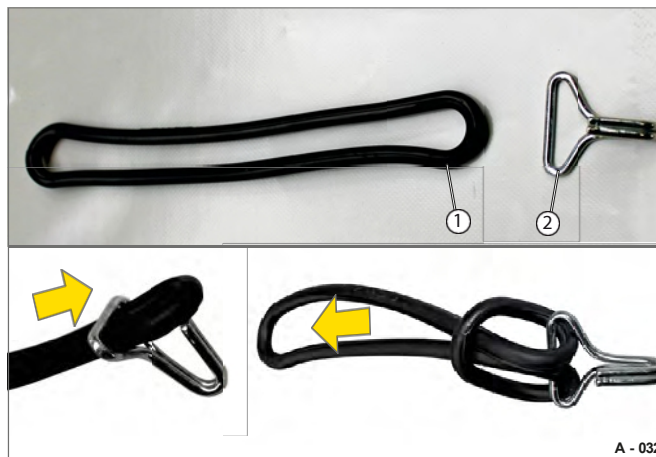
Fig. 47 Klargjøring av strekkvaieren med kroker
