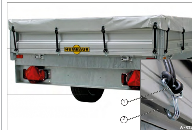
51 pav. 51 pritvirtintas plokščias tentas (su pagrindo nuleistu šonu)
