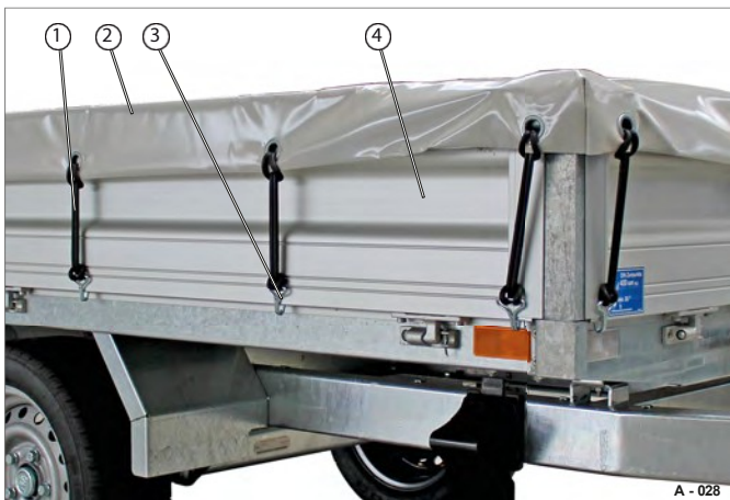
43 pav. 43 pavyzdys: plokščias brezentas, skirtas pagrindo dugnui
