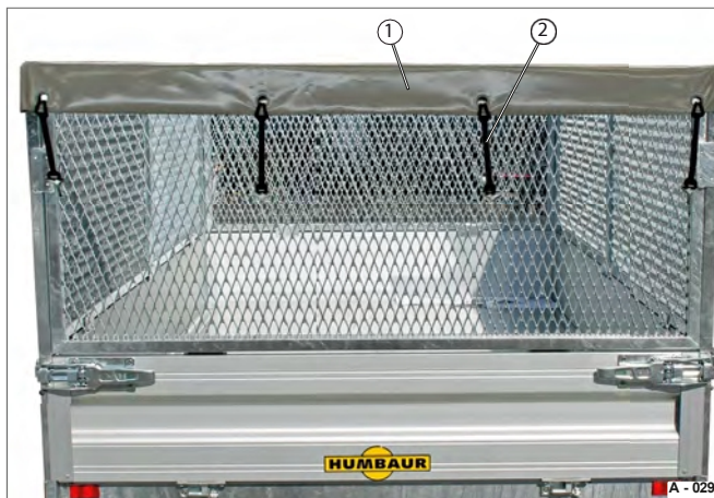
44 pav. 44 pavyzdys: plokščias tentas su plieniniu tinkleliu
