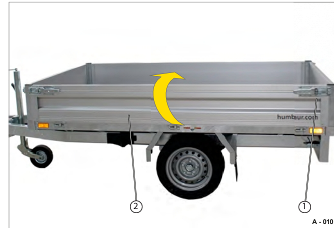
11 pav. 11 Šoninis lašo šonas uždarytas (važiavimo padėtis)
