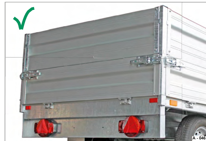
37 pav. 37 Galinio nuleidžiamojo šono / nuleidžiamojo šono prailginimo padėtis važiavimo metu
