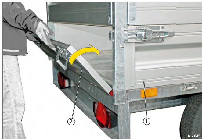
36 pav. 36 Pagrindo nuleidžiamosios dalies atlenkimas
