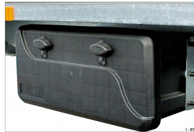
14 pav. Įrankių dėžė, esanti važiuoklės šone
