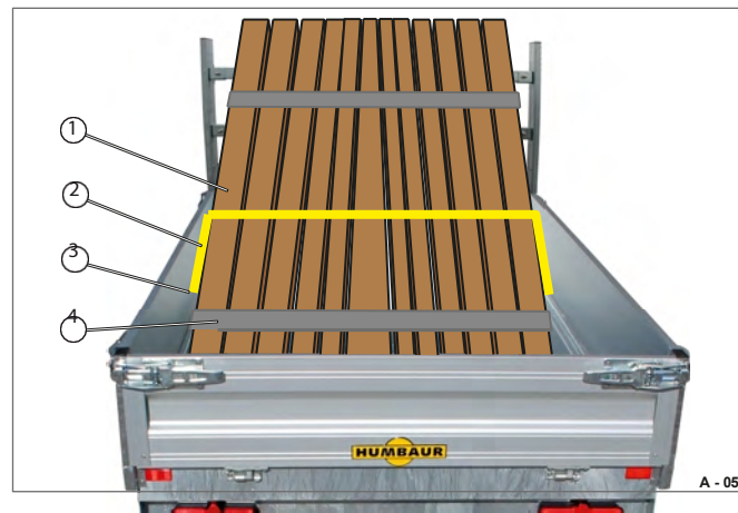
60 pav. 60 Krovinio tvirtinimas su H formos rėmu
