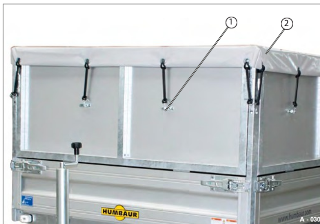
45 pav. 45 pavyzdys: plokščias tentas su aliuminio tvirtinimo įtaisu
