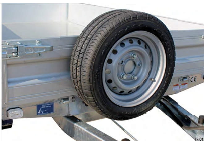
13 pav. 13 Atsarginis ratas / laikiklis priekinėje nuleidžiamoje pusėje
