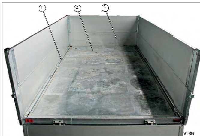
6. attēls Šasijas / kravas tilta tīrīšana
