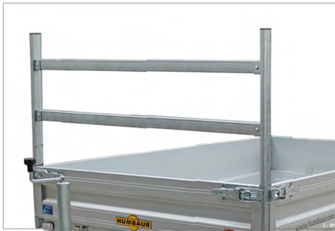
12. attēls Piestiprināts pie priekšējās krituma puses stūra statņos
