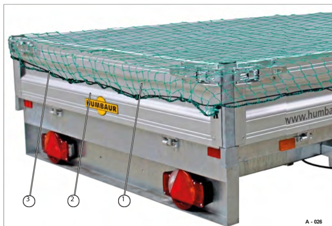
41. attēls Uzstādīts pārsega tīkls
