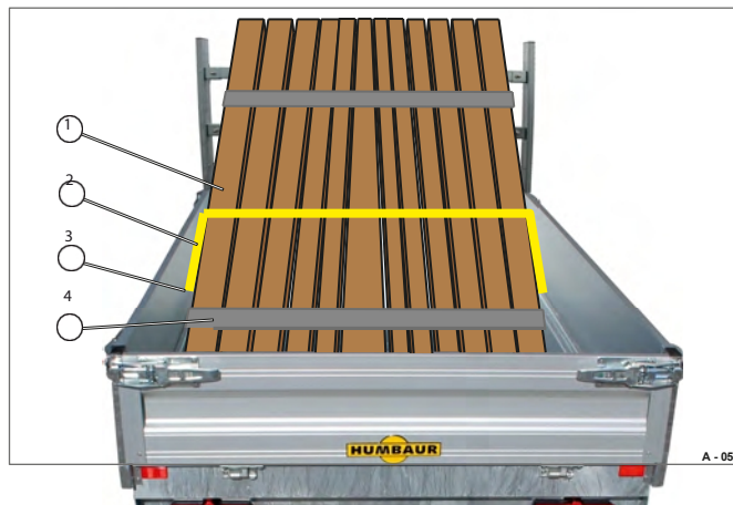
60. attēls Slodzes nostiprināšana ar H-veida rāmi
