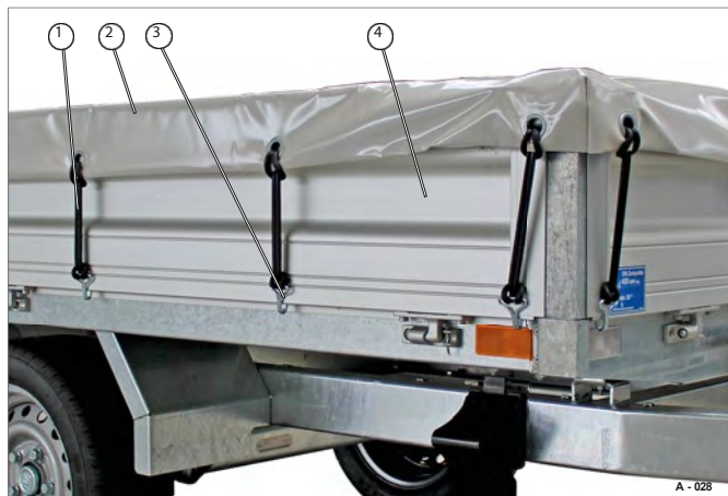
43. attēls Piemērs: Plakana brezenta pamatnes nolaišanas pusē
