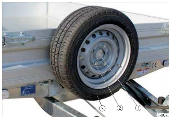
Sl. 7 Držač rezervnog kotača s rezervnim kotačem
