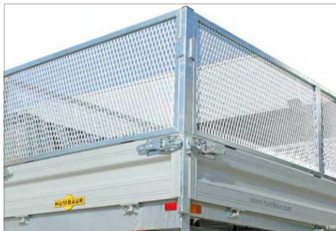
Sl. 7 Ovješeni na kutnim stupovima
