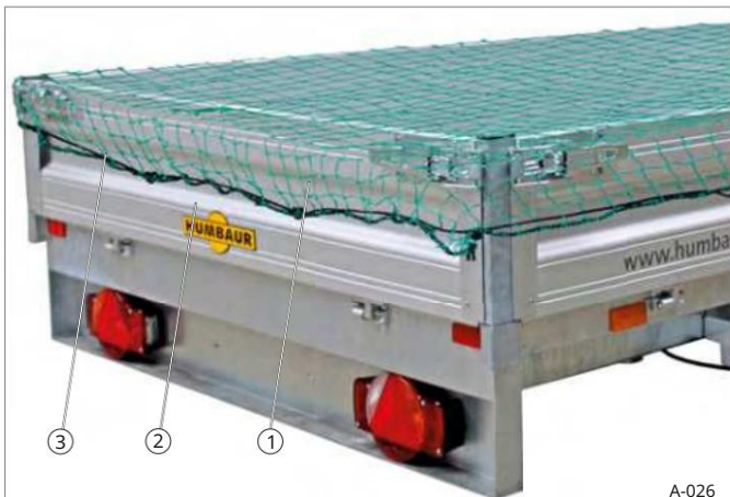
Sl. 41 Zaštitna mreža, montirana
