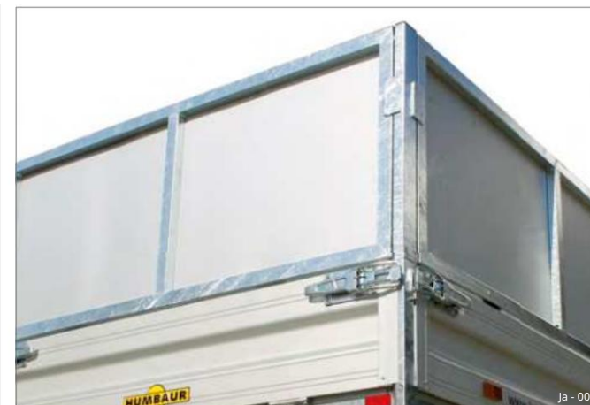
Sl. 8 Ovješeni na kutnim stupovima
