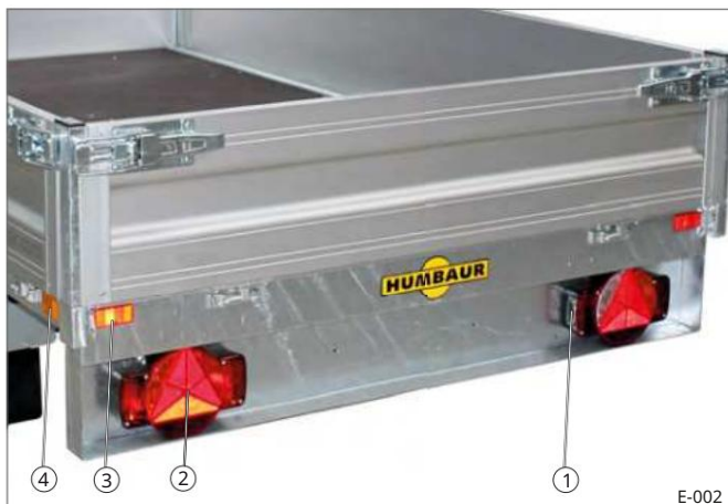
Sl. 2 Stražnja rasvjeta 1 svjetlo registarske pločice 2 višenamjenska svjetla 3 Stražnji reflektor / crveni reflektor 4 Bočni reflektor / žuti reflektor
