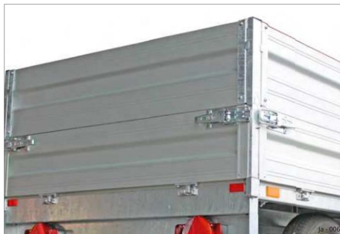
Sl. 6 Ovješeni na kutnim stupovima
