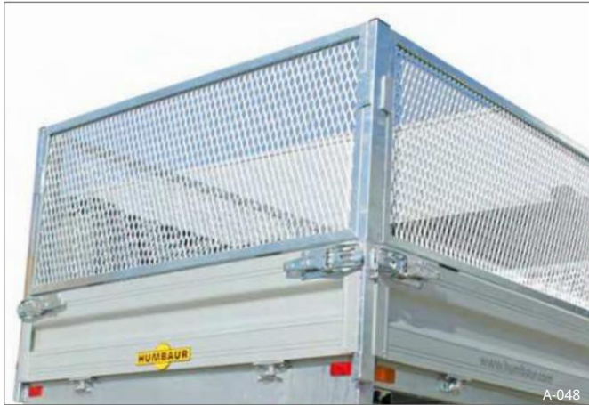
Sl. 38 Položaj vožnje za pričvršćivanje čelične rešetke
