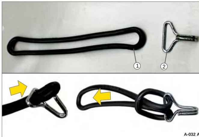
Mynd 47 Undirbúið spennistreng með krók
