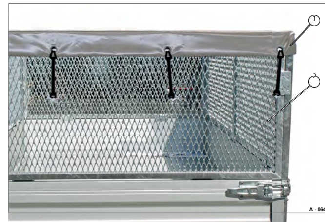
54. ábra Lapos ponyva (acélrácsos rögzítéssel)
