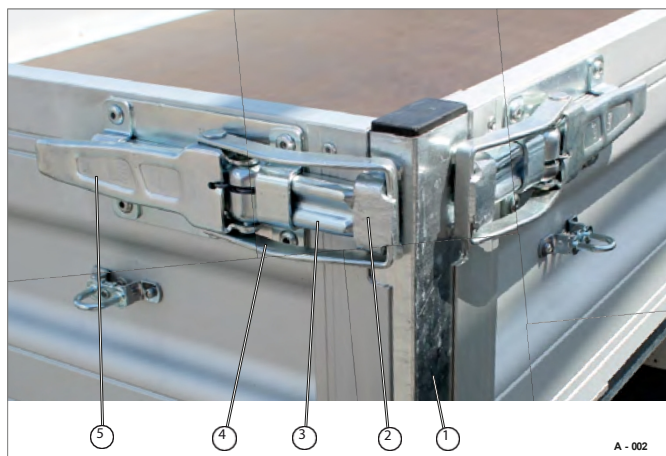
3. ábra Feszítőszár, rögzítve
