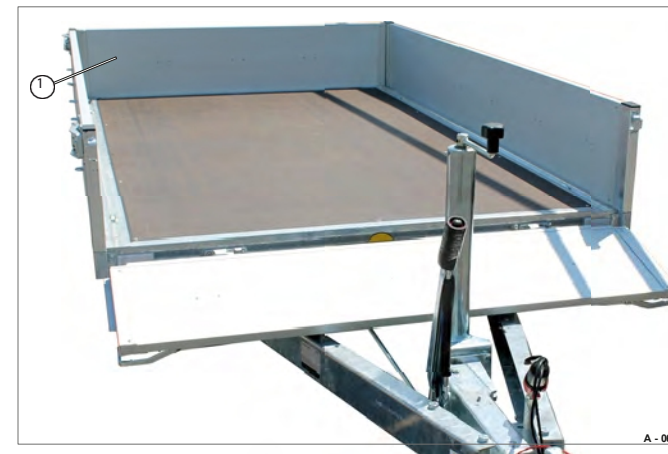
13. ábra Hátsó bukóoldal, zárva
