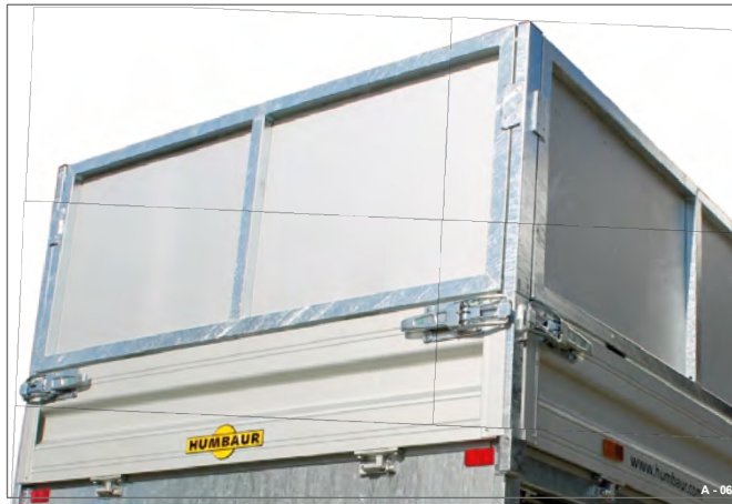
39. ábra Alumínium rögzítés, vezetőállás
