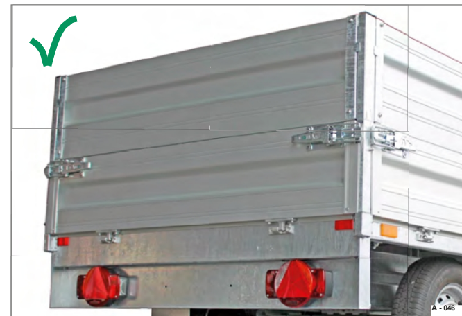
37. ábra Hátsó bukóoldal / bukóoldali hosszabbító menethelyzetben
