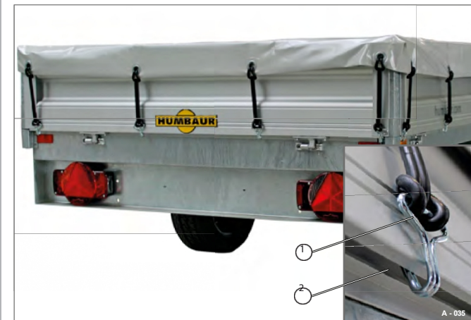
51. ábra Rögzített sík ponyva (a talapzat lefelé eső oldalával)
