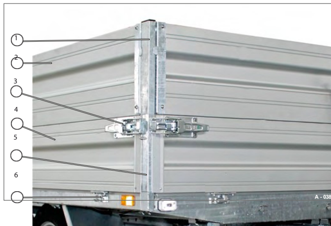
29. ábra Beépített oldalsó hosszabbító
