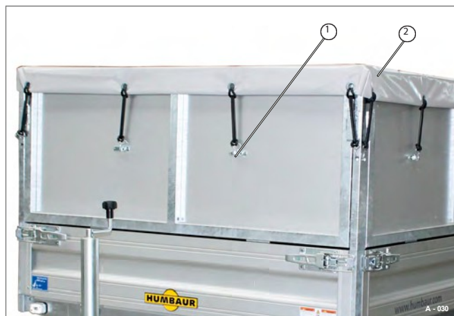
45. ábra Példa: Lapos ponyva alumínium rögzítéssel
