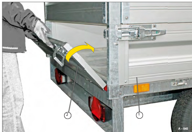
36. ábra A bázis lehajtható oldalának lehajtása
