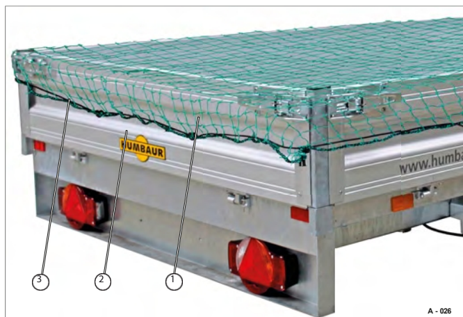
41. ábra Fedőháló, felszerelve
