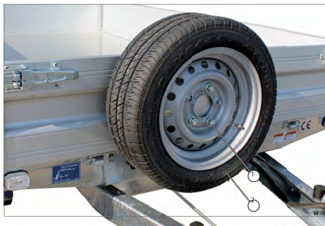
4. ábra A pótkeréktartó ellenőrzése
