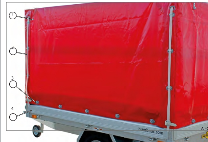
58. ábra Magas ponyva, rögzítve (utazási helyzetben)
