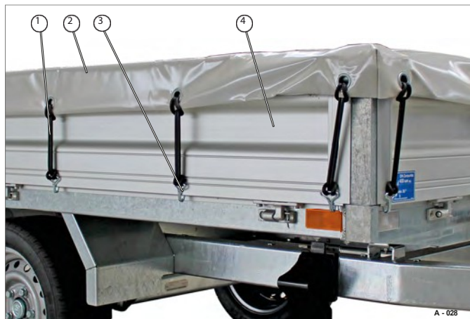
43. ábra Példa: Lapos ponyva a bázis bukóoldalához
