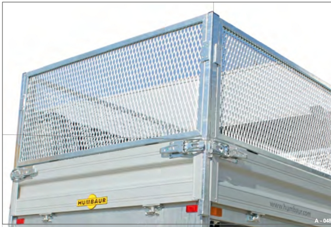
38. ábra Acélrács rögzítése Menetirányú helyzet
