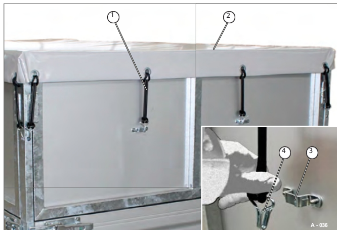
52. ábra Lapos ponyva (alumínium rögzítéssel)
