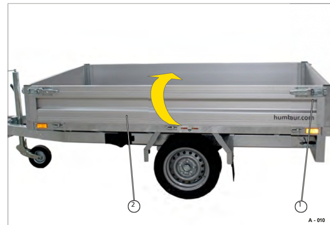
11. ábra Oldalsó leejtőoldal zárva (utazó helyzet)
