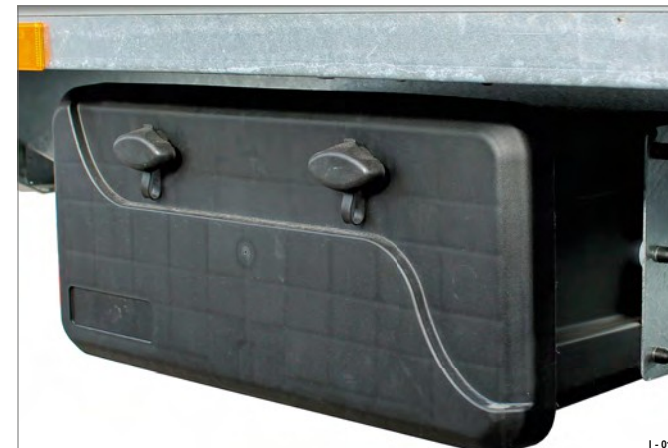
14. ábra Szerszámoszláda, az alváz oldalán
