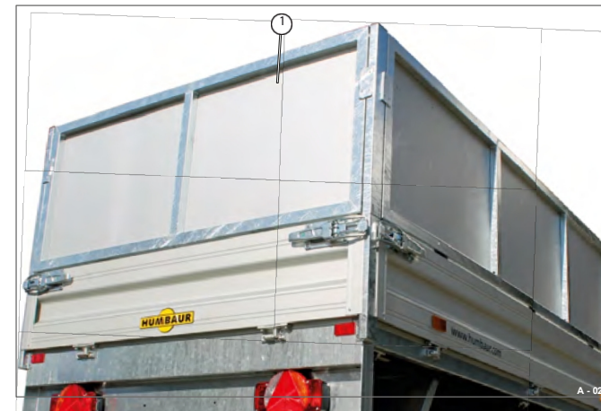
27. ábra Alumínium rögzítés, négyoldalas
