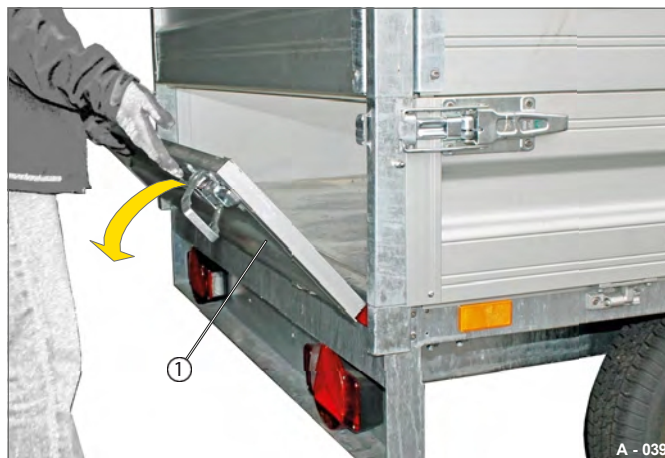
Kuva 30 Pohjan pudotuspuolen taittaminen alas.
