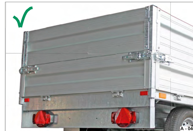
Kuva 37 Takaosan pudotuslaita / pudotuslaidan jatke ajoasennossa.
