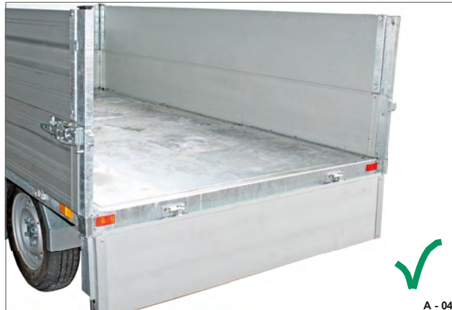
Kuva 33 Pudotuslaipan jatke irrotettuna
