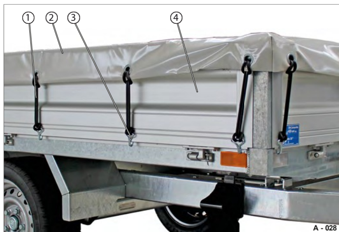
Fig. 43 Eksempel: Flad presenning til bunddækket
