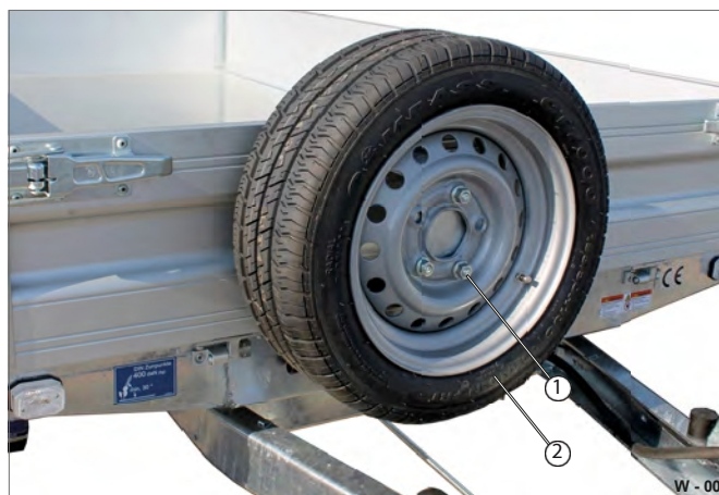
Fig. 4 Kontrol af reservehjulsholderen
