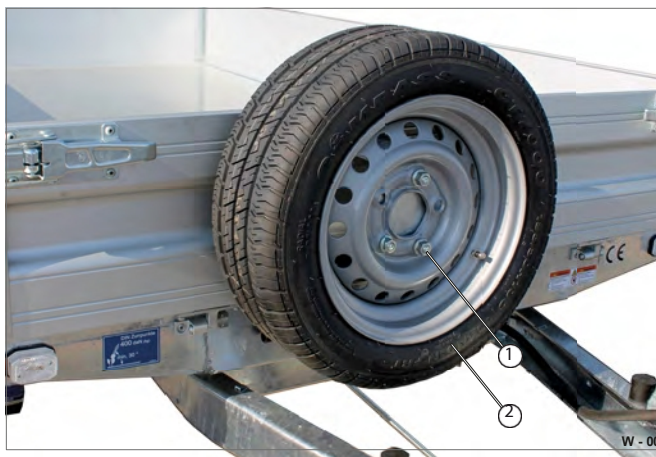
Obr. 4 Kontrola držáku rezervního kola
