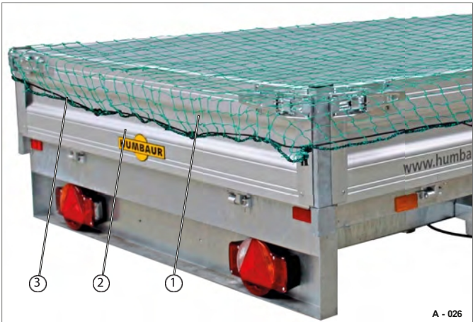
Obr. 41 Krycí síť, namontovaná
