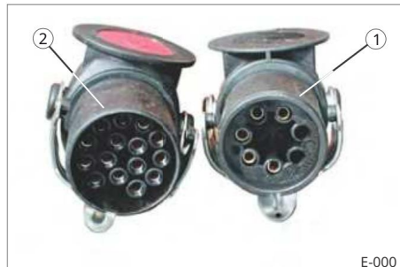
Slika 7 Vtični priključki, standardni 24 V 1 7-pinski EBS/ABS konektor (ISO 7638) 2 15-pinska električna konektorja (ISO 12098)
