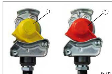
Slika 10 Odklopljena zavorna/dovodna cev
