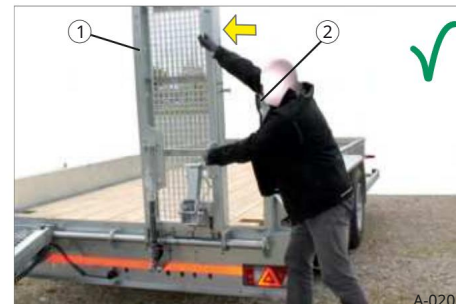
Slika 22 Premikanje dostopne rampe
