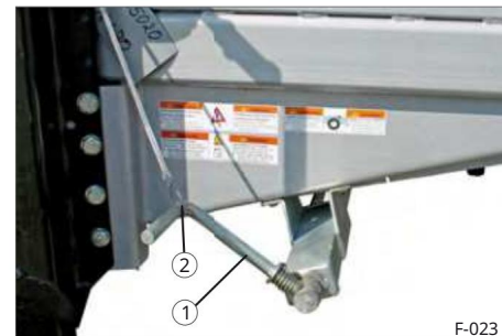
Slika 48 Zavarovana parkirna zavora vretena 1 ročica 2 varnostni vrvi s kavlji
