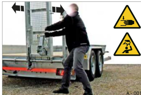
Slika 10 Upravljanje dostopnih ramp
