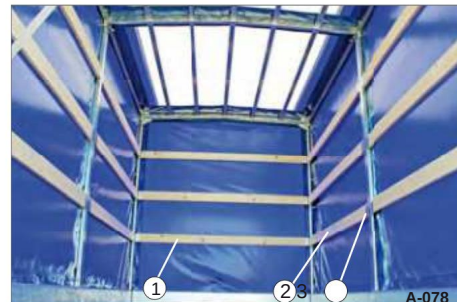
Bild 82 Insättning av lameller
