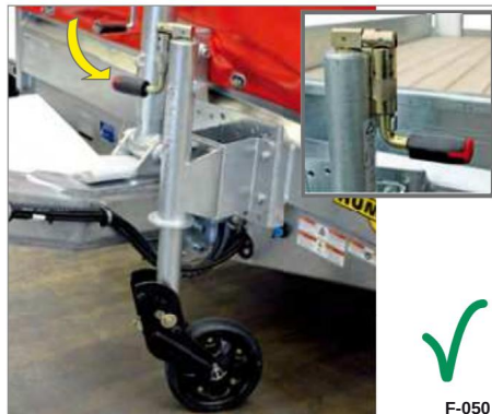
Bild 31 Vevaxeln är säkrad
