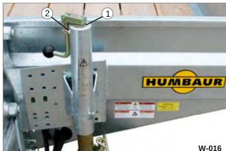
Bild 7 Rengöring/smörjning av stödhjulet
