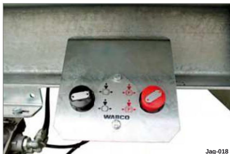
Bild 18 Luftparkeringsbroms med fjäderbelastad cylinder
