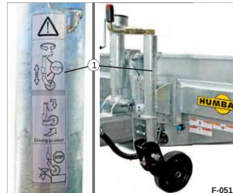
Bild 32 Vevaxeln är säkrad
