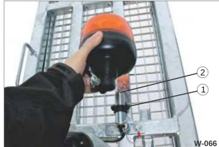
Bild 66 Demontering av roterande varningsljus
