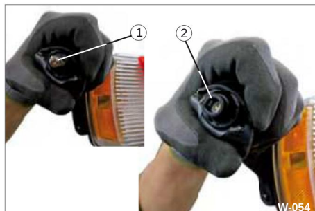
Bild 54 Byte av lampa
