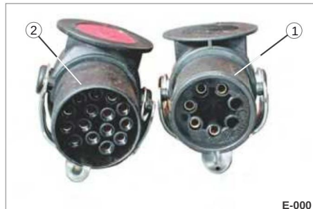
Bild 7 Kontaktanslutningar, standard 24 V 1 7-polig EBS/ABS-kontakt (ISO 7638) 2 15-poliga elektriska kontakter (ISO 12098)
