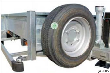
Rys. 5 Uchwyt koł a zapasowego na grodzi
