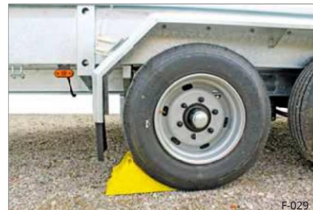
Rys. 55 Przykład: Podkładanie klinów pod koła
