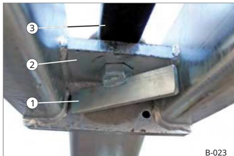
Rys. 22 Oczko pociągowe D40 zamocowane zawiasowo u góry
