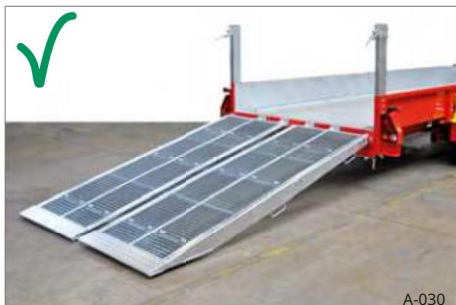
Rys. 32 Opuszczone rampy załadunkowe
