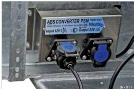
Abb. 17 Przetwornica ABS 24 V / 12 V
