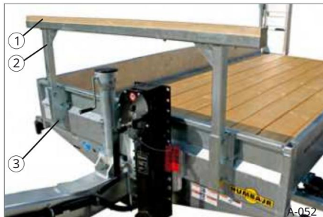
Rys. 56 Wspornik na ścianie bocznej przedniej
