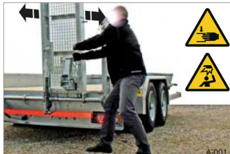
Rys. 10 Obsługa ramp dostępowych
