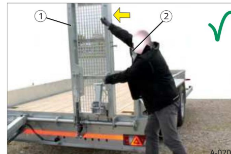
Rys. 22 Przesuwanie rampy dostępowej
