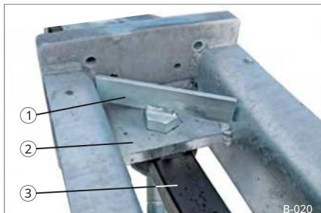
Rys. 19 Oczko pociągowe D50 zamocowane zawiasowo u dołu
