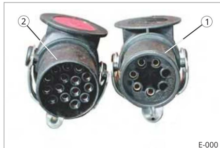
Rys. 7 Podłączenia wtykowe, standardowe 24 V 1 złącze EBS/ABS 7-pinowe (ISO 7638) 2 złącza elektryczne 15-stykowe (ISO 12098)
