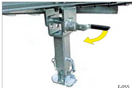
Rys. 39 Podpora skł adana rozłożona
