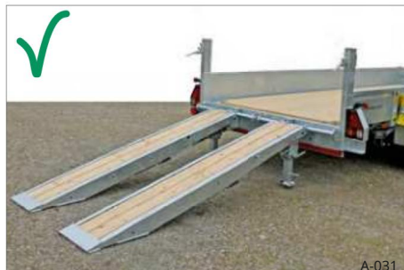
Rys. 33 Opuszczone rampy załadunkowe
