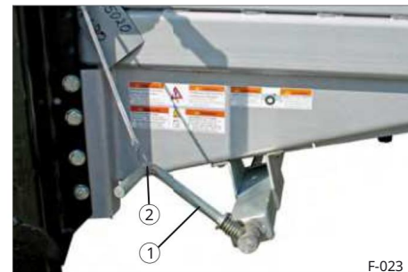
Rys. 48 Zaciągnięty hamulec postojowy wrzeciona 1 korba 2 liny zabezpieczające z hakami
