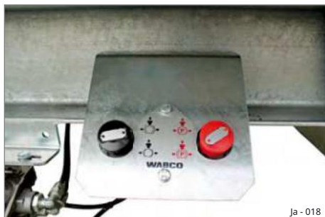
Rys. 18 Hamulec postojowy pneumatyczny z cylindrem sprężynowym
