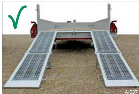
Rys. 39 Opuszczone rampy załadunkowe
