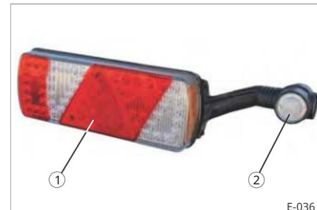
Rys. 25 Lampa wielofunkcyjna „LED” 24 V
