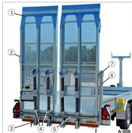
Afbeelding 16 HS met brede stalen oprijplaten, met veerhefmechanisme
