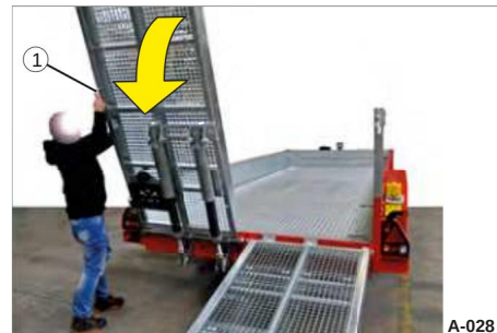
Afbeelding 30 Het verlagen van de toegangsramp
