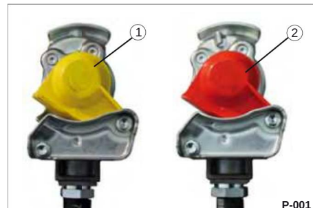
Figuur 10 Rem-/toevoerleiding losgekoppeld
