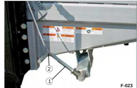
Afbeelding 48 Spilparkeerrem vastgezet 1 krukas 2 veiligheidslijnen met haken
