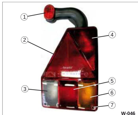
Afbeelding 46 Componenten van het achterlicht
