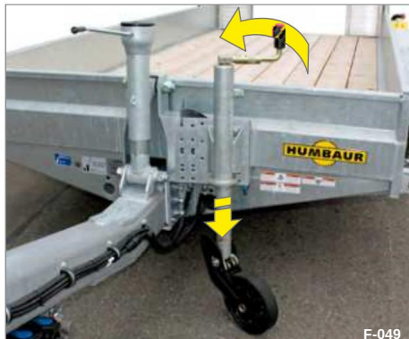
Afbeelding 30 Draai het steunwiel naar beneden
