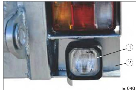
Afbeelding 32 Werklamp op de onderrijbeveiliging
