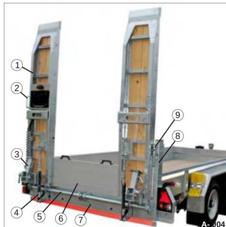
Afbeelding 13 HS met stalen oprijplaten, met gasveerondersteuning
