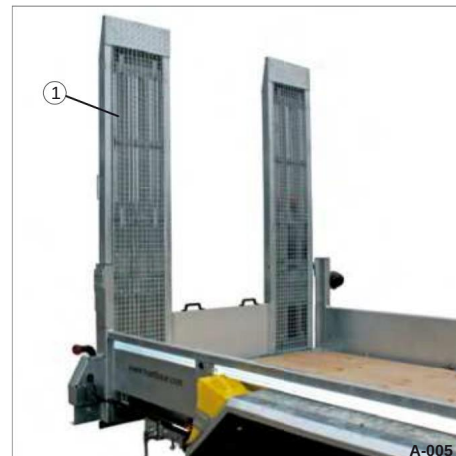
Afbeelding 14 HS met stalen oprijplaten, met gasveerondersteuning
