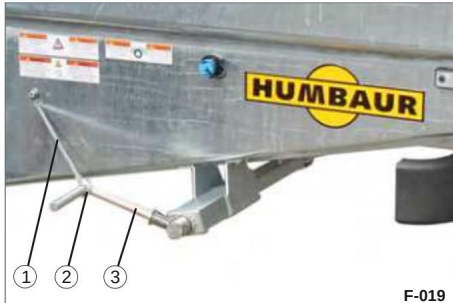
Afbeelding 44 Spilparkeerrem vastgezet in rijpositie
