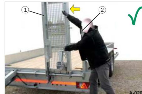
Afbeelding 22 Verplaatsen van de toegangsramp
