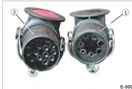
Afbeelding 7 Stekkerverbindingen, standaard 24 V 1 7-pins EBS/ABS-connector (ISO 7638) 2 15-pins elektrische connectoren (ISO 12098)
