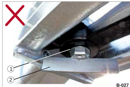
Afbeelding 26 Verkeerd bevestigd - onderstaande afbeelding
