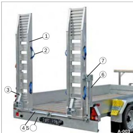
Afbeelding 12 HS met aluminium oprijplaten
