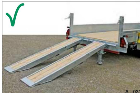
Fig. 33 Rampe di carico abbassate
