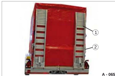
Fig. 65 Lato posteriore con rampe di carico
