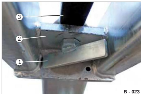
Fig. 22 Occhiello di trazione D40 incernierato in alto
