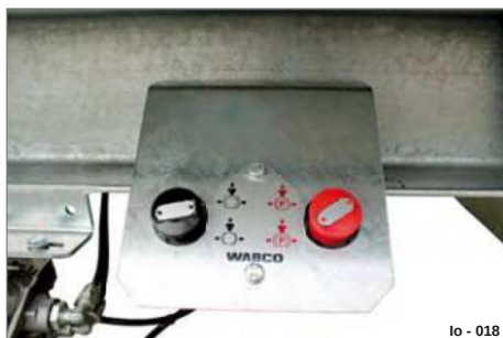
Fig. 18 Freno di stazionamento pneumatico con cilindro a molla
