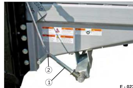
Fig. 48 Freno di stazionamento del mandrino fissato 1 manovella 2 corde di sicurezza con ganci
