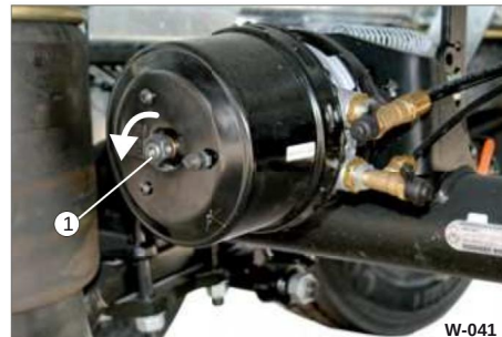
Fig. 41 Rilascio del freno di stazionamento
