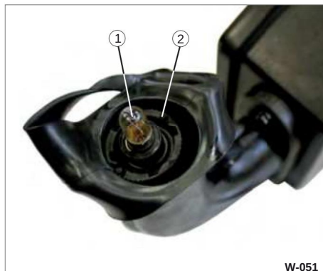
Fig. 49 Sostituzione della lampada
