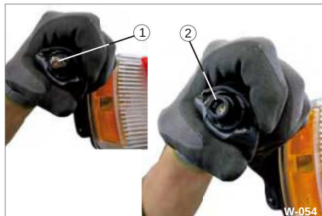
Fig. 54 Sostituzione della lampada
