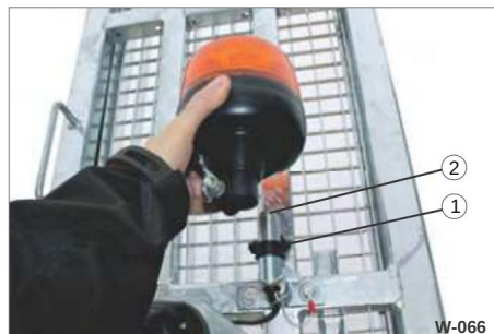
Fig. 66 Rimozione del faro rotante
