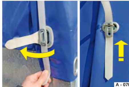
Fig. 74 Sbloccaggio della parte anteriore del telone
