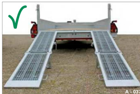
Fig. 39 Rampe di carico abbassate
