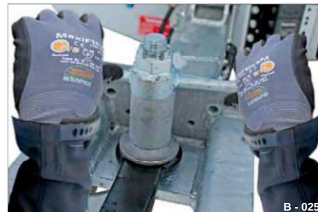
Fig. 24 Occhielli di tensione D40 fissati
