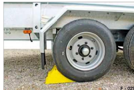
Fig. 55 Esempio: Cunei posizionati sotto
