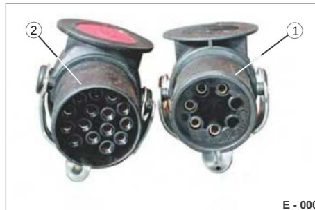
Fig. 7 Collegamenti a spina, standard 24 V 1 connettore EBS/ABS a 7 pin (ISO 7638) 2 connettori elettrici a 15 pin (ISO 12098)
