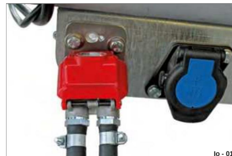
Fig. 16 per aria compressa: alimentazione / freno
