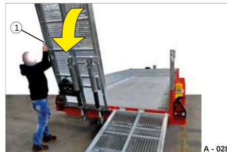
Fig. 30 Abbassamento della rampa di accesso
