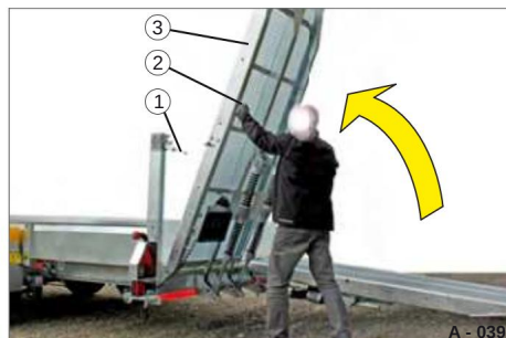
Fig. 41 Sollevamento della rampa di accesso in un unico pezzo
