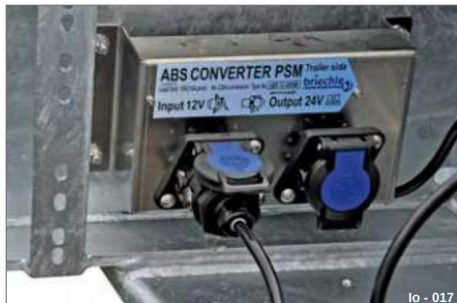
Abb. 17 Convertitore ABS 24 V / 12 V
