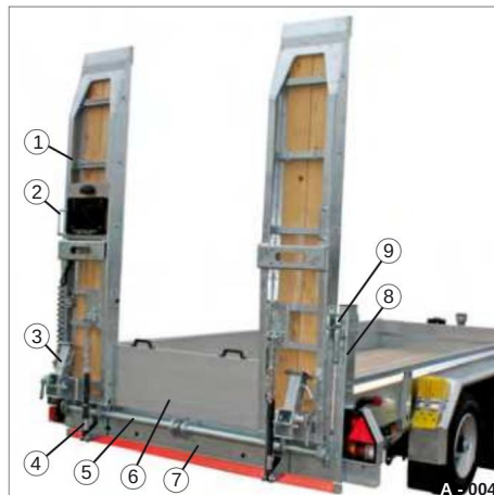
Fig. 13 HS con rampe in acciaio, con supporto a molla a gas
