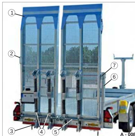
Fig. 16 HS con rampe larghe in acciaio, con meccanismo di sollevamento a molla
