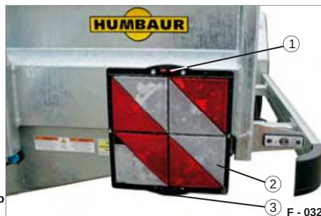
Fig. 67 Cartello di divieto di sosta, aperto
