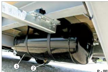
Fig. 51 Serbatoio dell'aria compressa sotto il telaio 1 serbatoio di aria compressa, lato anteriore 2 Valvola di scarico
