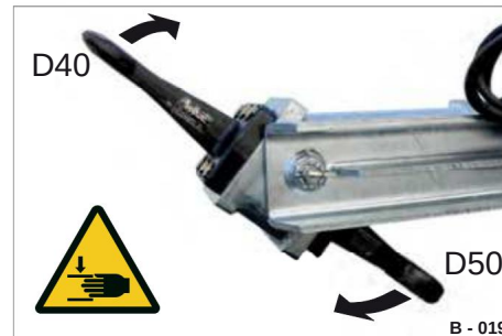
Fig. 18 Rotazione delle pulegge
