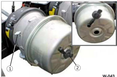
Fig. 43 Cilindro a membrana caricato a molla 1 vite di rilascio 2 tappi (foro)
