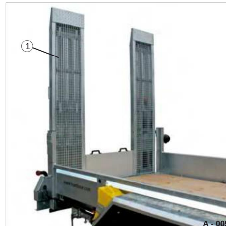
Fig. 14 HS con rampe in acciaio, con supporto a molla a gas
