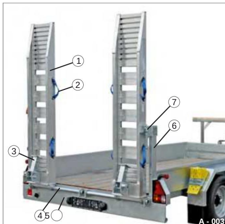
Fig. 12 HS con rampe in alluminio
