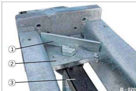
Fig. 19 Occhiello di trazione D50 incernierato in basso
